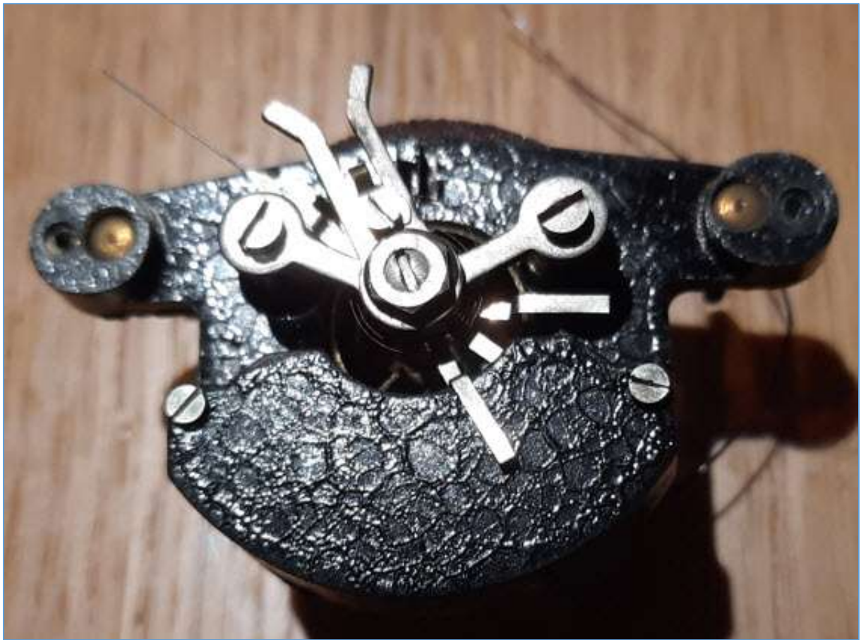
Fig. 7 : Vue de détail du galvanomètre du type ferromagnétique à répulsion , vue de face où l'on devine la présence des palettes de répulsion. Photo : ON4HNO.
