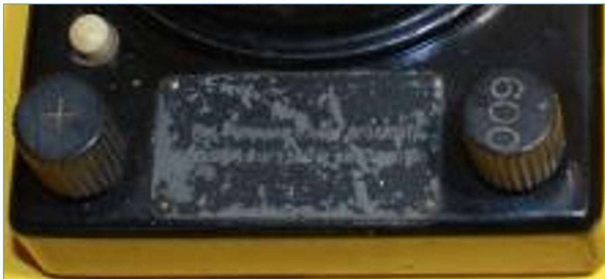
Fig. 43 : Présence d'un bouton de contact blanc (en haut à gauche de la photo) prévu à l'origine dès la conception du voltmètre « Wevometer » Paul Gossen en 1928. Source : Radiomuseum.org, Stiftung Radiomuseum Luzern, Haltenriedstrasse 20, CH-6045 Meggen, Suisse, dirigé par Ernst Erb et Katrin Seiler Erb, Agrandissement partiel de la prise de vue d'un « Wevometer » Paul Gossen, 1928. Court extrait pour illustrer le propos de la présence d'un bouton blanc sur cet appareil de mesure.
