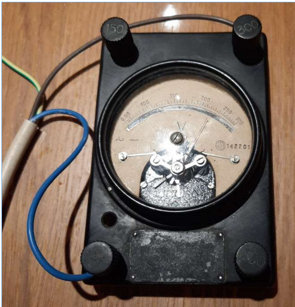
Fig. 49 : Test du voltmètre en courant alternatif sur le secteur 230 V 50 Hz en ayant raccordé le calibre de 300 V. Photo : ON4HNO.
