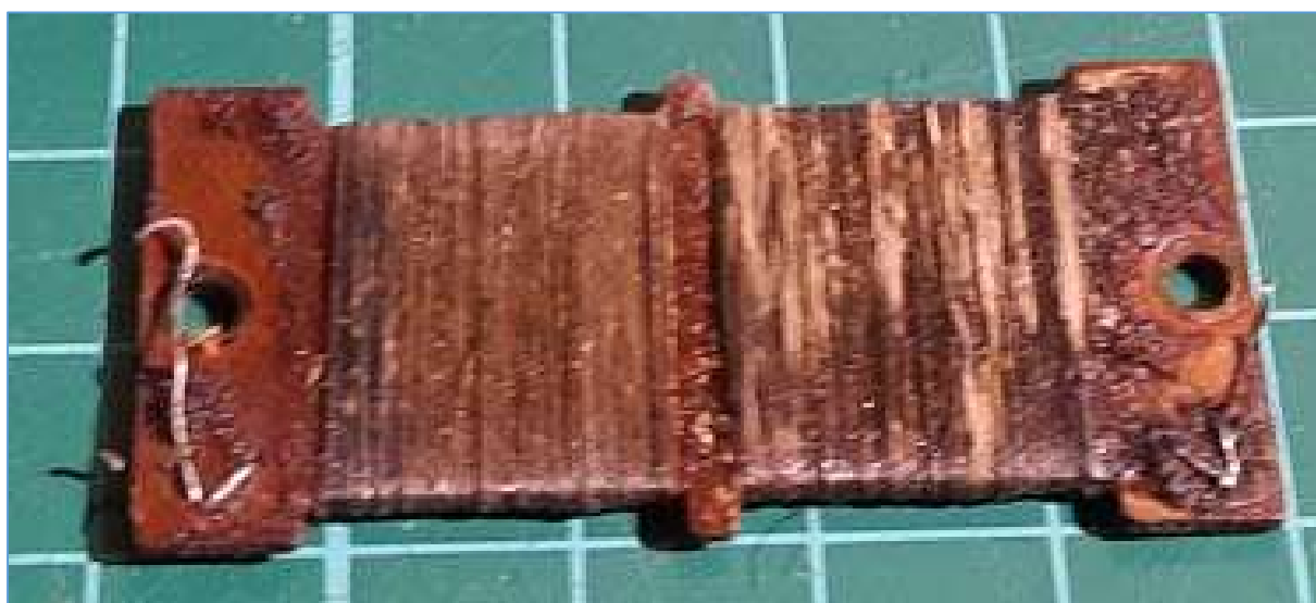
Fig. 39 : Résistance bobinée de précision de 10 k \Omega constituée de fil ultra fin sur une plaque en bakélite. Photo : ON4HNO.
