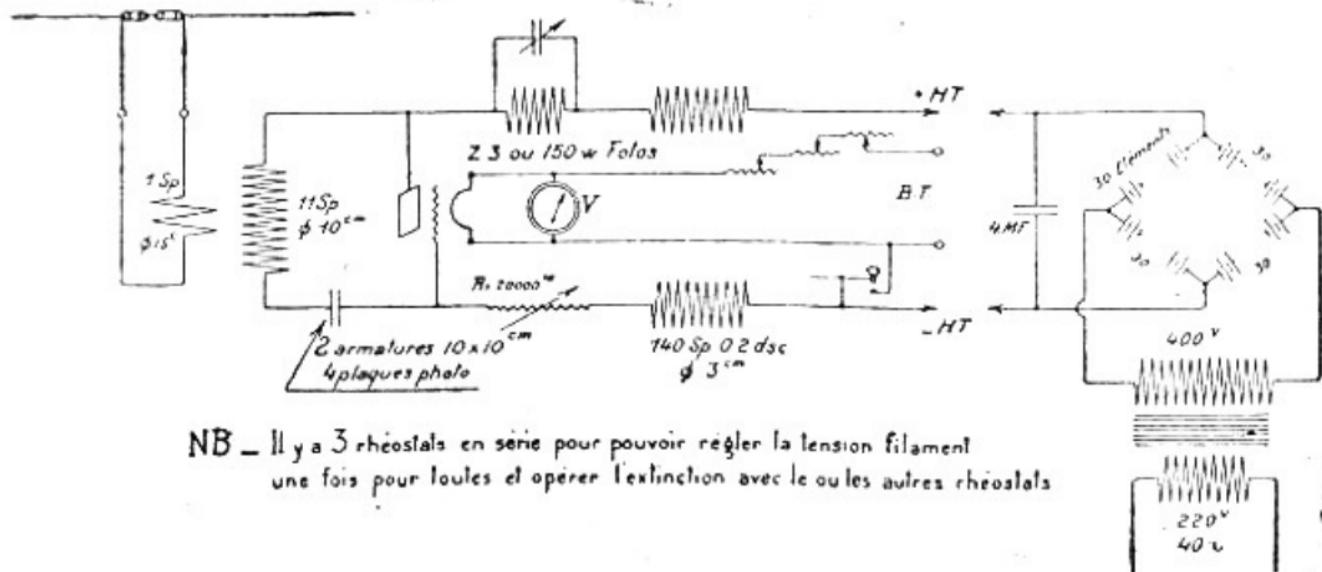
NB - Il y a 3 rhéostats en série pour pouvoir régler la tension filament une fois pour toutes et opérer l'extinction avec le ou les autres rhéostats
