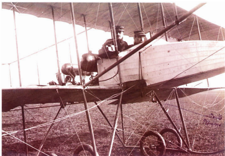
Villacoublay 1911, l'adjutant Ménard et Paul Brenot sur le Farman prêt à décoller, on distingue l'émetteur et sous la cellule la cisaille de coupure d'antenne, Collection 8 e RT.
