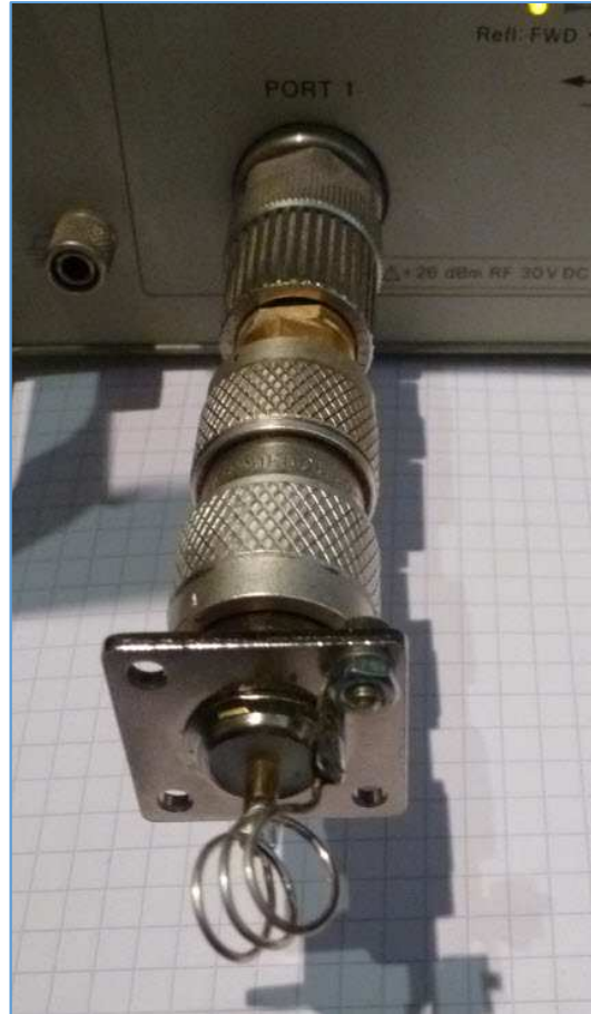
Fig. 58 : Bobine de self-induction raccordée sur le set-up de mesure. Photo : ON4IJ.
