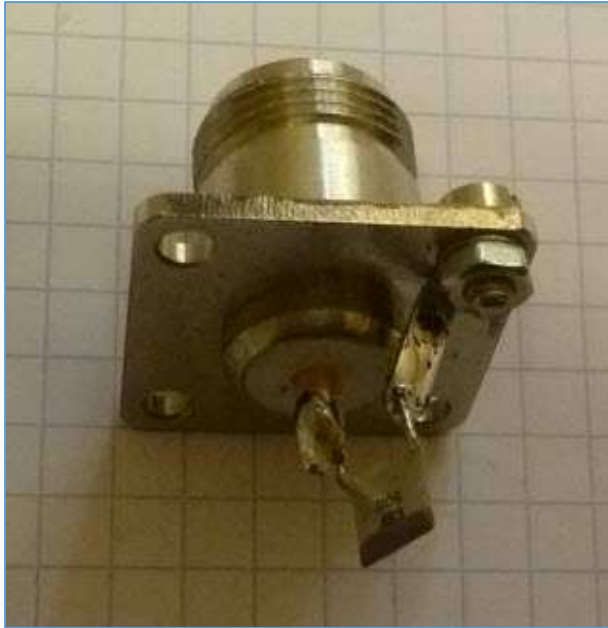
Fig. 66 : Condensateur céramique Phillips N750 d'une capacité nominale de 68 pF raccordé sur le set-up de test. Photo : ON4IJ.
