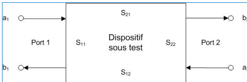
Fig. 10 : Modèle d'un réseau à deux ports avec les variables a_1 et a_2 d'ondes incidentes ainsi que les variables d'ondes réfléchies b_1 et b_2 . Graphisme ON4IJ.
