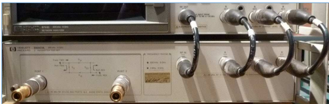
Fig. 6 : Illustration des quatre raccordements entre le S-Parameter Test Set et l'analyseur de réseau vectoriel. En bas à gauche du cliché, on peut observer les connecteurs des deux ports de mesure. Photo : ON4IJ.
