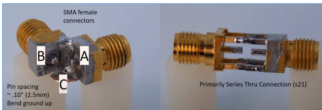
Fig. 54 : Set-up de mesure avec connecteurs SMA pour le raccordement d'un composant à mesurer selon les trois méthodes avec un VNA. Source : #95 Three Methods to Measure Impedance with the NanoVNA , W0QE (Larry Benko), 2 Mars 2020.
