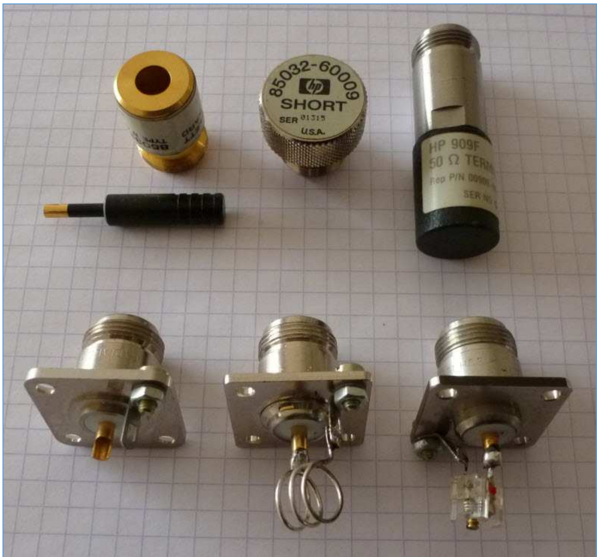
Fig. 55 : Calibres Open, Short, Load type N femelles (HP 85032B) et set-up de mesure Type N femelle. En bas, de gauche à droite : calibre « set-up Open » pour le réglage du plan de référence de mesure, une bobine de self-induction et un condensateur variable miniature. Photo : ON4IJ.
