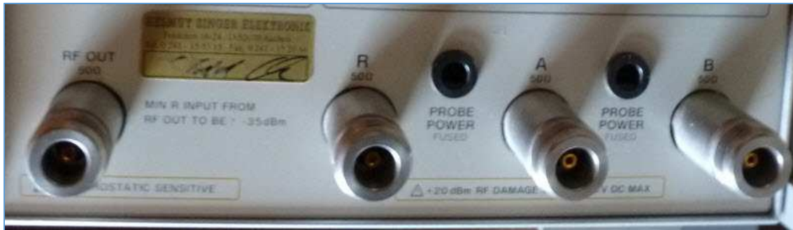
Fig. 5 : Illustration des quatre connecteurs de raccordement sur la face avant d'un analyseur de réseau vectoriel. Photo : ON4IJ.
