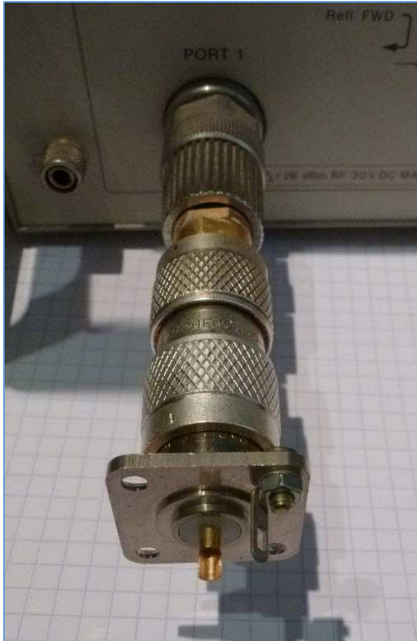
Fig. 57 : Calibre « set-up Open » utilisé pour le réglage du plan de référence au port 1 de mesure. Photo : ON4IJ.
