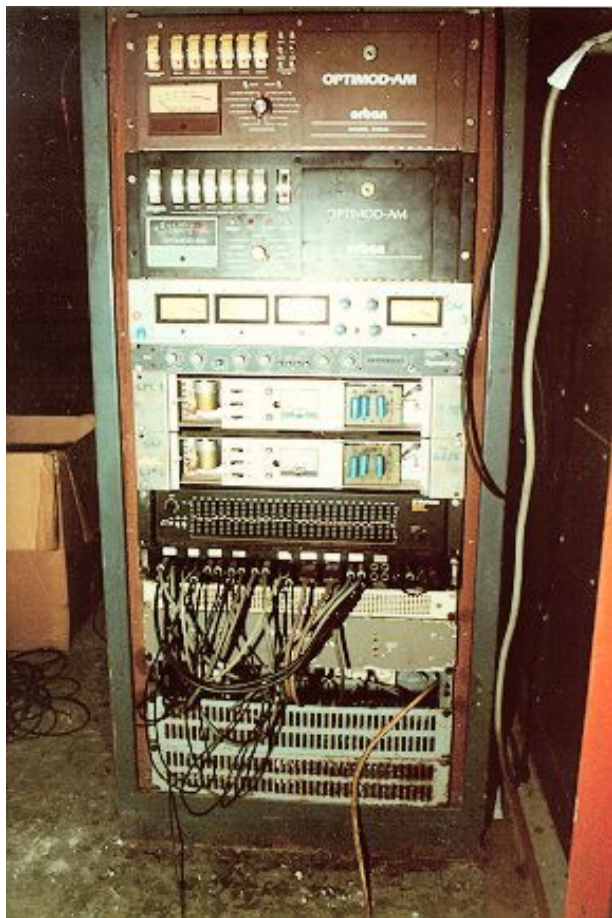
Le rack de processing Optimod 9000/A1 de Radio Caroline
