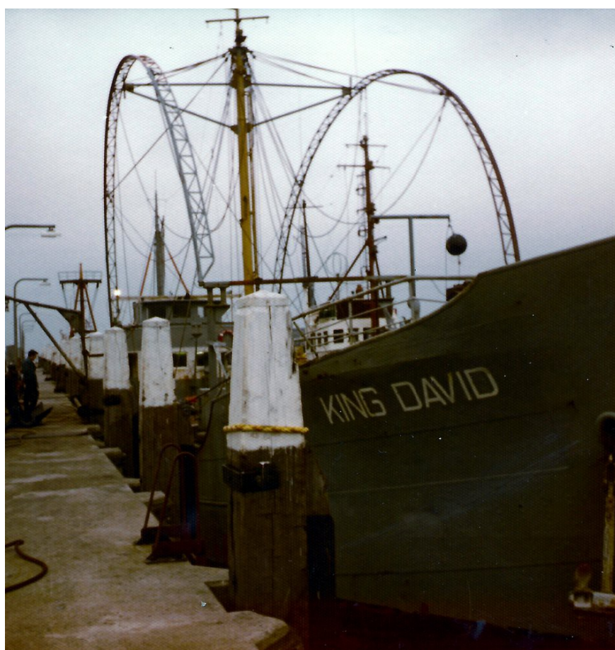
L'antenne boucle de Capital Radio était pliable pour la navigation dans les chenaux ou l'accostage au port.
