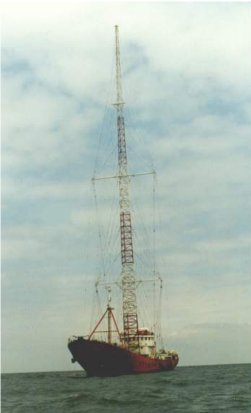
Le pylône antenne de 90 mètres de Radio Caroline
