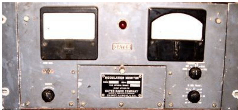
Moniteur de modulation Gates M-5693 des années 1960. Comme ceux utilisés par les trois navires Caroline.
