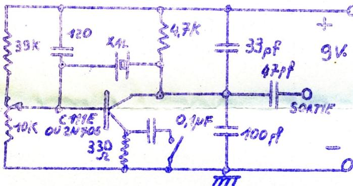
Cet oscillateur était initialement prévu pour les cristaux FT 241. Les bons FT 243 se mettent également en oscillation sur ce montage. Moyennant un découplage de R. émetteur les FT 243 oscillent plus généreusement. L'interrupteur sur ce découplage s'avère donc utile.
