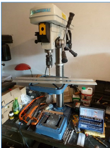
Fig. 67 : Outillage d'usinage des barreaux en aluminium pour la fixation des six cavités du duplexeur du répéteur ON0LG. Photo : ON4IJ.
