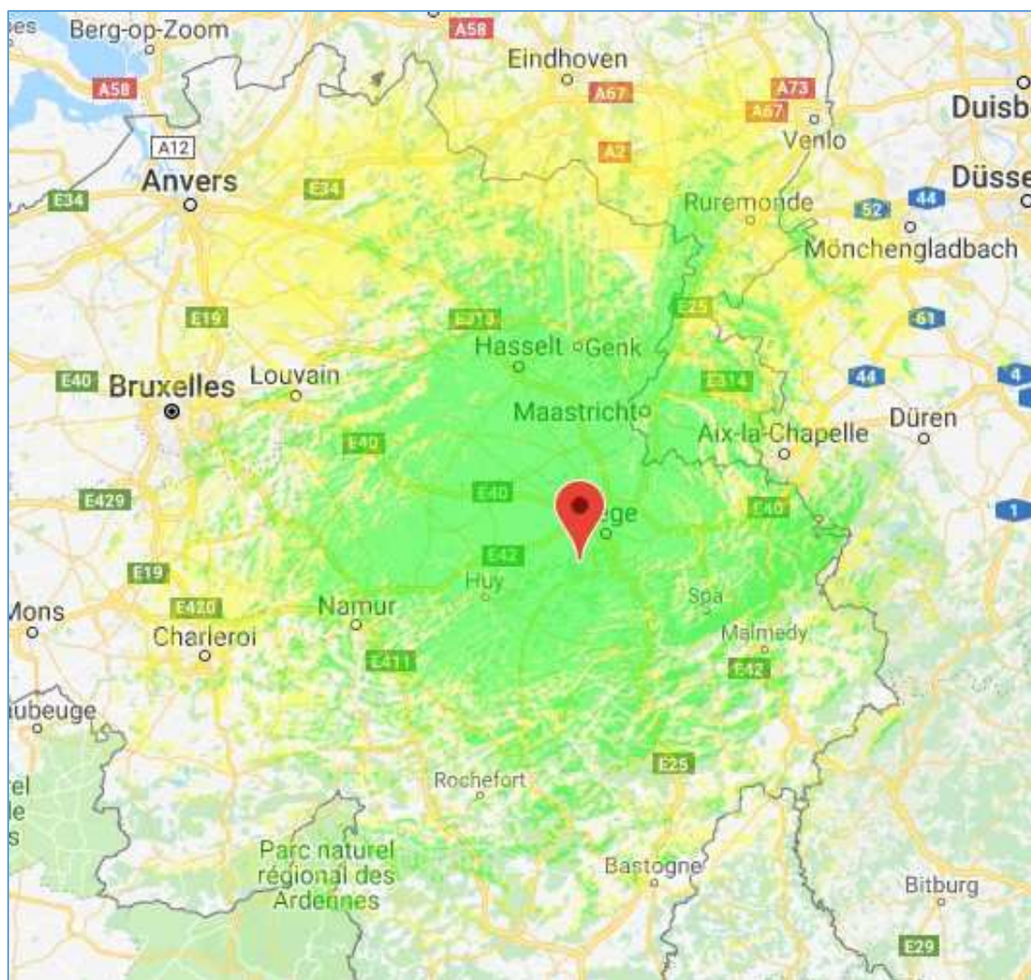
Fig. 1 : Carte de couverture du relais ON0LG VHF 2 m, 145,650 MHz, canal RV52, CTCSS 74,4 Hz. La zone colorisée en vert clair représente une couverture d'au moins de 90 % et la zone colorisée en jaune représente une couverture comprise entre 50 % et 70 %. Source : ON6DP ; carte établie selon le logiciel Radio Mobile dont la propriété intellectuelle appartient à Roger Coudé VE2DBE.
