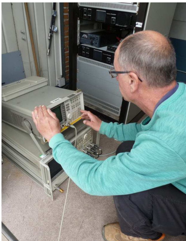
Fig. 154 : Relevé de la pureté spectrale d'émission du répéteur par Jean-François ON4IJ. Photo : Julian.
