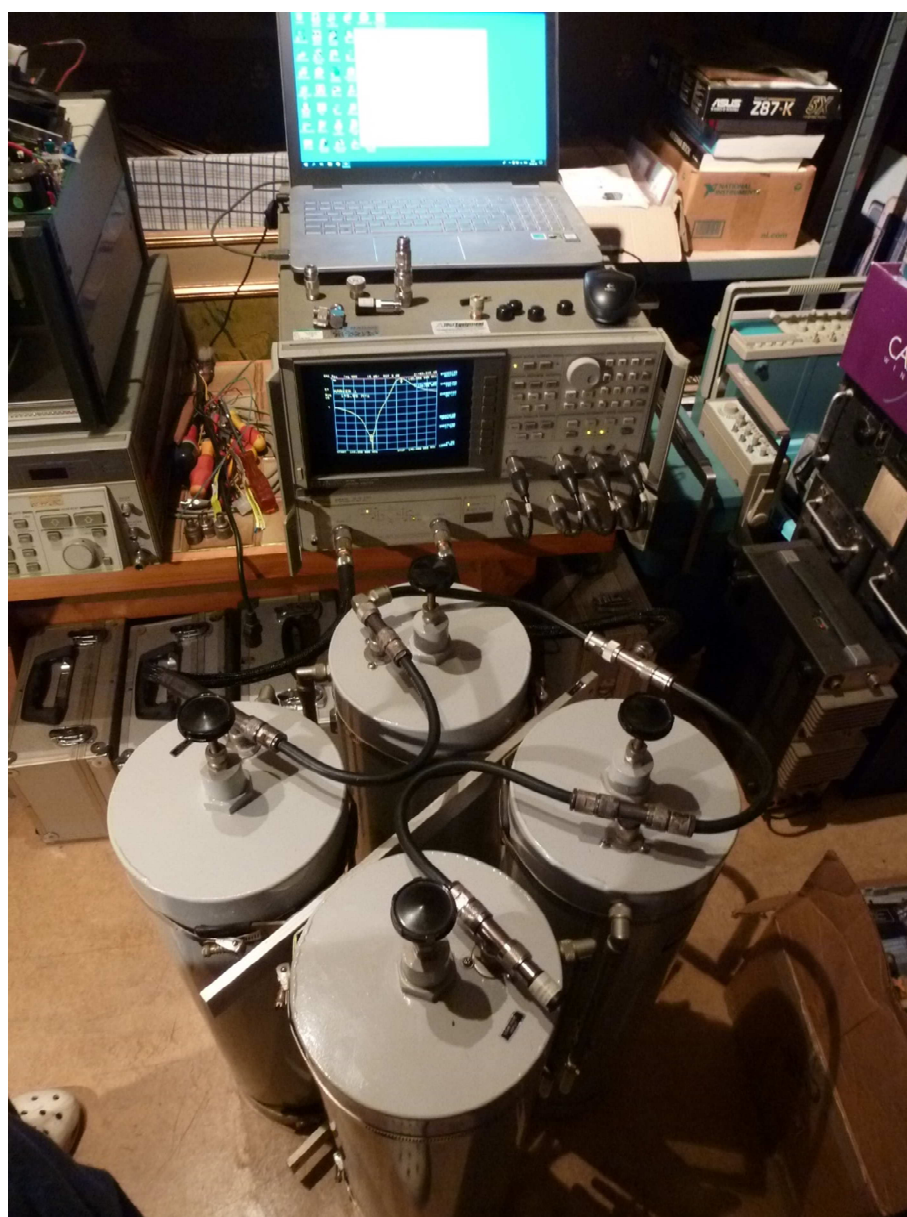
Fig. 20 : Duplexeur VHF Wacom WP-641 sous test sur un analyseur de réseau vectoriel HP 8753C avec S-Test Set HP 85047A pour les relevés des coefficients de transmission ( S_{21} , S_{12} ) et des coefficients de réflexion ( S_{11} , S_{22} ). Photo : ON4IJ.
