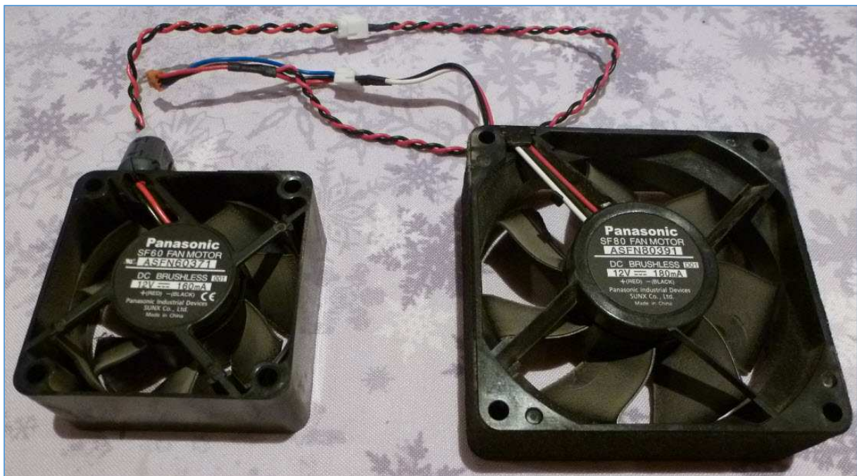
Fig. 116 : Ventilateurs d'origine d'un rack Yaesu DR-1X. Photo : ON4IJ.
