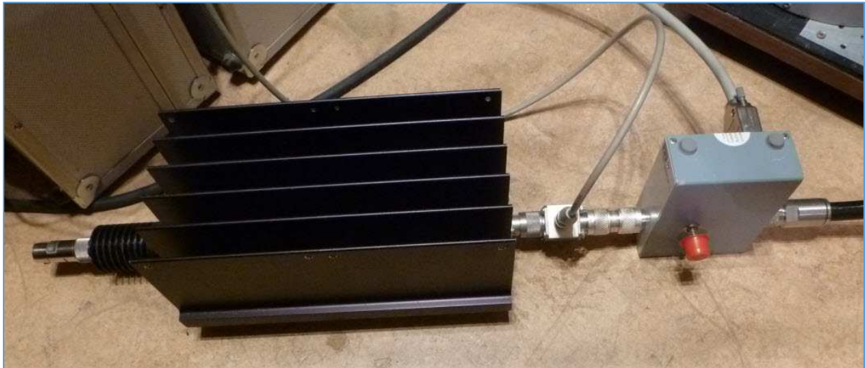
Fig. 139 : De droite à gauche, coupleur directionnel d'un ROS-mètre (Rohde & Schwarz NAS-Z5), « Iso-T » (Cellwave), atténuateur de puissance (Bird 500-WA-FFN-30), atténuateur (Narda 766-20) et charge étalon (HP 908A). Photo : ON4IJ.
