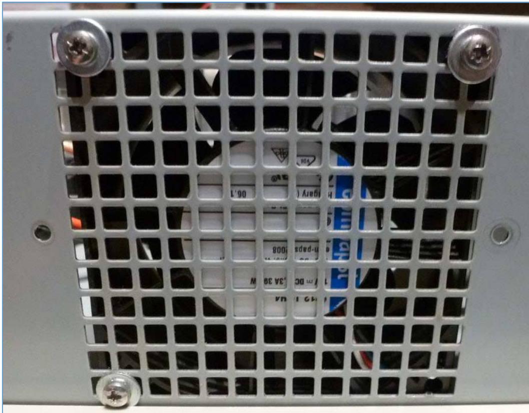
Fig. 120 : Fixation du nouveau ventilateur sur la face arrière du DR-1X à travers les trous de la grille de ventilation. Quatre segments verticaux des mailles du réseau de trous carrés sont sectionnés au moyen d'une petite pince coupante. Ceci permet d'obtenir un passage des quatre vis de fixation juste en face des trous de fixation du ventilateur. En bas à droite, on peut observer un segment coupé hors de la grille de ventilation ; ce segment se situe juste en face d'un trou de fixation du ventilateur. Photo : ON4IJ.
