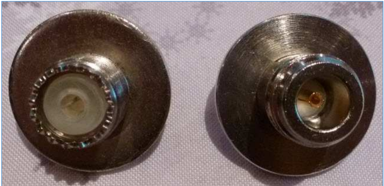
Fig. 56 : Idem figure précédente avec vue de face ; à gauche, la rondelle et le connecteur UHF d'origine ; à droite, une nouvelle rondelle usinée avec un connecteur type N. Photo : ON4IJ.
