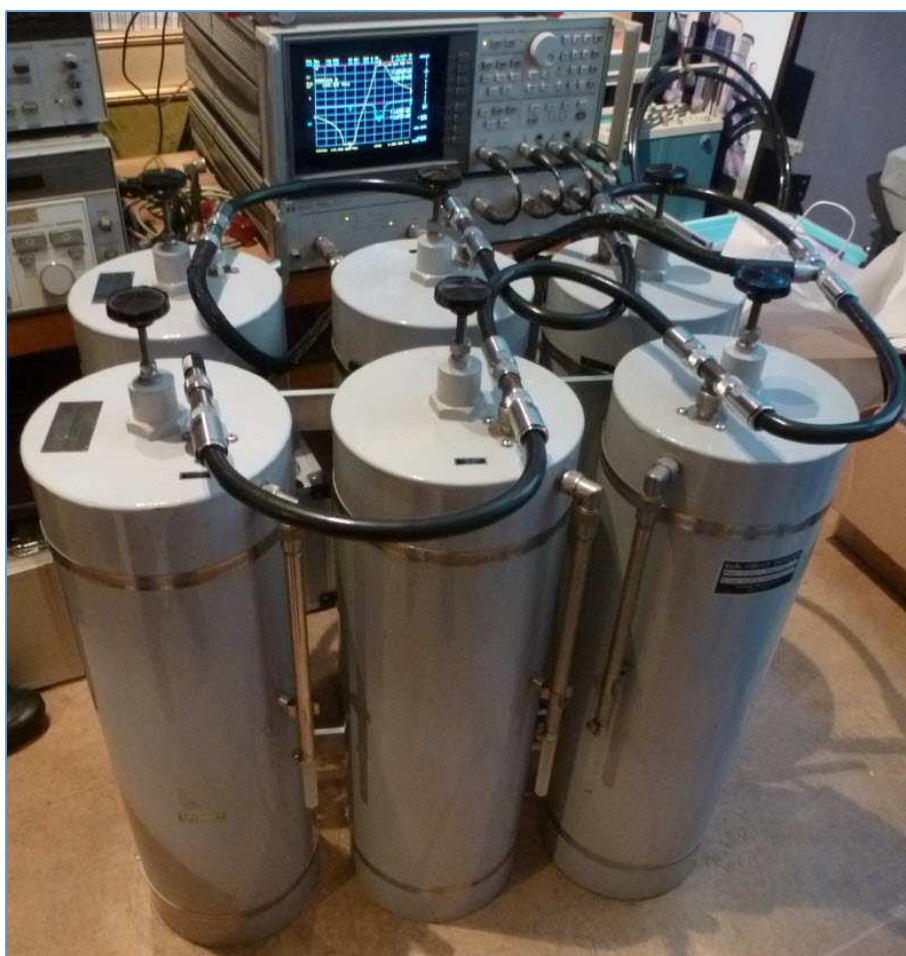
Fig. 71 : Duplexeur Wacom WP-641 reconstitué avec deux cavités supplémentaires pour le répéteur ON0LG, duplexeur ici sous test sur un analyseur de réseau vectoriel HP 8753C. Photo : ON4IJ.
