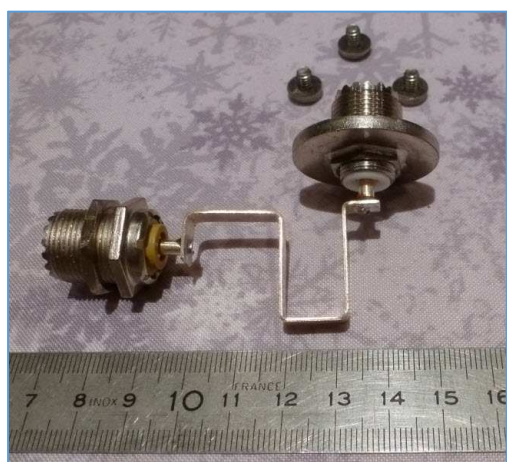
Fig. 19 : Boucle de couplage d'une cavité d'un duplexeur Wacom WP-641. Le connecteur UHF à gauche du cliché permet de raccorder le Stub de la cavité. Photo : ON4IJ.
