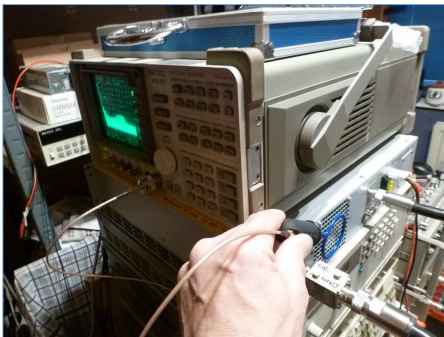
Fig. 126 : Mesures du champ électromagnétique rayonné par le moteur du ventilateur arrière à travers les mailles de la grille de ventilation du DR-1X. Mesures avec une boucle de couplage. Photo : ON4IJ.
