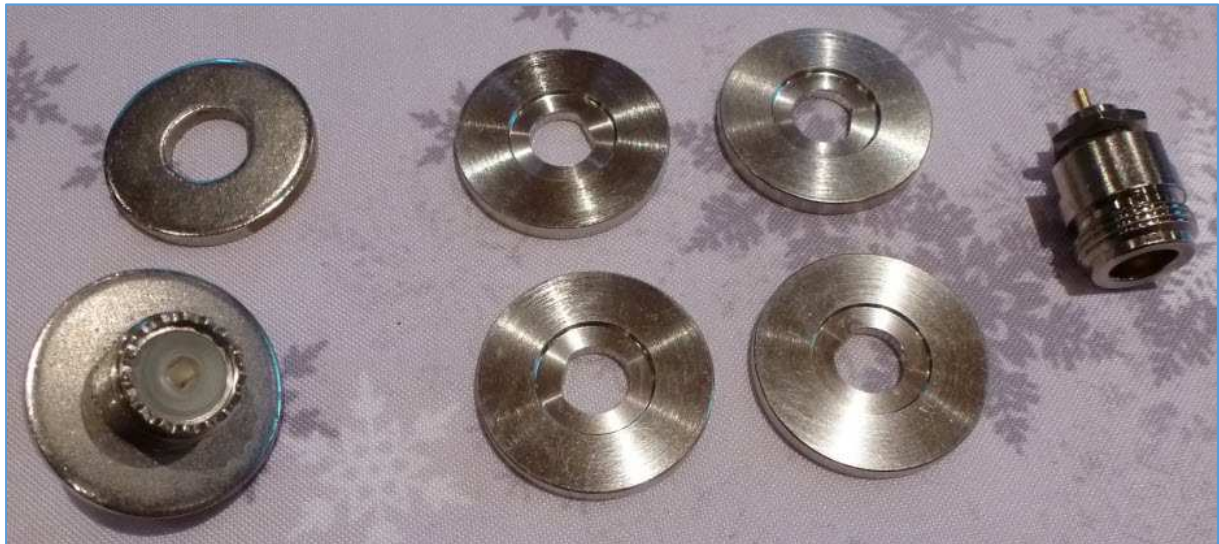
Fig. 53 : Usinage de rondelles épaisses en laiton nickelé pour l'interface mécanique entre les connecteurs type N et les cavités d'un duplexeur Wacom WP-641. Au-dessus à gauche, une rondelle d'origine avec en dessous à gauche un connecteur UHF d'origine des cavités des USA ; à droite quatre rondelles usinées pour accueillir des connecteurs type N. Tout à droite, un connecteur type N prévu pour la transformation des cavités. Remarque : un lamage a été usiné sur les rondelles pour accueillir les connecteurs type N ; il s'agit ici d'un raffinement d'usinage pour assoir parfaitement l'embase de fixation des connecteurs circulaires type N et aussi pour obtenir une profondeur correcte de positionnement du connecteur vis-à-vis de la connexion de la pin centrale du connecteur à la boucle de couplage de la cavité. Photo : ON4IJ.
