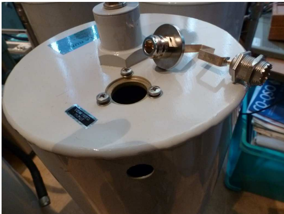
Fig. 52 : Idem figure précédente où l'on peut observer le lamage usiné dans la partie supérieure de la cavité pour accueillir la rondelle d'interface mécanique pour un connecteur type N. Au-dessus à droite, on peut observer l'ensemble de la boucle de couplage de la cavité équipée à l'entrée d'un connecteur type N avec sa rondelle d'interface mécanique et du connecteur UHF pour la connexion du Stub . Le trou d'accueil du connecteur UHF pour la connexion du Stub est visible sur le milieu en dessous du cliché (sur la face latérale de la cavité). Photo : ON4IJ.
