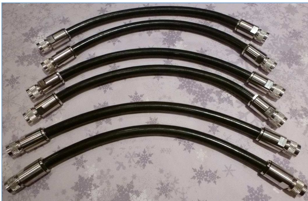
Fig. 65 : Câbles coaxiaux constituant le harnais de câblage du duplexeur à six cavités du répéteur ON0LG. Tous les câbles sont de la même longueur ; sur ce cliché, les câbles à l'avant plan semblent être plus longs à cause de l'angle de vue. Photo : ON4IJ.
