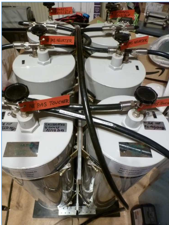
Fig. 144 : Étiquettes de signalisation placées sur les réglages sensibles des cavités du duplexeur. Le duplexeur est fixé au socle en bois par des équerres boulonnées sur le barreau en aluminium de fixation des cavités. Photo : ON4IJ.
