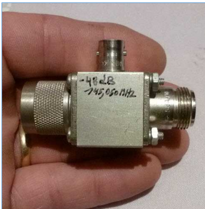
Fig. 137 : « Iso-T » à couplage fixe Cellwave. Le degré de couplage a été mesuré au moyen d'un analyseur à la fréquence de 145,050 MHz en tenant compte de l'atténuation du câble coaxial BNC-BNC HP 8120-1840 de raccordement entre la sortie de la branche auxiliaire du « Iso-T » et l'entrée de l'appareil de mesure. Photo : ON4IJ.
