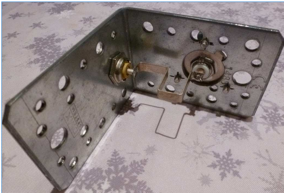
Fig. 58 : Idem figure précédente avec vue sur la boucle de couplage et ses connecteurs d'origine positionnés sur le gabarit. Photo : ON4IJ.
