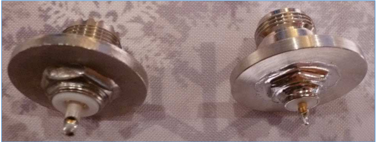
Fig. 55 : Idem figure précédente avec vue de profil où l'on peut reconnaître un connecteur UHF d'origine à gauche et un connecteur type N à droite. Photo : ON4IJ.
