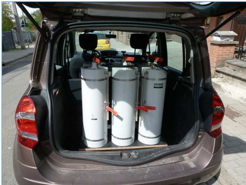
Fig. 146 : Transport délicat du duplexeur Wacom WP-641 transformé avec 6 cavités pour le répéteur ON0LG VHF. Photo : ON4IJ.
