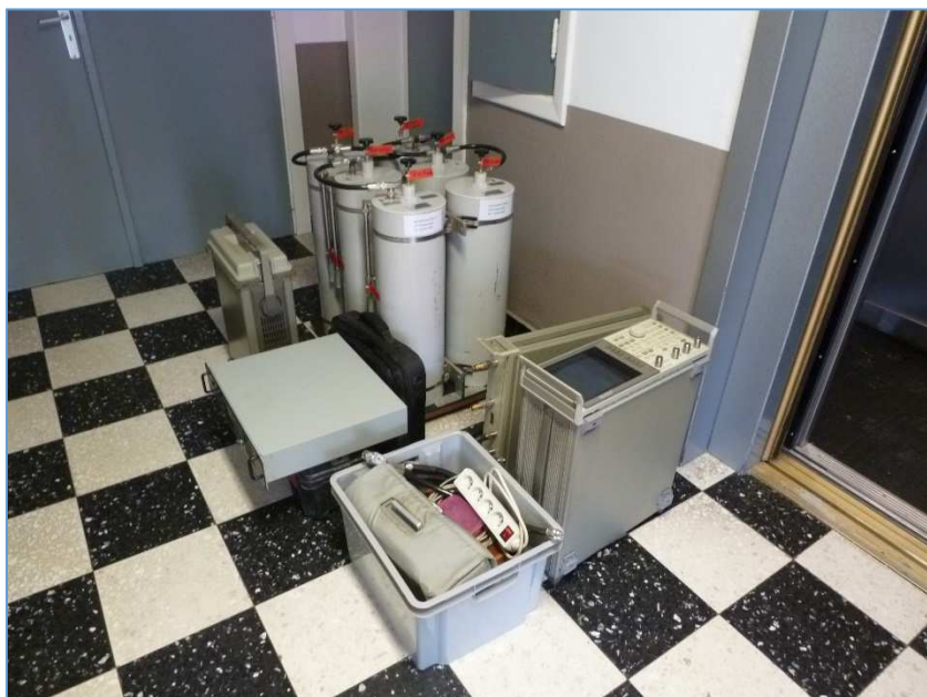
Fig. 147 : Duplexeur, rack répéteur, appareils de mesure et outillage pour la remise en service de ON0LG VHF préparés dans le hall d'entrée du building à Seraing où est situé ce relais de Liège. Photo : ON4IJ.
