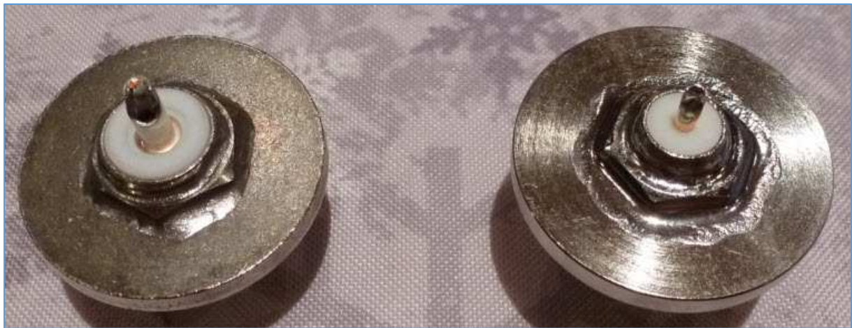
Fig. 54 : Fixation des connecteurs coaxiaux des cavités sur une interface mécanique sous la forme de rondelles épaisses en laiton nickelé. La sécurité d'assemblage est effectuée par une brasure tendre à l'alliage eutectique étain-plomb. La soudabilité de ce type de brasure sur un revêtement de nickel par galvanoplastie sur un substrat de laiton est excellente. À gauche : fixation par brasure d'un connecteur UHF d'origine, à droite, celle d'un connecteur type N. Remarque : une brasure est effectuée non seulement entre l'écrou et la rondelle mais aussi entre l'écrou et le corps fileté du connecteur. Photo : ON4IJ.
