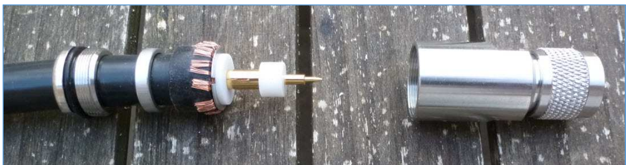
Fig. 63 : Préparation de l'extrémité d'un câble coaxial Ecoflex 15 Plus pour accueillir un connecteur type N spécialisé. Voir la description de la procédure dans le texte ci-dessus. Photo : ON4IJ.
