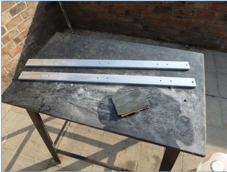
Fig. 68 : Les barreaux en aluminium ont été ponçés avec un émeri et à l'eau afin d'obtenir un bel aspect brossé sur leurs surfaces. Photo : ON4IJ.
