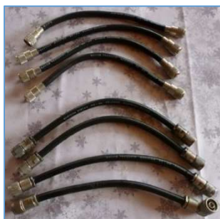
Fig. 61 : Anciens harnais des câbles coaxiaux. Au-dessus les câbles avec connecteurs UHF ; en dessous les anciens câbles type N avec RG-214/U. Tout en dessous, un câble RG-214/U avec type N coudé de récupération ayant servi à tester notre duplexeur à quatre cavités reçu de ON4LUC. Photo : ON4IJ.
