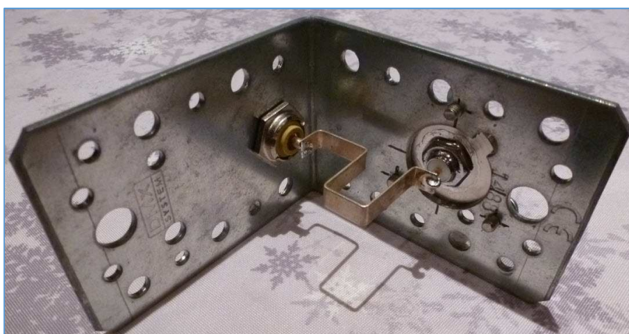
Fig. 60 : Idem figure précédente avec vue sur la boucle de couplage soudée à la pin centrale du connecteur type N par l'intermédiaire d'un petit fil de cuivre recourbé. Photo : ON4IJ.
