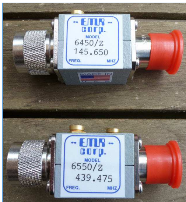
Fig. 83 : Circuits d'adaptation en « Pi » appelés « Z-Matcher » pour obtenir une adaptation parfaite en le PA du TX d'un répéteur et l'ensemble constitué par l'antenne, le feeder et le duplexeur. Au-dessus un modèle pour le répéteur VHF ON0LG sur 145,650 MHz et en dessous un modèle en prévision pour le répéteur UHF ON0LG sur 439,475 MHz. Photo : ON4IJ.
