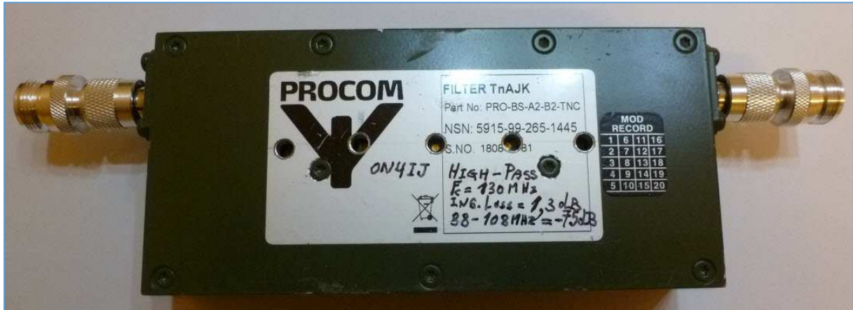
Fig. 99 : Filtre Procom modifié pour obtenir une réjection de la bande FM 88 MHz - 108 MHz de 70 dB (75 dB au mieux) avec une perte d'insertion de 1,3 dB dans la bande VHF 2 m. Photo : ON4IJ.
