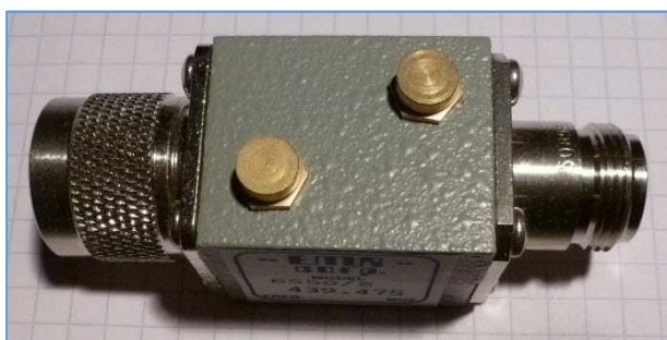
Fig. 85 : Adaptateur d'impédance « Z-Matcher » où l'on peut observer les deux coupelles en laiton de fermeture et de protection d'accès aux vis de réglage des deux condensateurs variables. Photo : ON4IJ.
