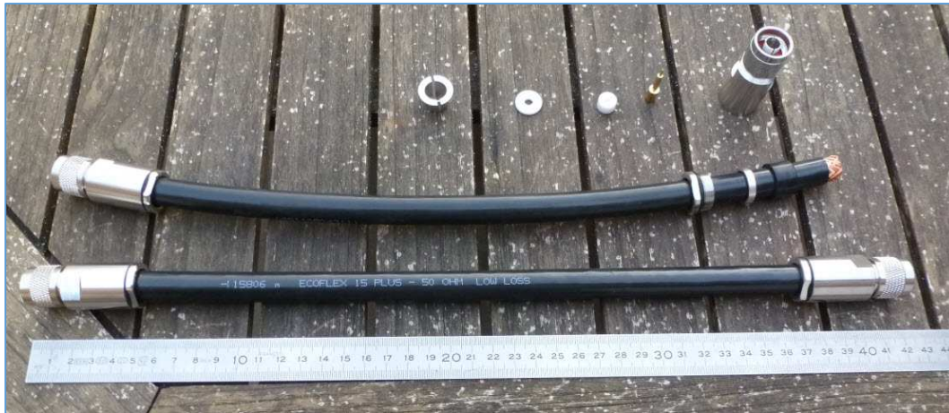
Fig. 64 : Câbles coaxiaux Ecoflex 15 Plus en cours de fabrication avec des connecteurs spécialisés type N pour le harnais de raccordement des cavités du duplexeur du répéteur ON0LG. Sur le dessus du cliché, on peut observer de gauche à droite le manchon de raccordement des blindages du câble coaxial sur la partie intérieure du corps du connecteur type N, la rondelle plate en téflon et la bague en téflon du connecteur, la pin centrale et enfin le corps du connecteur. On remarquera que l'écrou, la bague métallique et le tube caoutchouté du connecteur ont été préalablement enfilés sur le câble coaxial avant d'effectuer la préparation de son extrémité. Photo ON4IJ.
