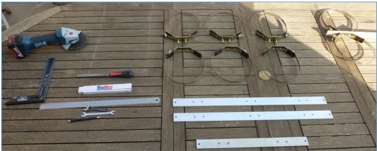
Fig. 69 : Les nouveaux barreaux en aluminium sont prêts à être assemblés sur les colliers de serrage des cavités. À l'avant plan, un ancien barreau du duplexeur d'origine. Photo : ON4IJ.
