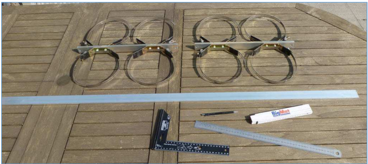
Fig. 66 : Barreaux en aluminium d'origine pour la fixation des quatre cavités d'un duplexeur Wacom WP-641 avec leurs colliers de serrage. À l'avant plan du cliché, un méplat d'aluminium approvisionné et prêt à être usiné pour accueillir la fixation des six cavités. Photo : ON4IJ.
