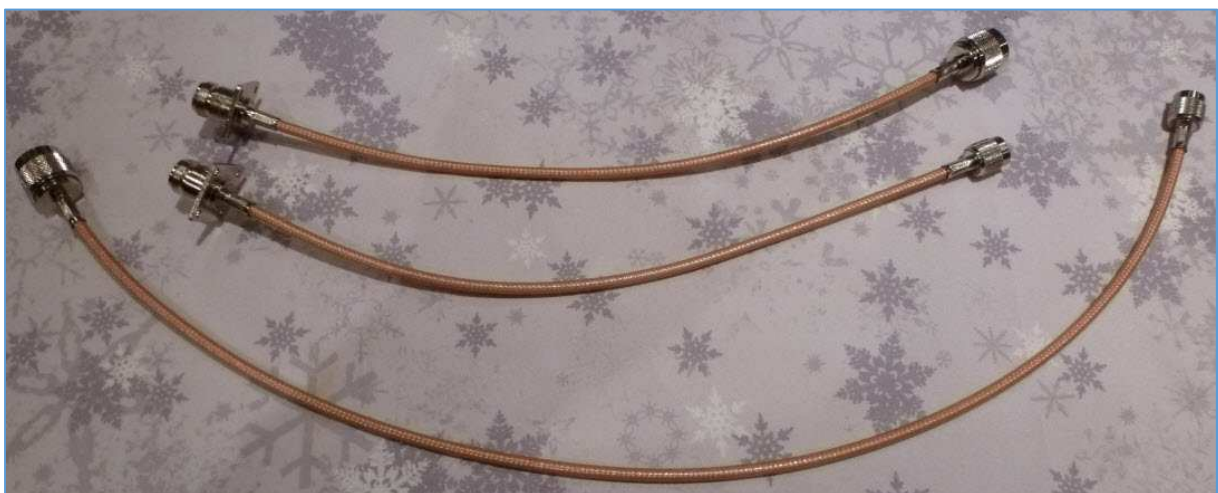
Fig. 113 : Câbles coaxiaux RG400/U fabriqués pour les liaisons internes du DR-1X avec filtre RX. Photo : ON4IJ.
