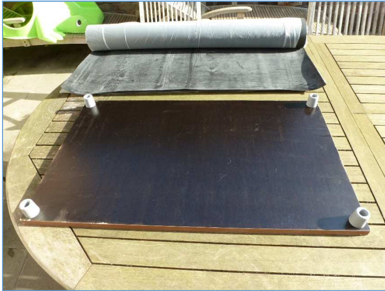
Fig. 142 : Socle en bois avec pieds en caoutchouc pour la pose des cavités du duplexeur. Photo : ON4IJ.
