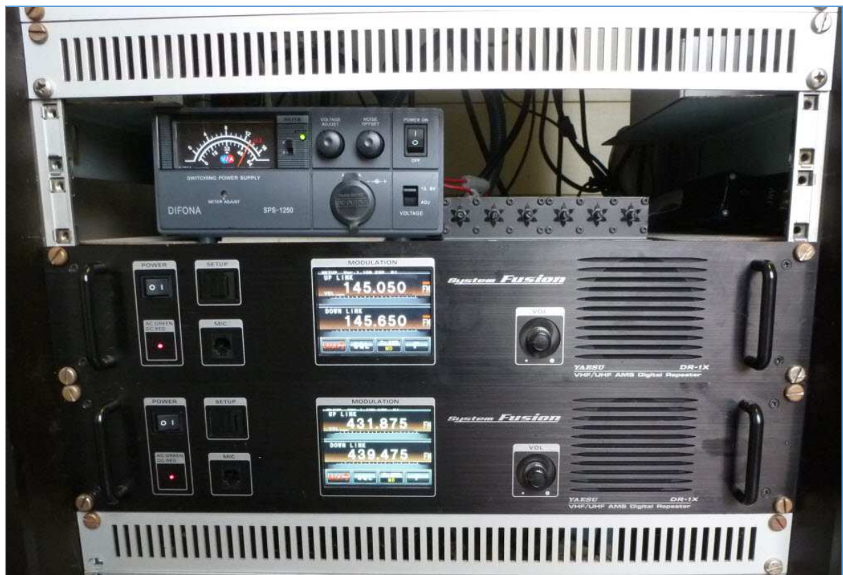
Fig. 9 : Répéteurs ON0LG VHF et UHF avec alimentation 13,8 V et vue du duplexeur UHF en haut à droite (la petite boîte noire avec les six vis de réglage). Photo : ON4IJ.
