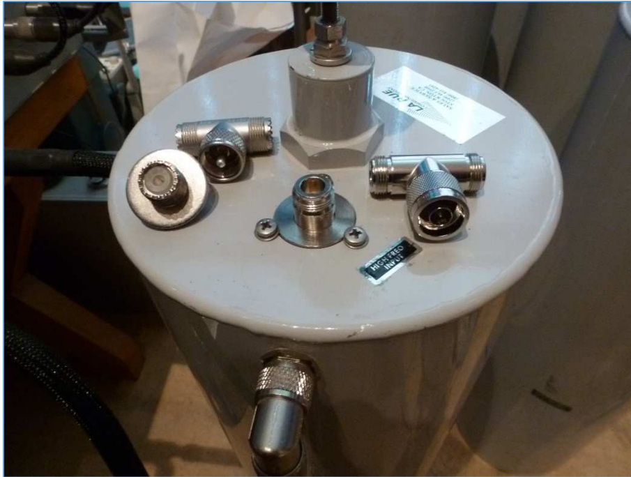
Fig. 51 : Vue du sommet d'une cavité d'un duplexeur Wacom WP-641 où l'on peut observer l'interface mécanique sous forme d'une rondelle épaisse en laiton nickelé fixée par l'intermédiaire de trois vis de pression. À gauche, un connecteur UHF sur la rondelle d'interface mécanique avec un « Té » UHF, à droite, un « Té » type N, au centre le résultat de la transformation de la cavité avec un connecteur type N. Photo : ON4IJ.
