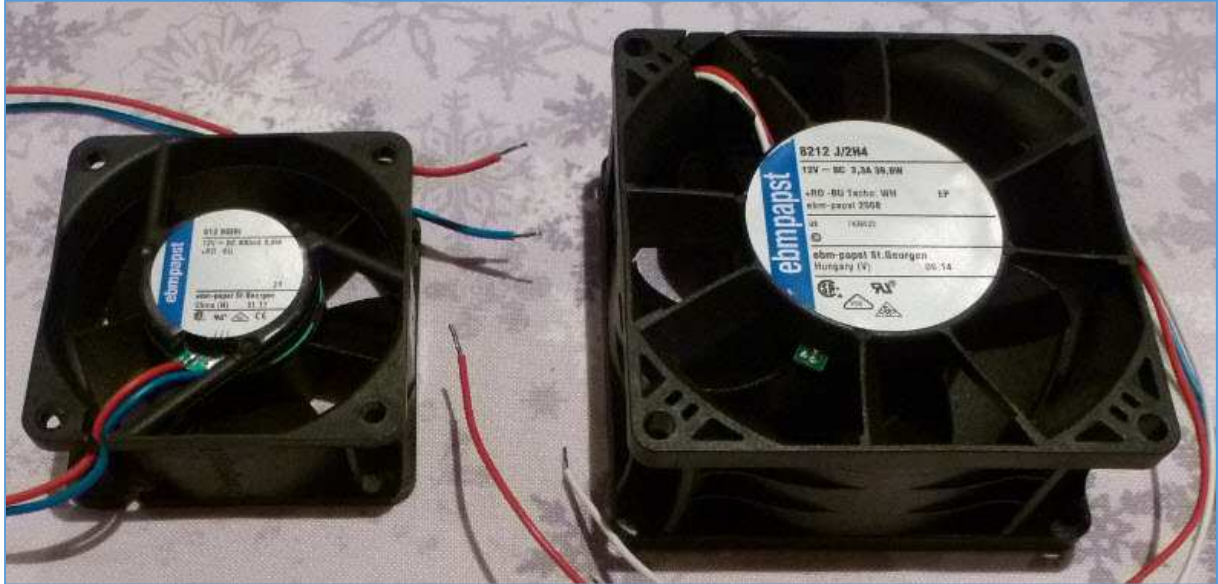
Fig. 117 : Ventilateurs EBM-Papst d'un débit d'air forcé supérieur aux ventilateurs d'origine d'un rack Yaesu DR-1X. Photo : ON4IJ.
