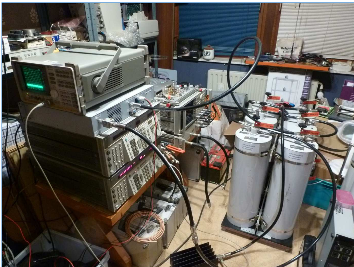
Fig. 133 : Setup de mesure pour les tests finaux du répéteur ON0LG VHF. À gauche de bas en haut : deux générateurs HP 8662A, rack DR-1X avec Z-Matcher raccordé directement à la sortie TX, analyseur de spectre HP 8563E. À droite : le duplexeur Wacom WP-641 modifié avec 6 cavités. Au centre en bas : atténuateur de puissance Bird 500-WA-FFN-30 (30 dB) (noir à ailettes) avec atténuateur Narda 776-20 (20 dB) qui se situe hors du cadre de la photo ; un coupleur « Iso-T » ( Sampler ) Cellwave est placé juste avant l'entrée de l'atténuateur de puissance. Au centre à l'arrière-plan : analyseur de réseau vectoriel HP 8753C avec S-parameter test set HP 85047A ayant servi à effectuer de nombreuses mesures sur le duplexeur. Photo : ON4IJ.
