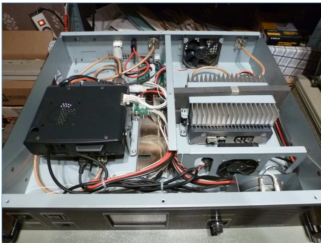
Fig. 114 : DR-1X modifié avec filtre RX et nouveaux câbles coaxiaux RG400/U. Photo : ON4IJ.
