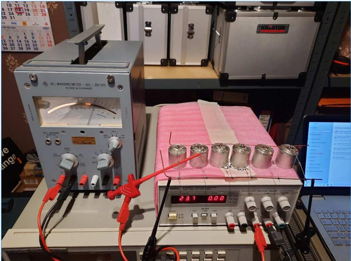
Fig. 81 : Tests et reformage de la couche d'oxyde de condensateurs de 700 $\mu$ F / 60 V Mallory CLR17 *Wet Slug Tantalum*. Cliché : ON4IJ.
