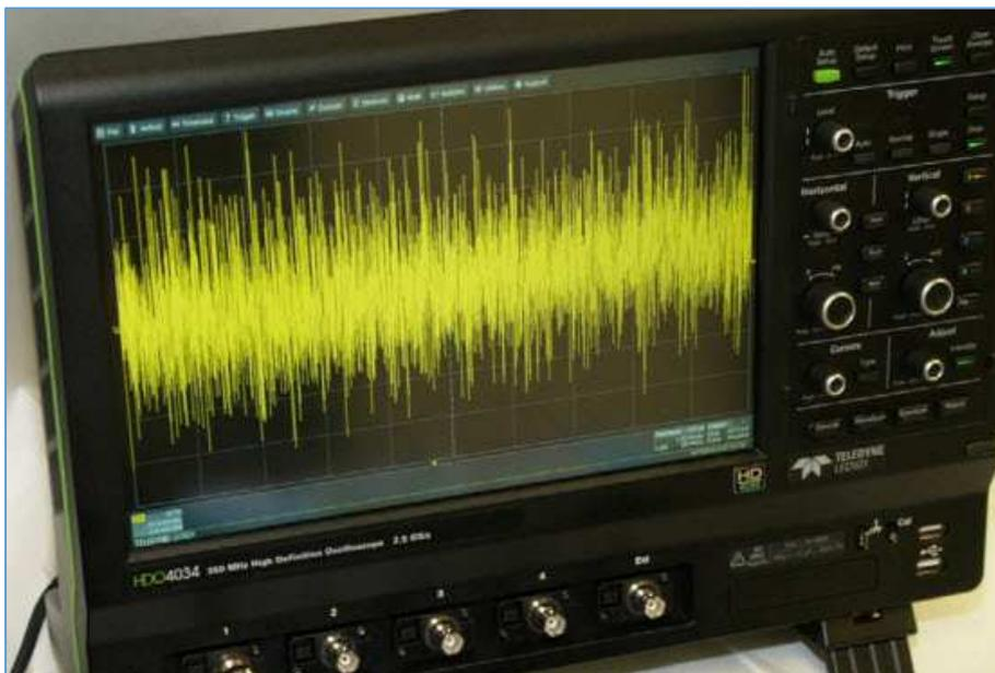
Fig. 40 : Visualisation de la tension de bruit Peak-to-Peak d'un amplificateur dans le domaine du temps sur un oscilloscope. Source : Linear Technology, Application Note 159.
