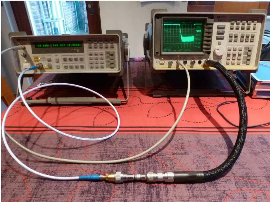
Fig. 43 : Filtre passe-bas coaxial HP 11686A, fréquence de coupure de 13 GHz.
