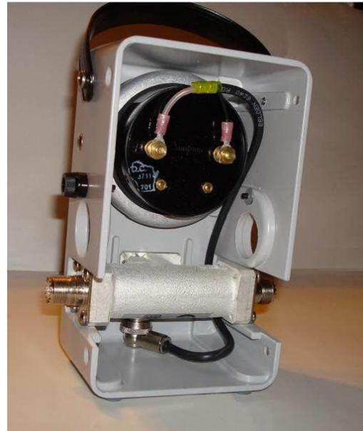
Fig. 21 : Vue arrière de l'instrument de mesure Bird 43 où on peut observer le coupleur directionnel à la partie inférieure de l'appareil. Source : Meterbuilder.
