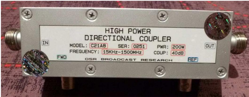
Fig. 17 : Coupleur directionnel double large bande de haute puissance 200 W, de 15 kHz à 1500 MHz.
