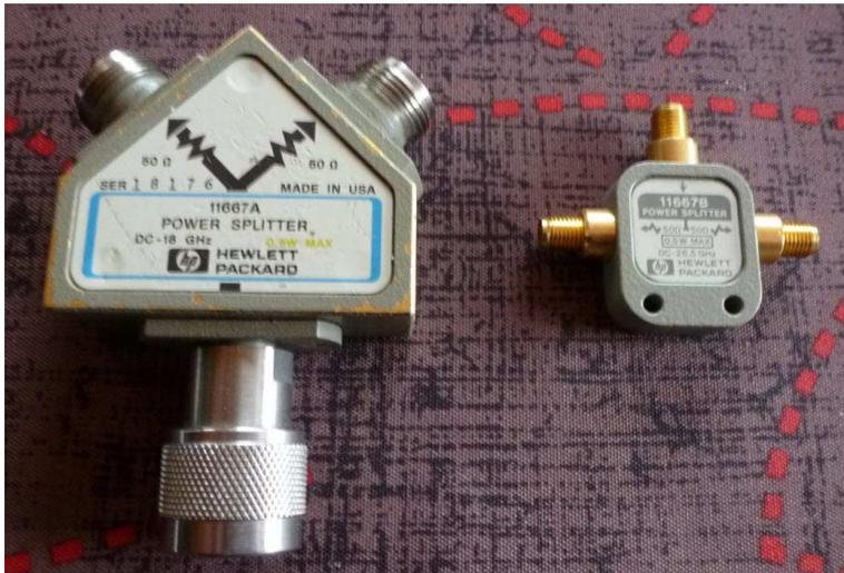
Fig. 59 : Séparateurs de puissance (*Power Splitter*) ; (à gauche) HP 11667A, bande passante : DC – 18 GHz ; (à droite) HP 11667B, bande passante : DC – 26,5 GHz.
