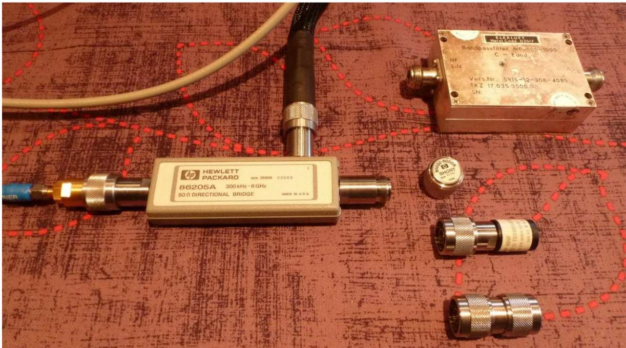
Fig. 32 : Idem figure ci-dessus avec vue de détail sur la sortie du pont directionnel prêt à accueillir soit le calibre de court-circuit, soit une charge étalon, soit le dispositif sous test avec un connecteur adaptateur en « I » type N mâle-mâle.
