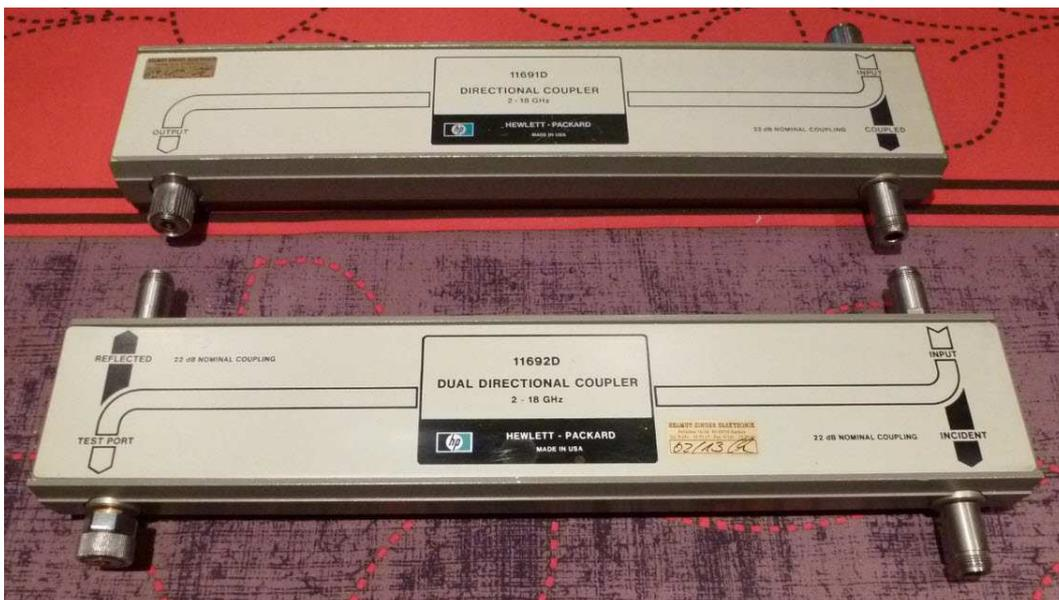
Fig. 16 : (En haut) coupleur directionnel simple large bande HP 11691D, de 2 GHz à 18 GHz ; (en bas) coupleur directionnel double large bande HP 11692D, de 2 GHz à 18 GHz.
