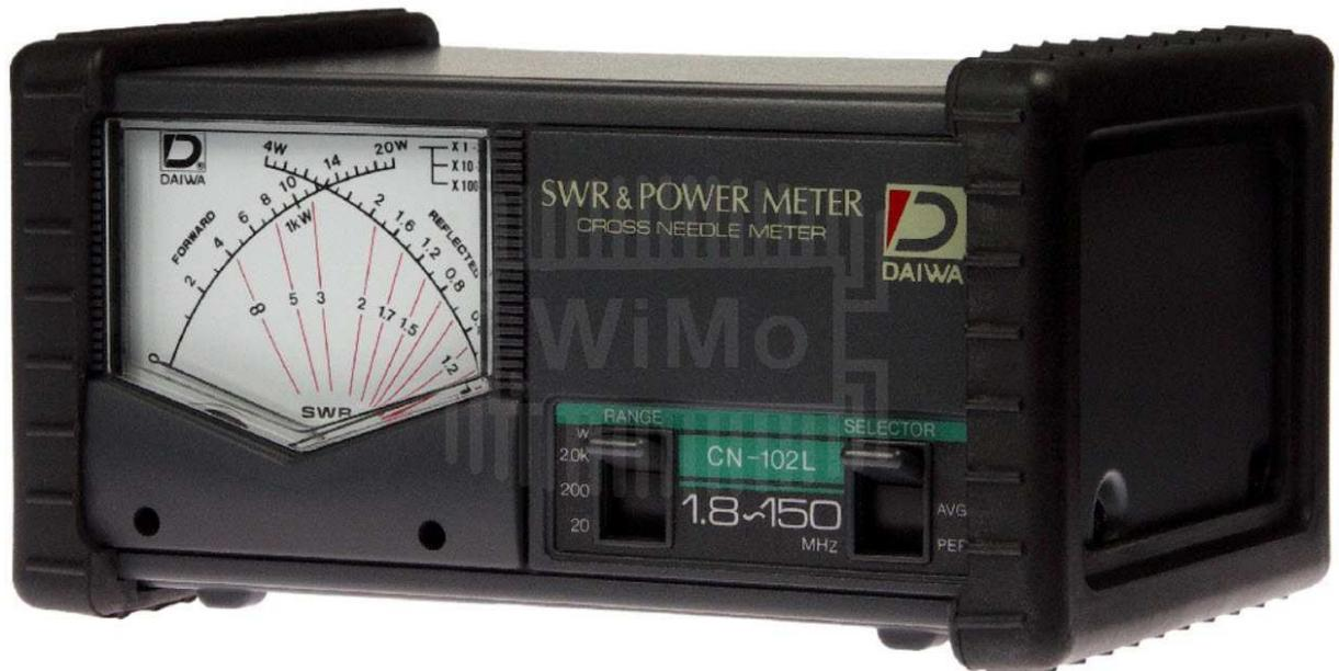
Fig. 19 : Wattmètre directionnel – ROS-mètre Daiwa CN-102L avec coupleur directionnel intégré. La lecture du SWR s’effectue en temps réel sur des graduations situées au point de croisement des deux aiguilles. Source Wimo.
