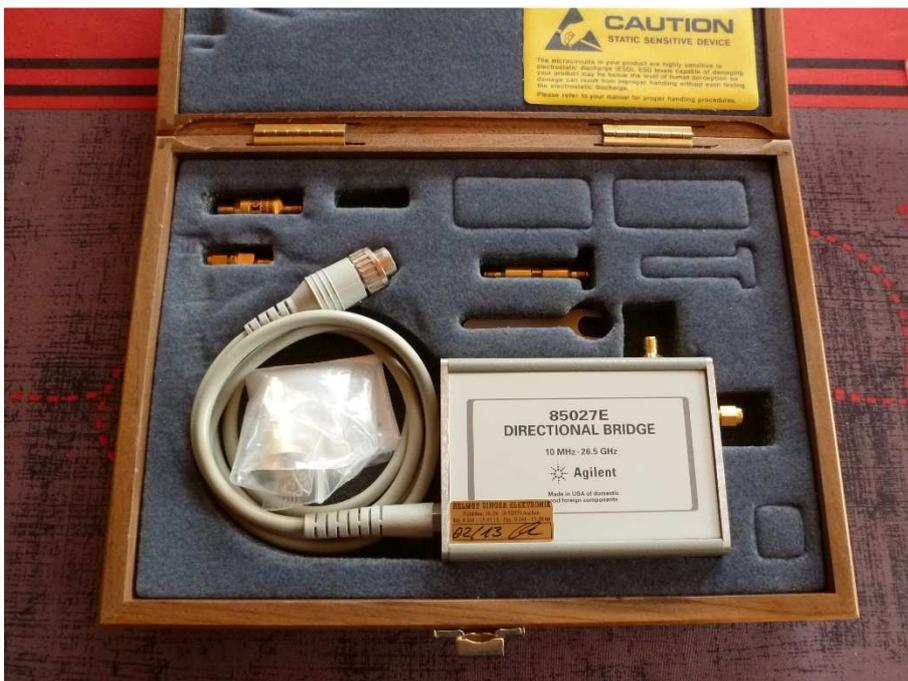
Fig. 67 : Pont directionnel Agilent 85027E, 10 MHz à 26,5 GHz avec accessoires ; calibres court-circuit (*Short*), de circuit ouvert (*Open*), charge (*Load*) et connecteurs adaptateurs en « I ».
