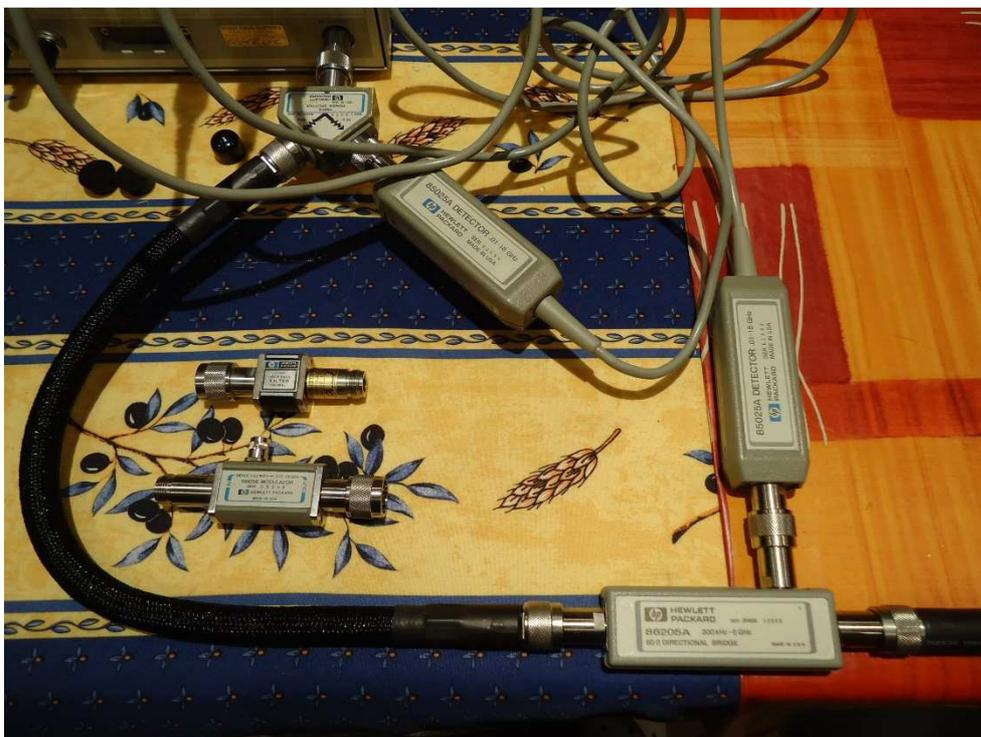
Fig. 69 : Idem ci-dessus avec vue de détail sur le séparateur de puissance, le pont directionnel et deux des trois détecteurs. Dans le coin inférieur gauche du cliché, on peut apercevoir un modulateur externe et un filtre passe-haut qui ne sont pas raccordés.
