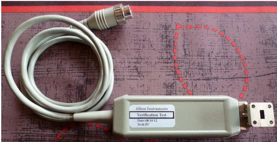
Fig. 64 : Idem ci-dessus avec vue sur l'entrée HF du détecteur directement prévue pour le raccordement sur une bride de guide d'onde au standard WR-28 (26,5 GHz à 40 GHz).
