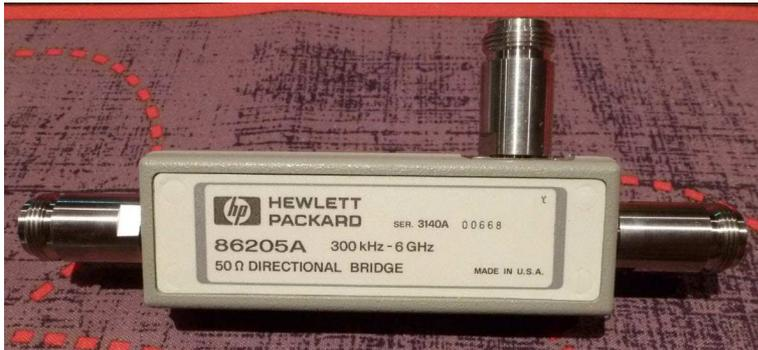
Fig. 27 : Pont directionnel HP 86205A, bande passante de 300 kHz à 6 GHz, directivité de 40 dB jusqu'à 2 GHz.
