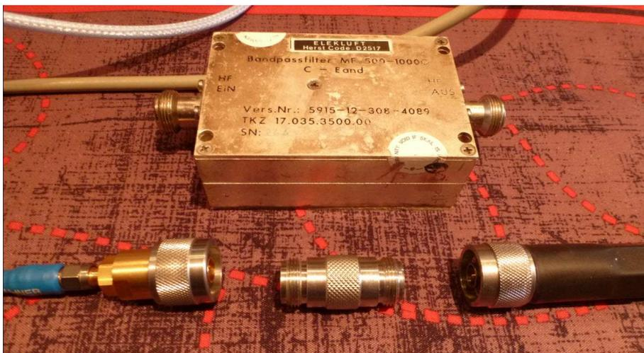
Fig. 6 : Pour établir un 0 dB de référence pour la mesure de transmission, le dispositif sous test est substitué par un connecteur adaptateur en « I » (« *Thru* »).
