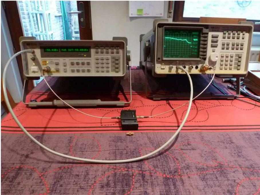
Fig. 50 : Préamplificateur large bande Aronia AG Germany, type UBBV2, de 1 MHz à 10 GHz, gain de 40 dB, figure de bruit typique de 3,5 dB.
