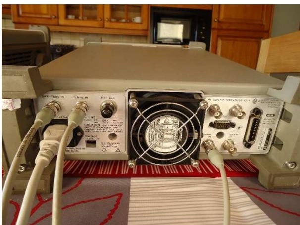
Fig. 4 : Vue des connexions de raccordement à l'arrière du générateur suiveur à balayage.
