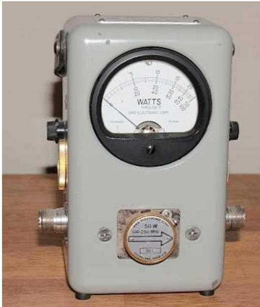
Fig. 20 : Le légendaire wattmètre directionnel Bird 43 créé au début des années 1950 et toujours actuel en 2016. Plus de 60 ans d'existence ! Source WD4EUI.
