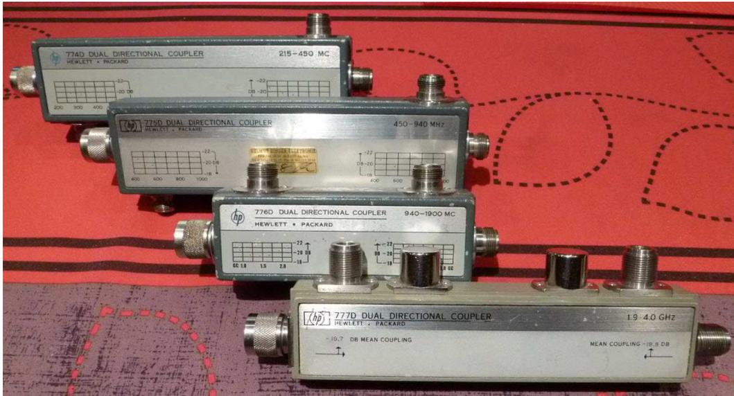
Fig. 14 : Coupleurs directionnels doubles ; HP 774D, de 215 MHz à 450 MHz ; HP 775D, de 450 MHz à 940 MHz ; HP 776D, de 940 MHz à 1900 MHz ; HP 777D, de 1,9 GHz à 4,0 GHz.
