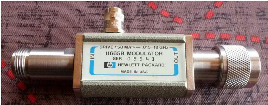
Fig. 61 : Modulateur externe HP 11665B piloté par le SNA. La modulation est du type tout-ou-rien et est pilotée par un signal carré.
