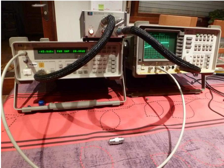
Fig. 56 : Test de compression de gain du préamplificateur suivi de l'amplificateur illustré ci-dessus. Comme le gain de l'ensemble est relativement élevé, un atténuateur de -50 dB HP 8491B a été placé à la sortie de l'amplificateur afin d'éviter un niveau de puissance trop élevée à l'entrée de l'analyseur de spectre.
