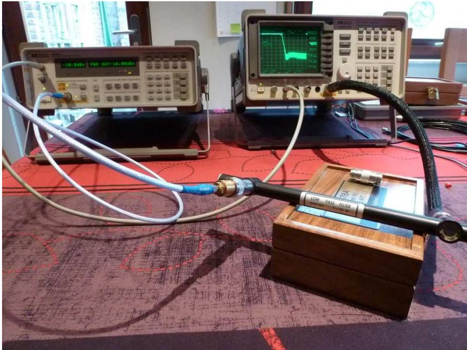
Fig. 41 : Filtre passe-bas coaxial HP 360A, fréquence de coupure de 700 MHz.
