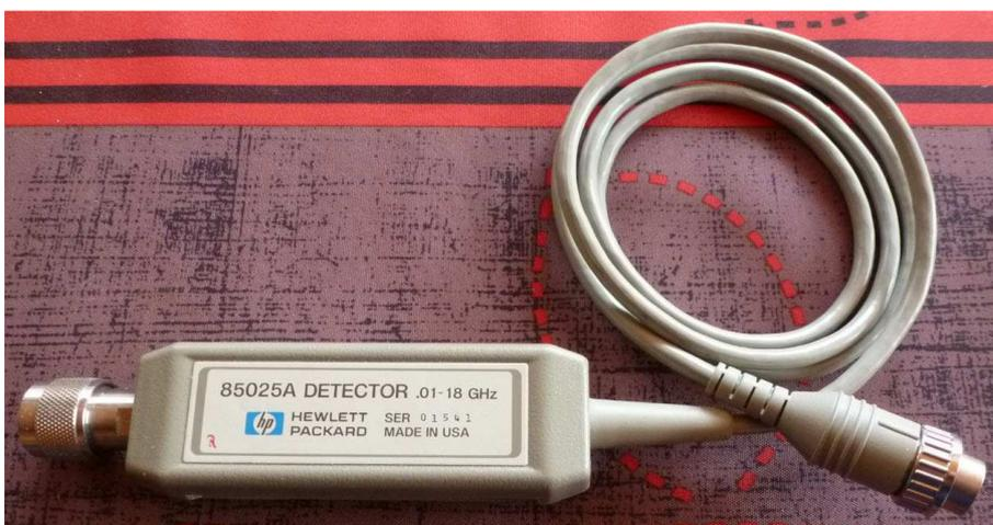
Fig. 62 : Détecteur HP 85025A, bande passante de 10 MHz à 18 GHz.
