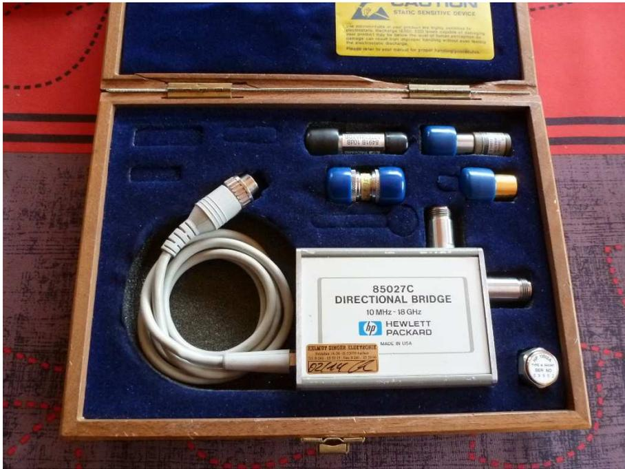
Fig. 66 : Pont directionnel HP 85027C, 10 MHz à 18 GHz avec accessoires ; calibres de court-circuit (*Short*), de circuit ouvert (*Open*), charge (*Load*), connecteur adaptateur en « I » et atténuateur -10 dB.
