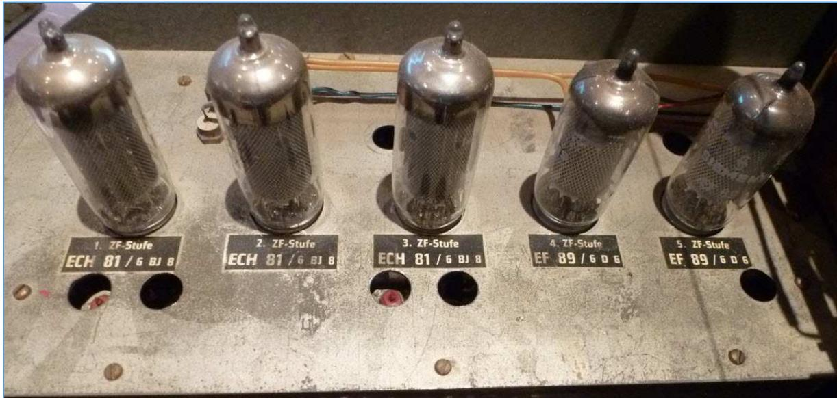
Fig. 41 : Bloc moyenne fréquence du RX avec pas moins de cinq tubes, trois triodes-heptodes (pentagrid) ECH81 (6AJ8) et deux pentodes EF89 (6DA6). Photo : ON4IJ.
