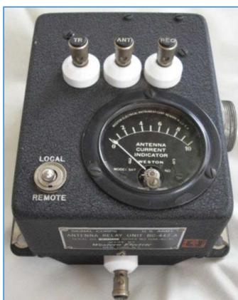
Fig. 35 : Relai d'antenne BC-442-A. Source : eHam.net, posted by K9LCR, 15.02.2010.
