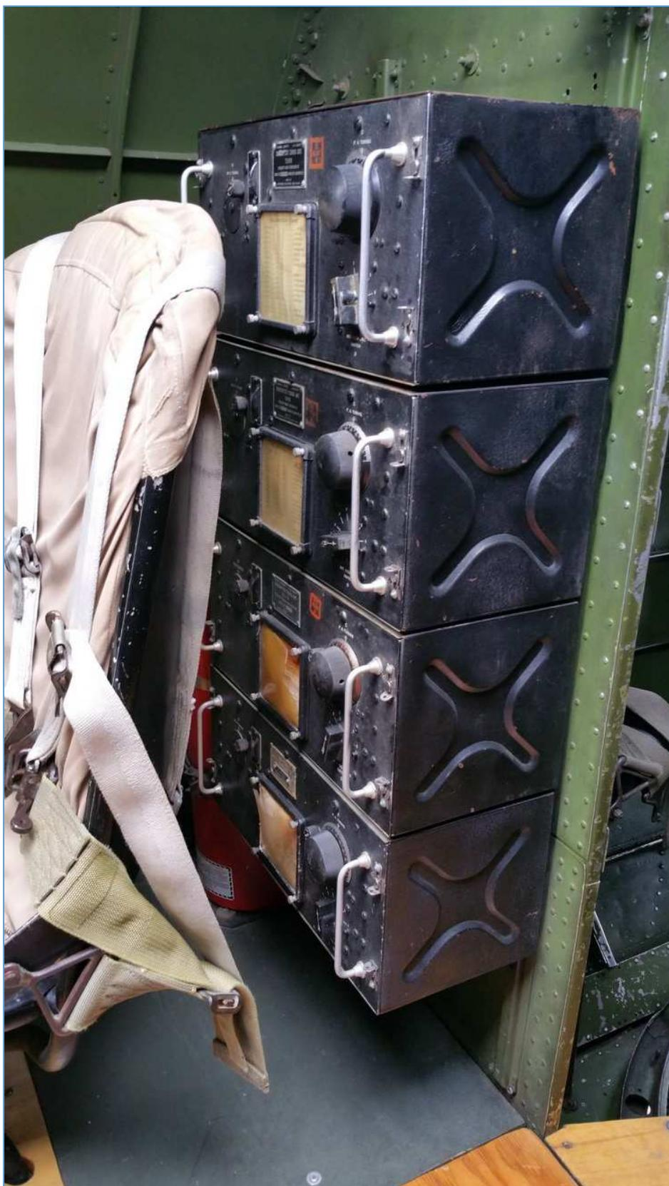
Fig. 21 : Ensemble de racks *Tuner Units* TU-xB dans leurs coffrets de transport CS-48 à bord d'un avion B-17. Source : KF4LMT's Radio Shack B-17G « Texas Raiders » at Savannah, Commemorative Air Force's Gulf Coast Wing « Texas Raiders », Conroe North Houston Regional Airport, Conroe, Texas, USA.
