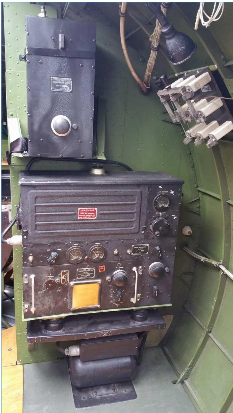
Fig. 20 : TX BC-375 à bord d'un avion B-17 ; on remarquera le dynamotor PE-73C qui fournit entre autres la tension plaque de 1000 Vdc aux quatre tubes VT-4C. On peut aussi admirer un inverseur d'antenne sous la forme d'un sectionneur à couteaux avec d'impressionnants isolateurs en stéatite. Source : KF4LMT's Radio Shack B-17G « Texas Raiders » at Savannah, Commemorative Air Force's Gulf Coast Wing « Texas Raiders », Conroe North Houston Regional Airport, Conroe, Texas, USA.
