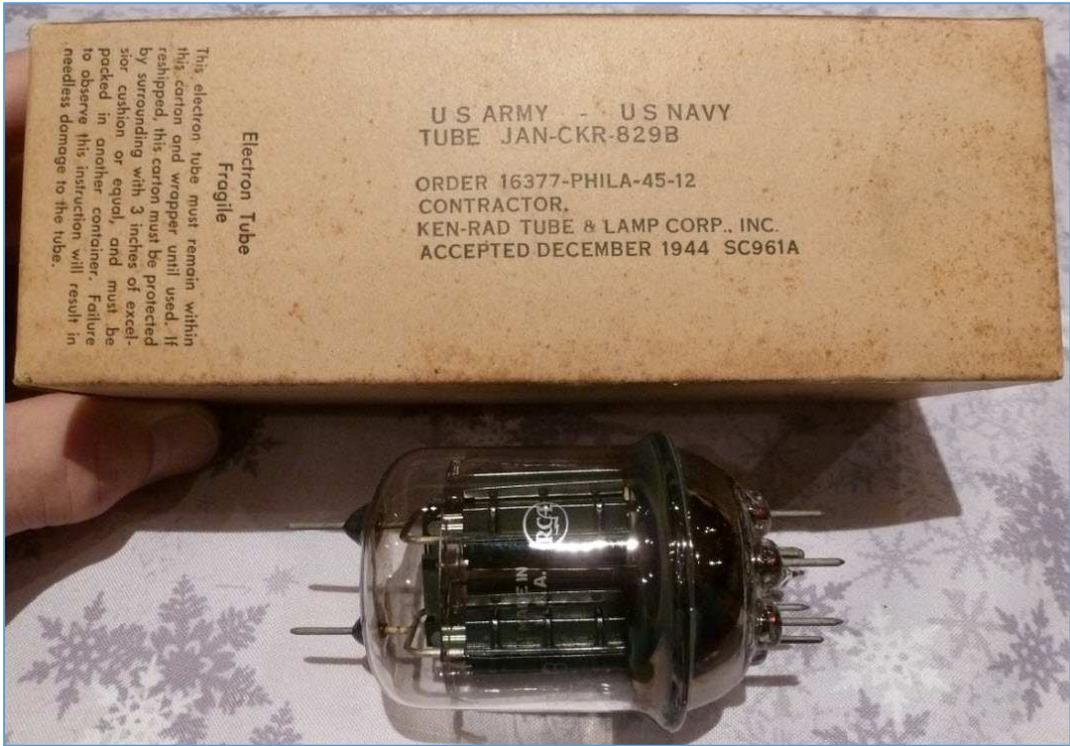
Fig. 7 : Double tétrode 829B neuve de réserve dans son emballage scellé d'origine et datant de 1944 ; juste devant, un autre tube 829B de réserve (fabrication RCA). Photo ON4IJ.
