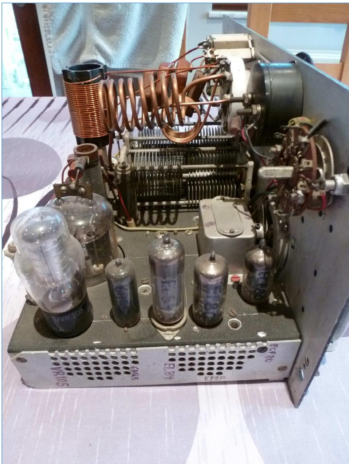
Fig. 8 : Vue latérale du TX où l'on peut mieux observer les tubes radio. Photo : ON4IJ.
