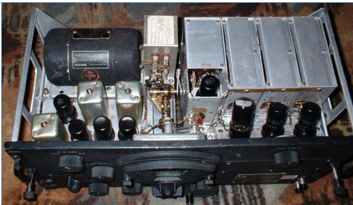
Fig. 47 : Vue du dessus d'un récepteur BC-348, version avec dynamotor. Source : Ralph M. Hartwell W5JGV.
