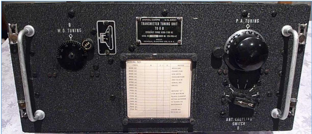
Fig. 25 : Transmitter Tuner Unit TU8-B (NOS : New Old Stock) utilisé avec le TX BC-375. Photo : ON4IJ.
