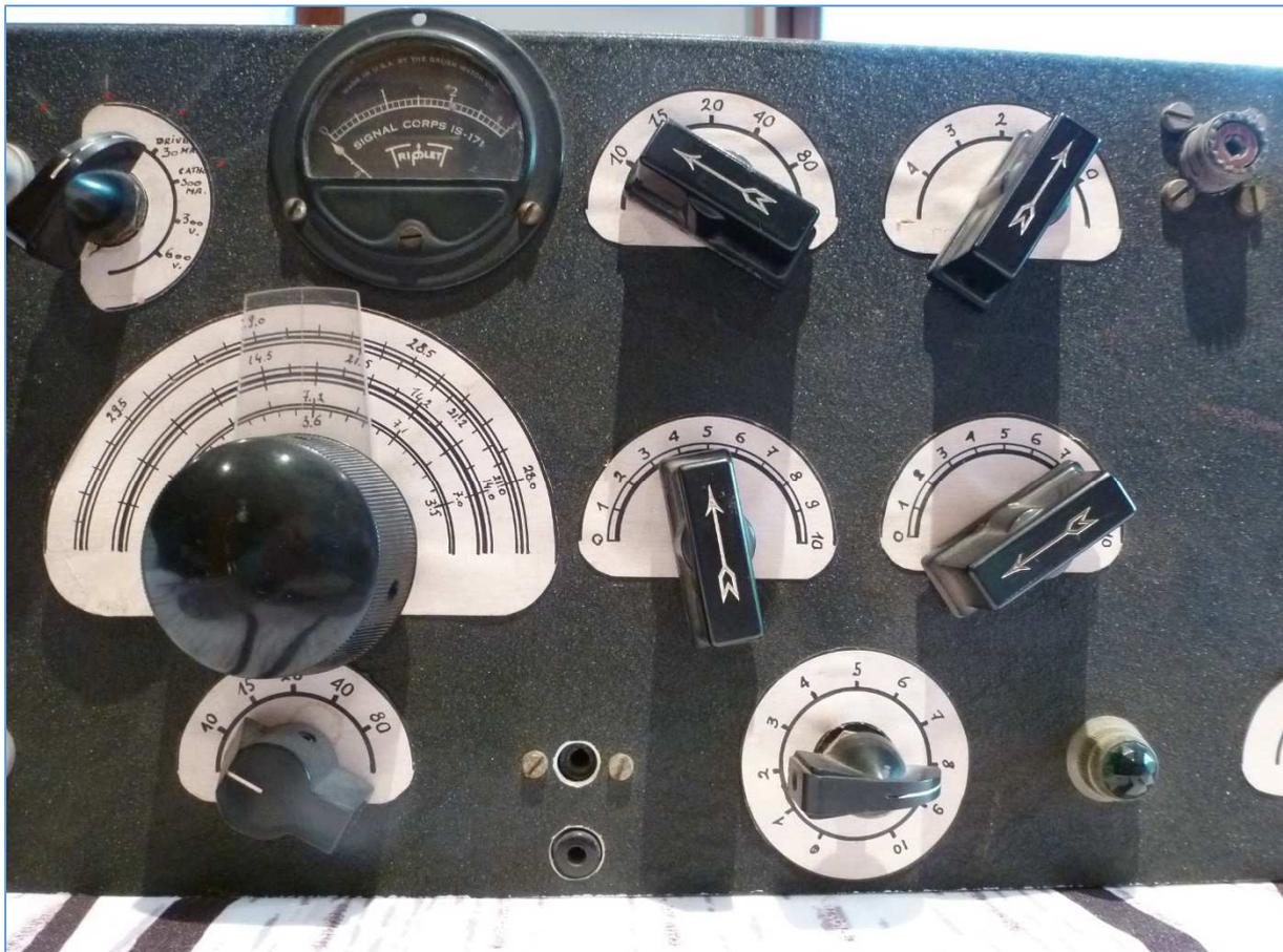
Fig. 3 : Détail des graduations des dispositifs de réglage du TX, tracées à l'encre de chine sur du papier de machine à écrire. Photo : ON4IJ.
