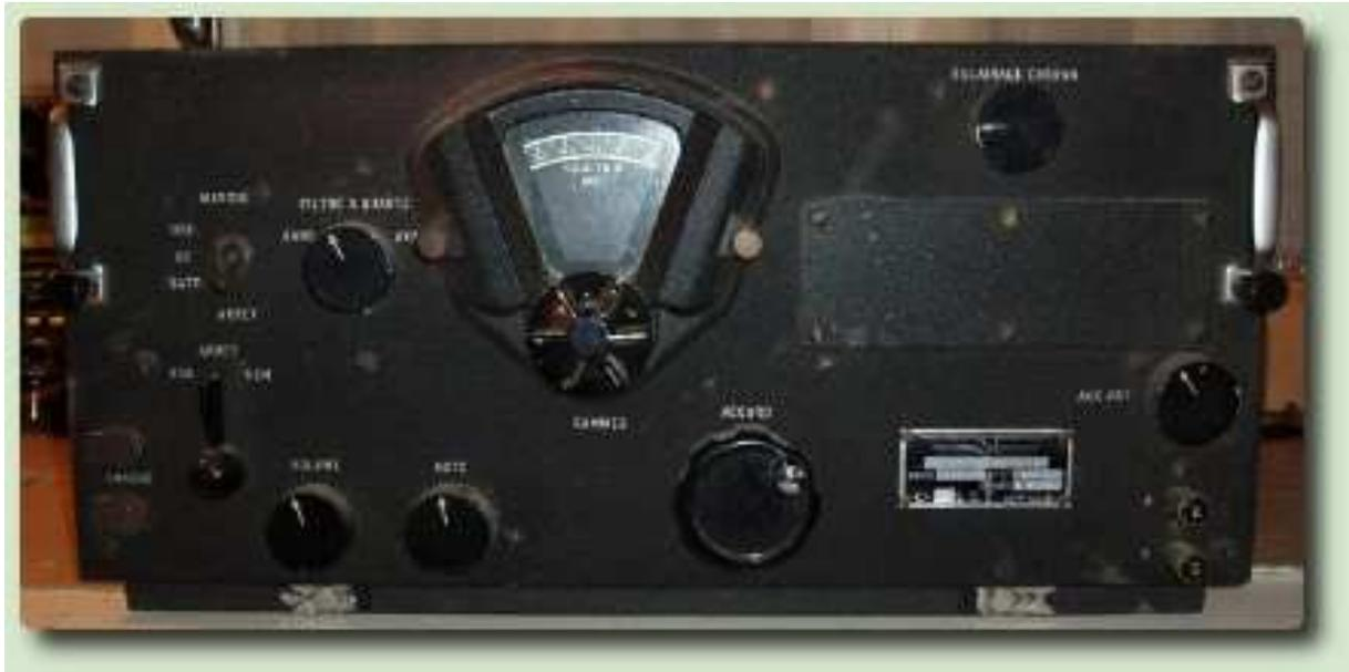
Fig. 45 : Récepteur BC-348 de l'US Air Force utilisé à bord des avions B17 pendant la deuxième guerre mondiale. Source : ARACMA Association des RadioAmateurs Constructeurs et Collectionneurs en Modulation d'Amplitude, F1APJ, F2XI, F1AFF, F5MAF, France.
