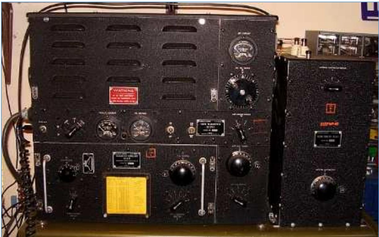
Fig. 14 : Émetteur BC-375 avec un *Tuner Unit* TU-xB et un *Antenna Tuning Unit* BC-306-B. Le tout était embarqué à bord des avions bombardiers B-17 de l'armée américaine US Air Force lors de la deuxième guerre mondiale. Source : Radioblvd, Henry Rogers, Radio-Boulevard Western Historic Radio Museum.
