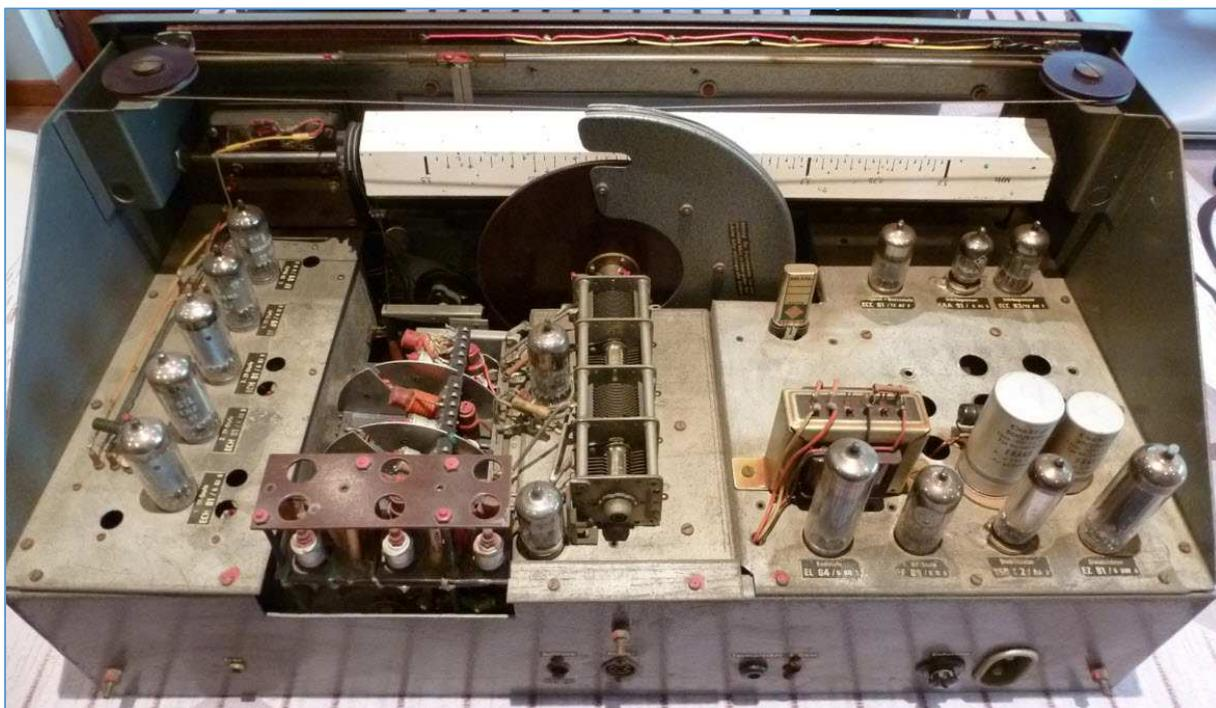
Fig. 39 : Vue intérieure du récepteur RX 57 fabriqué par la société Max Funke de Adenau en Allemagne. On peut observer sur cette figure le mécanisme de changement de bande et celui de l'entraînement du condensateur variable d'accord en fréquence. Photo : ON4IJ.
