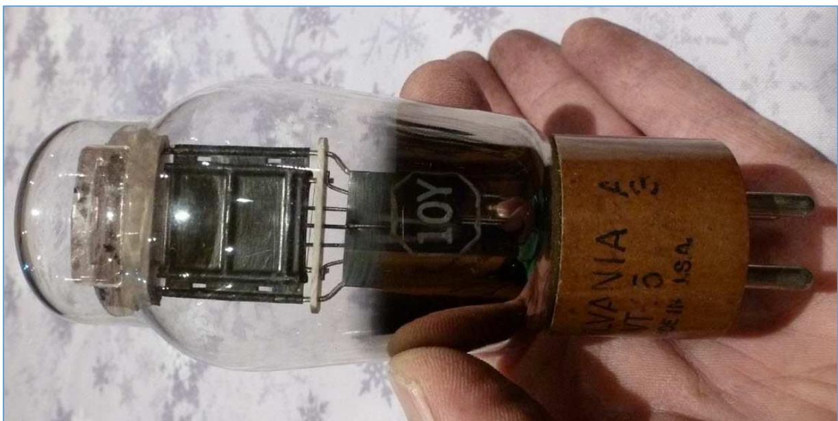
Fig. 17 : Tube VT-25 (10Y), triode de l'ampli BF *Speech and Side Tone* du BC-375. Photo : ON4IJ.
