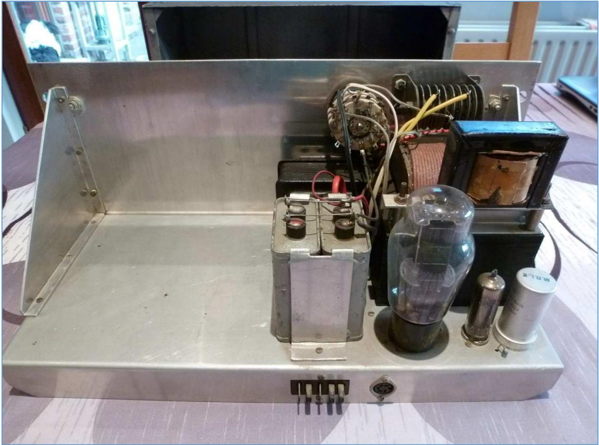
Fig. 32 : Vue interne de l'alimentation du TX de la station ON4IJ. À l'avant plan à droite, on peut observer les deux tubes redresseurs (valves bi-plaques). Un emplacement libre sur la partie gauche du rack avait été prévu pour y loger un modulateur AM avec deux pentodes 807, mais ce modulateur n'a jamais été réalisé. Photo : ON4IJ.
