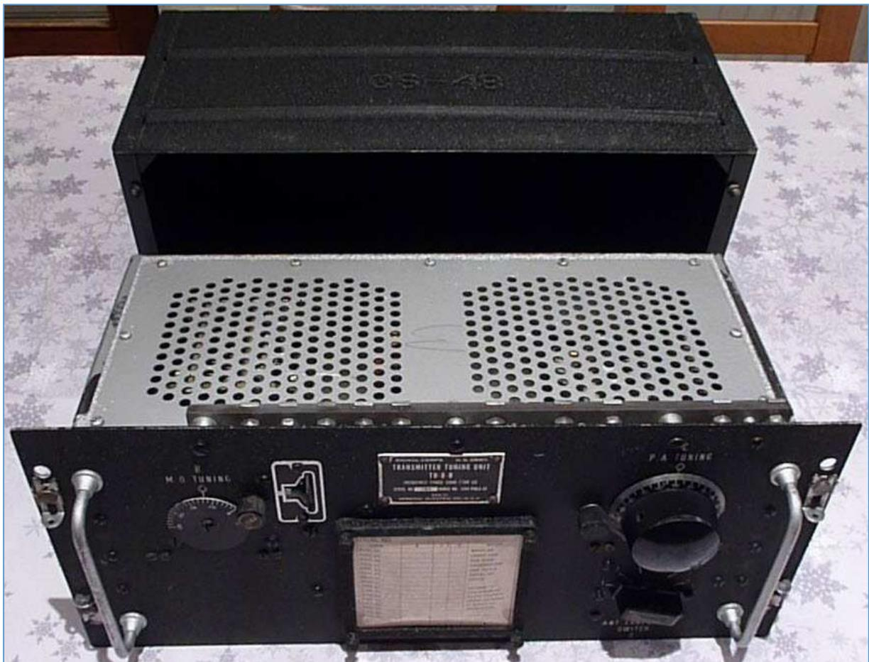
Fig. 26 : TU-8B et son coffret de transport et de stockage CS-48. Le Tuner Unit est complètement blindé au moyen d'un berceau en « U » fixé sur la face avant et avec deux couvercles ajourés (supérieur et inférieur) fixés au berceau par plusieurs vis. Photo : ON4IJ.
