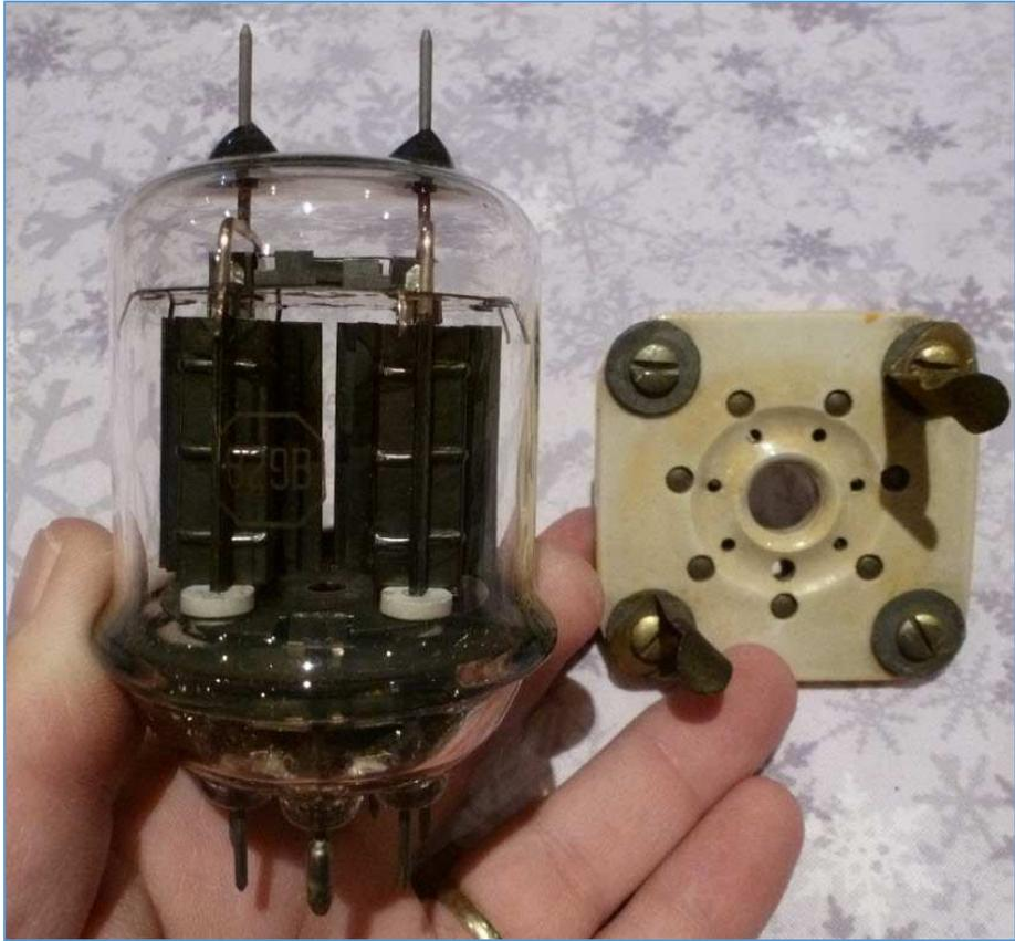
Fig. 6 : Tube radio du PA, une double tétrode à faisceau dirigé JAN-CRC-829B ; une forme particulièrement exotique de tube radio où les broches de connexions aux électrodes sont directement constituées de soudures verre-métal. Juste à côté, un soquet en stéatite pour ce tube. Photo : ON4IJ.
