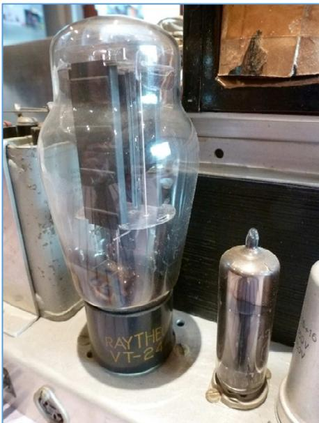
Fig. 33 : Tube redresseur VT-244 (5U4G) de la THT 600 V et tube redresseur 6X4 de la HT 300V. Photo : ON4IJ.
