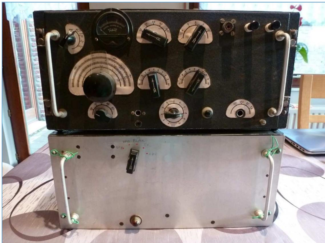
Fig. 2 : Émetteur de télégraphie en ondes courtes radioamateur construit en 1957 par mon papa : Richard Flamée ex-ON4IJ. Photo : Jean-François Flamée ON4IJ ex-ON1KYM.
