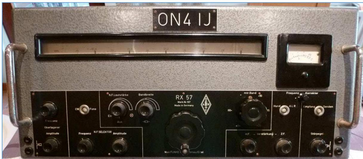
Fig. 38 : Récepteur CW/AM ondes courtes décamétriques, type RX 57 de la société Max Funke à Adenau en Allemagne ; station de Richard Flamée ON4IJ. Photo : Jean-François Flamée ON4IJ.
