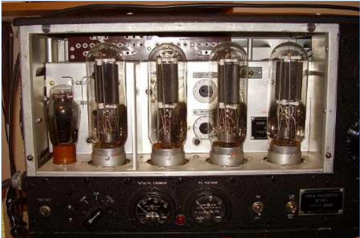
Fig. 15 : Vue interne de l'émetteur BC-375 où l'on peut observer les tubes d'émission ; une triode VT25/10Y et quatre majestueuses triodes VT-4C/211 dont les anodes sont composées de graphite. Source : Radioblvd, Henry Rogers, Radio-Boulevard Western Historic Radio Museum.
