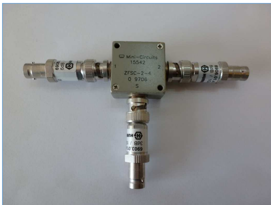
Fig. 1 : Circuit combineur de deux signaux radiofréquence ( Power Splitter/Combiner ) Mini-circuit ZFSC-2-4, signaux en provenance de deux générateurs HF pour être acheminés sans intermodulation à l'entrée RX d'un répéteur VHF sous test. Photo : ON4IJ.
