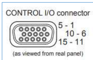
Fig. 13 : Lay-out du connecteur mini Sub-D « control I/O » accessible sur le panneau arrière du rack répéteur Yaesu DR-1X. Source : Yaesu, manuel utilisateur DR-1X.
