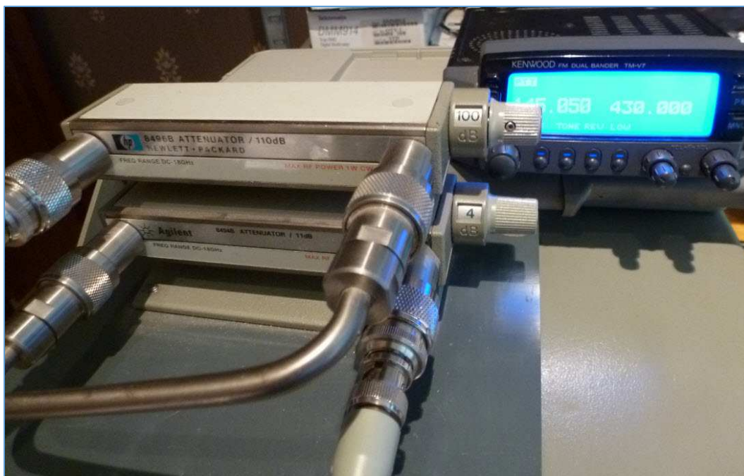
Fig. 17 : Vue de détail sur le réglage des atténuateurs par pas, ici sur -104 dB. Le niveau absolu du signal HF à la sortie du combinateur étant de -20 dBm, on obtient ici une sensibilité de -124 dBm (0,14 \mu V) pour le récepteur sous test Kenwood TM-V7. Photo : ON4IJ.
