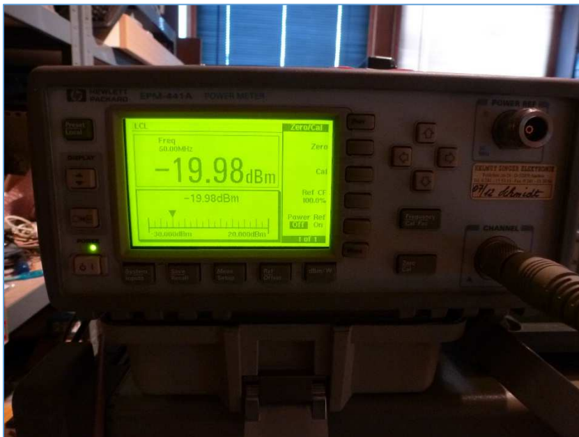
Fig. 4 : Vérification de mesure du niveau absolu de la porteuse d'un seul générateur au moyen d'un bolomètre ( Power Meter ). Le niveau absolu de la porteuse mesurée à la sortie du combinateur est bien de -20 dBm comme cela avait déjà été mesuré au moyen de l'analyseur de spectre. Il s'agit ici d'une vérification de mesure. Photo : ON4IJ.
