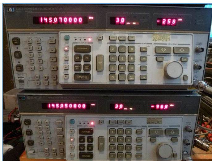
Fig. 21 : Deux générateurs HF HP 8662A modulés en FM pour la mesure de la réjection du canal adjacent d'un répéteur sous test. Les afficheurs numériques et des témoins d'activation des touches de fonction permettent la lecture directe des fréquences HF, des amplitudes HF, de la déviation de la modulation de fréquence et des fréquences modulantes. Photo : ON4IJ.
