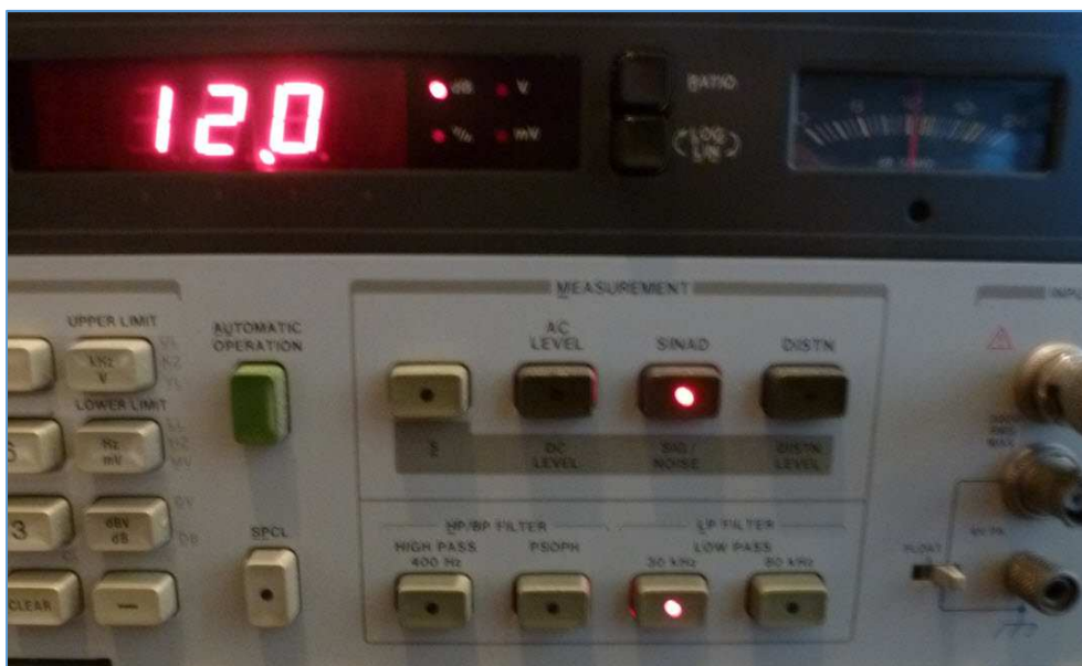
Fig. 16 : Mesure d'un rapport SINAD de 12 dB sur un analyseur audio HP 8903A. Un filtre passe-bas de 30 kHz est activé afin de limiter le souffle hors bande audio. Photo : ON4IJ.
