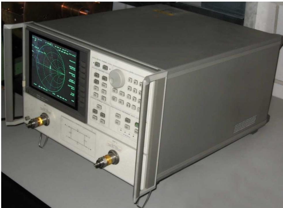
Fig. 2 : Analyseur de réseau vectoriel HP 8720A. Source : Wikipedia Smith Chart.
