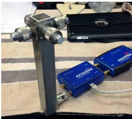
Fig. 95 : Diviseur de puissance (*Power Splitter*) en transformateur quart d'onde ici sous test avec quatre charges étalons et un mini analyseur de réseau vectoriel pour la mesure du SWR dans le domaine de la fréquence. Source Hartmut Klüver DG7YBN, Allemagne.
