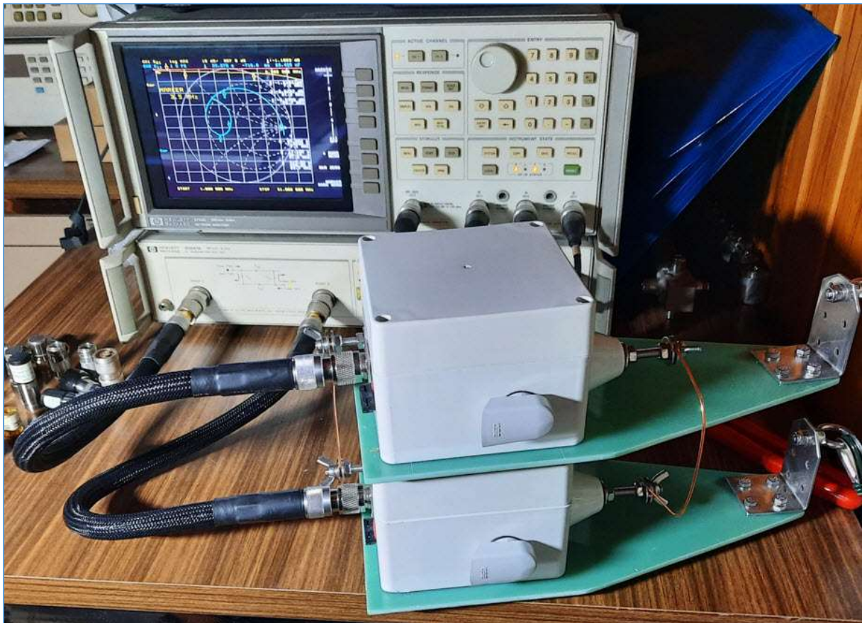
Fig. 62 : Set-up de mesure de deux Unun's raccordés Front-to-Back sur un VNA. Photo : ON4HNO.
