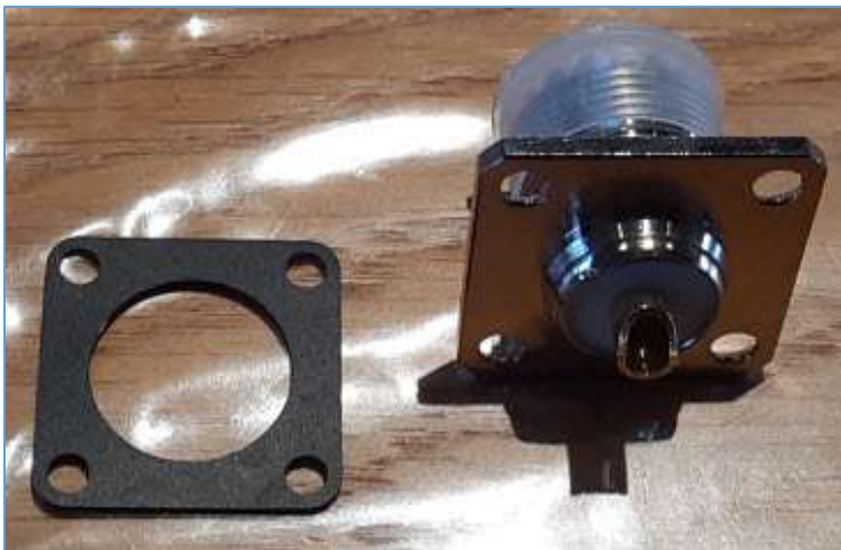
Fig. 51 : Connecteur coax SO-239 et joint d'étanchéité entre la bride de fixation et le boîtier ABS. Photo : ON4HNO.
