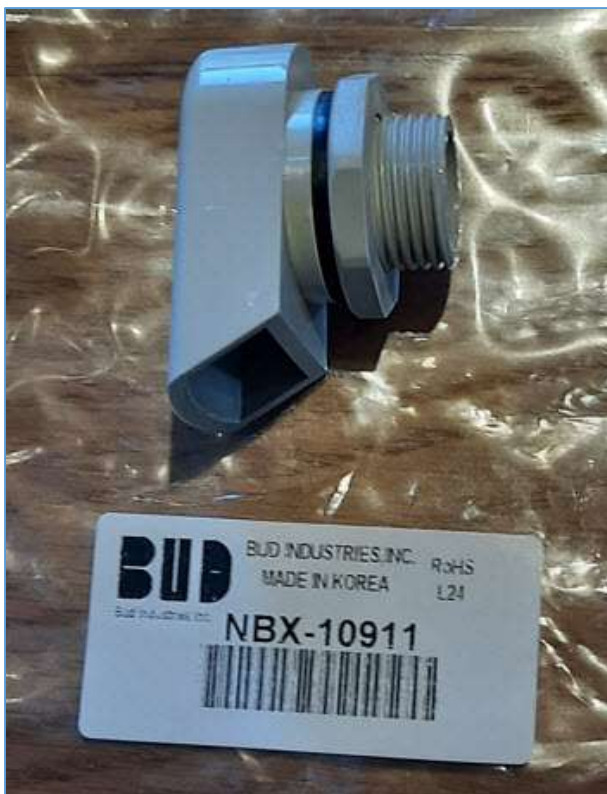
Fig. 57 : Événement pour l'aération de l'intérieur du boîtier Unun. Photo : ON4HNO.
