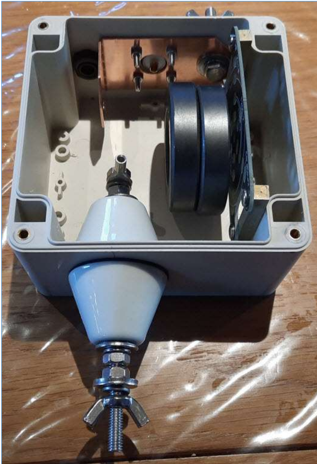
Fig. 53 : Agencement des pièces dans le boîtier ABS pour la construction du Unun, vue du dessus. Photo : ON4HNO.
