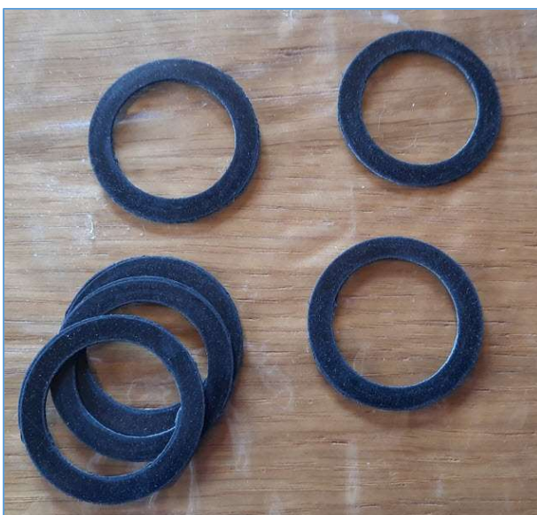
Fig. 25 : Joints plats pour étanchéité entre la porcelaine des isolateurs et le boîtier ABS du Unun. Photo : ON4HNO.
