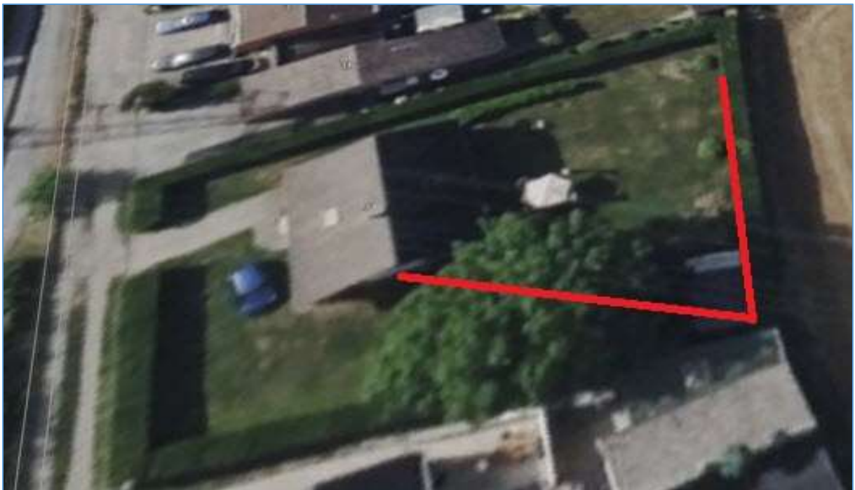
Fig. 1 : Implantation d'une antenne End-Fed entre la maison, la cabane et le fond du jardin. Photo aérienne : Google.
