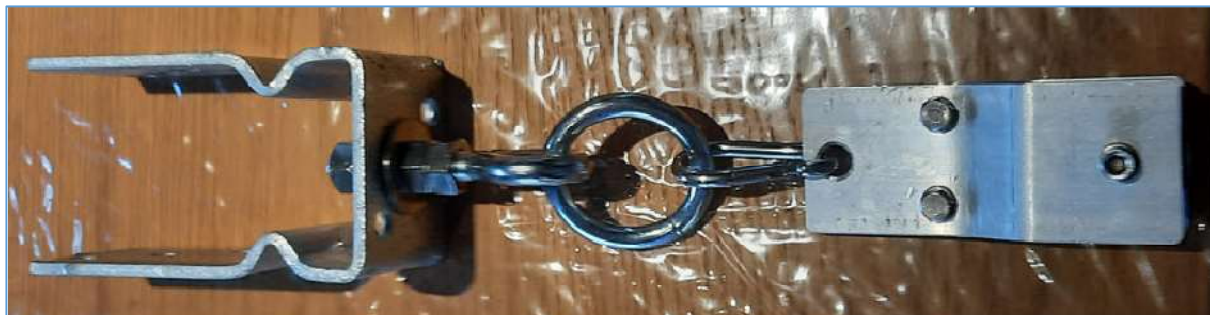
Fig. 7 : Étrier d'arrimage de l'antenne sur le dépassant de la panne faîtière de la toiture. Photo : ON4HNO.
