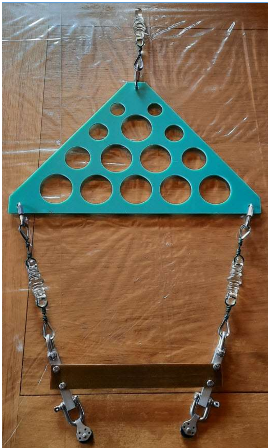
Fig. 23 : Ensemble de montage des deux poulies avec entretoise et triangle en époxy. Photo : ON4HNO.
