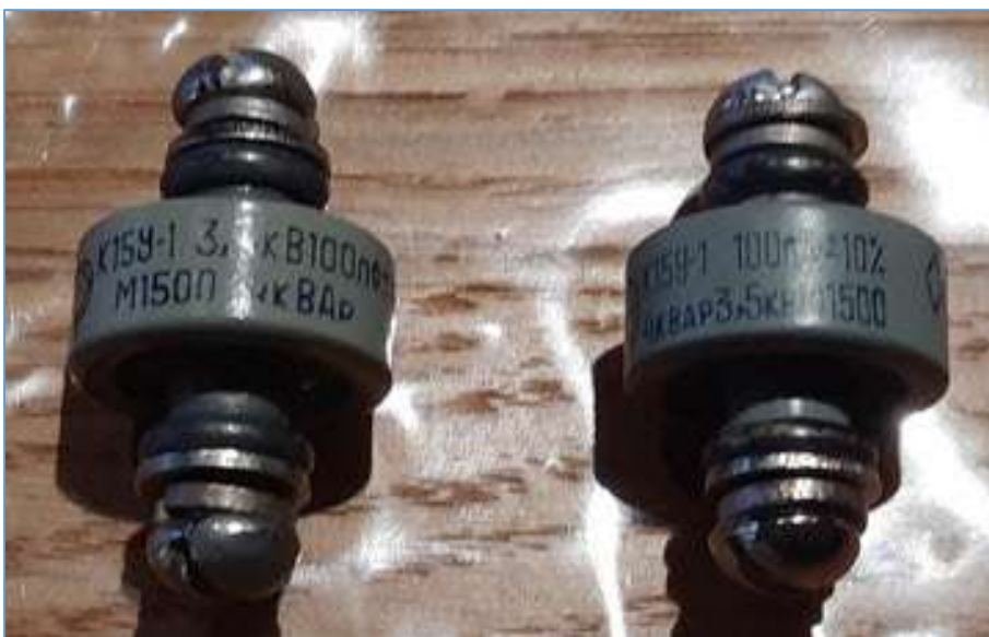
Fig. 46 : Exemple de condensateurs céramique du type « door knob » prévus pour du matériel de transmission radio militaire ; diamètre de 18 mm et longueur hors tout de 28 mm. Photo : ON4HNO.
