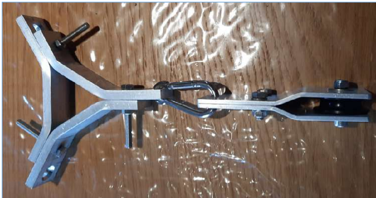
Fig. 8 : Étrier d'haubanage pour l'arrimage de la deuxième poulie située dans l'angle droit formé par le « L » de l'antenne. Photo : ON4HNO.
