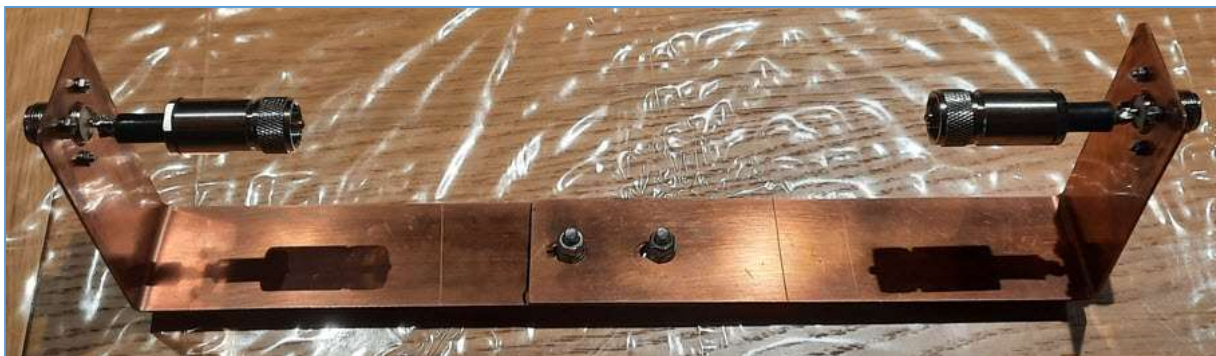
Fig. 66 : Set-up de mesures pour l'évaluation de l'atténuation de mode commun d'un Common Mode Choke Unun. Photo : ON4HNO.
