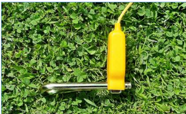
Fig. 35 : Raccordement du piquet de mesure de potentiel au telluromètre. Photo : ON4HNO.
