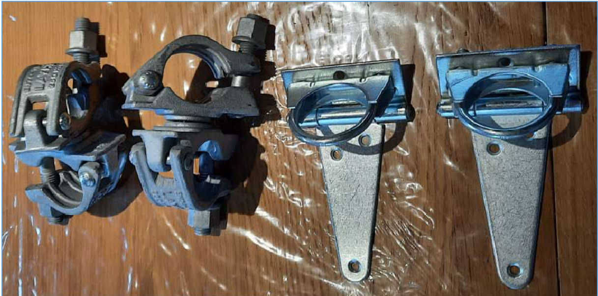
Fig. 11 : Système de fixation des jambes de forces au moyen de colliers doubles orientables et au moyen de pentures avec colliers « clamp » pour tube alu de 50 mm. Photo : ON4HNO.
