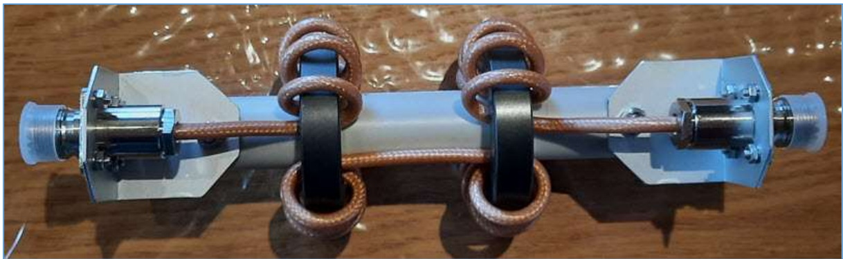
Fig. 65 : Common Mode Choke Unun avec deux tores ferrite FT240-31. Photo : ON4HNO.
