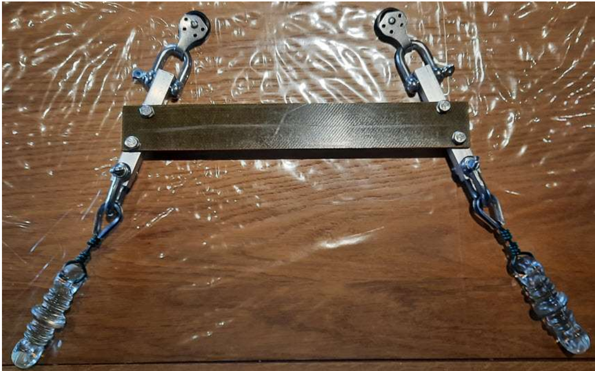
Fig. 20 : Assemblage de deux poulies maintenues à distance par une entretoise époxy et barreaux alu. Photo : ON4HNO.
