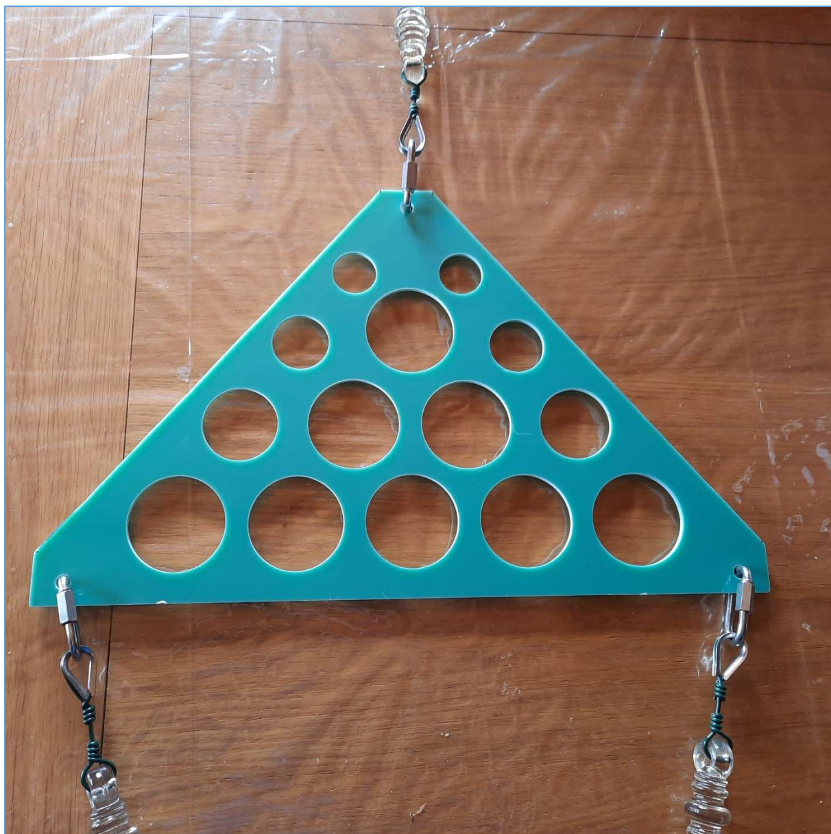
Fig. 22 : Triangle en époxy pour équilibrer les forces de traction des isolateurs. Photo : ON4HNO.
