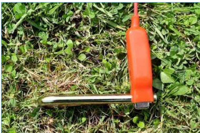
Fig. 36 : Raccordement du piquet d'injection de courant constant au telluromètre. Photo : ON4HNO.
