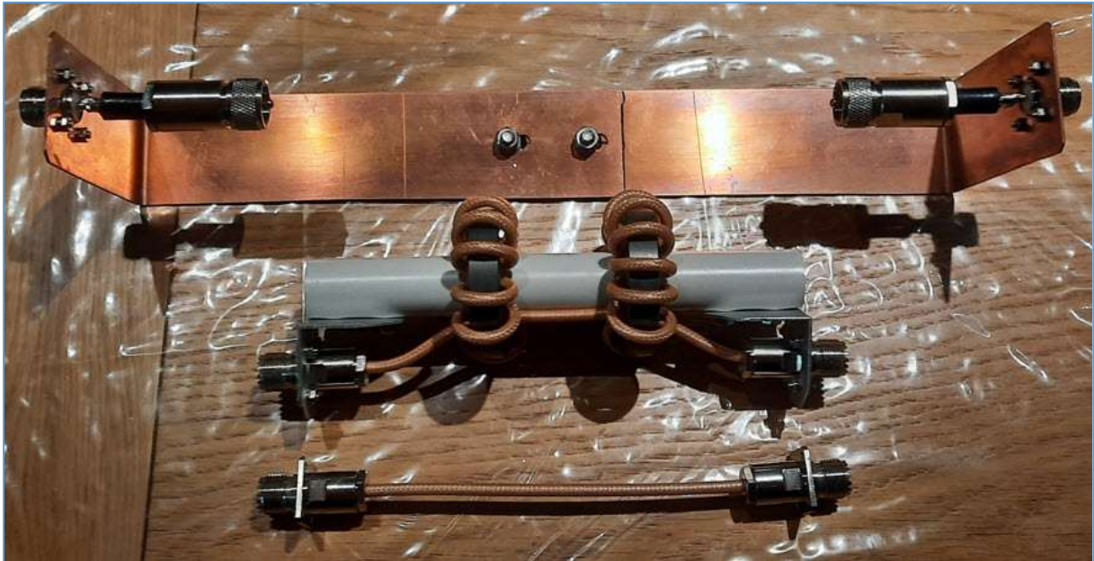
Fig. 67 : Set-up de mesures, Common Mode Choke Unun et segment de coax RG400 constituant un « Thru » de référence pour les mesures comparatives. Photo : ON4HNO.
