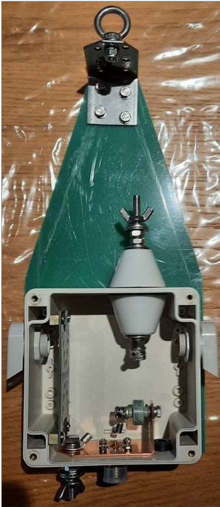
Fig. 55 : Montage du boîtier sur une plaque époxy avec anneau de suspension de l'ensemble. Photo : ON4HNO.
