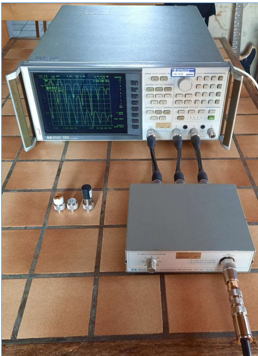
Fig. 85 : Set-up de mesures avec VNA et Reflection Test Set. Photo : ON4HNO.
