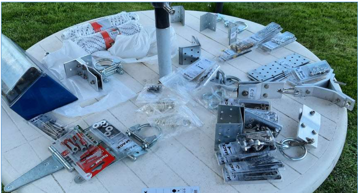
Fig. 12 : Approvisionnement de quelques pièces mécaniques, pattes en acier et équerres de fixation, accessoires divers et visseries inox en tous genres. Photo : ON4HNO.
