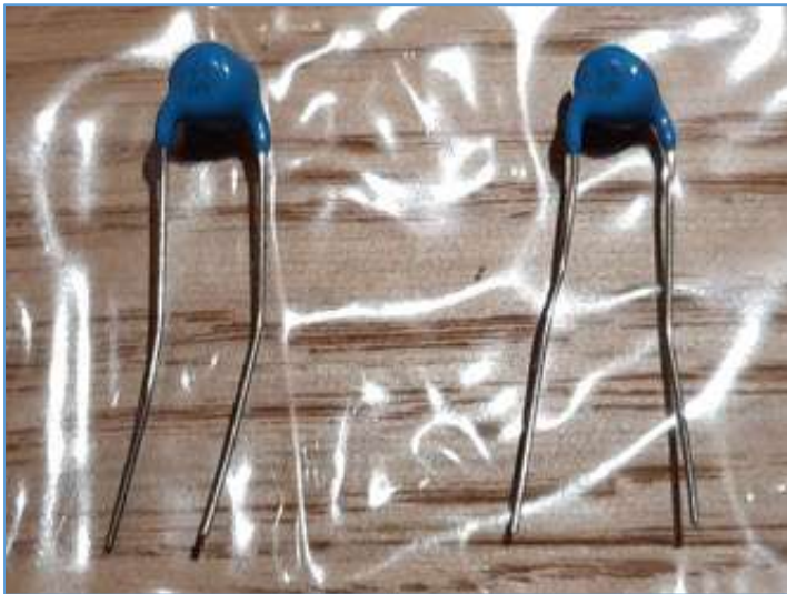
Fig. 45 : Exemple de condensateurs céramiques 100 pF 15 kV. Photo : ON4HNO.
