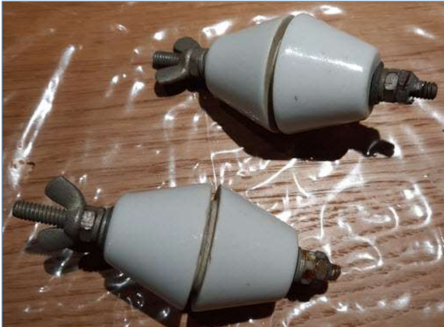
Fig. 24 : Isolateurs de traversée pour la sortie du Unun. Photo : ON4HNO.
