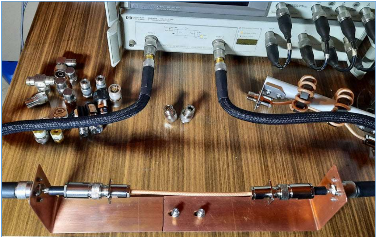
Fig. 68 : Mesures au VNA avec le Set-up de mesures et le segment de coax RG400 constituant un « Thru » de référence pour les mesures comparatives. Photo : ON4HNO.
