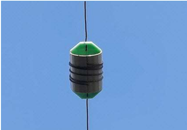
Fig. 82 : Vue de détail de la bobine de compensation. Photo : ON4HNO.
