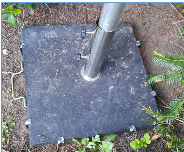
Fig. 15 : Pied de parasol pour la fixation de la base du mât. De grosses sardines empêchent le glissement de l'ensemble. Photo : ON4HNO.
