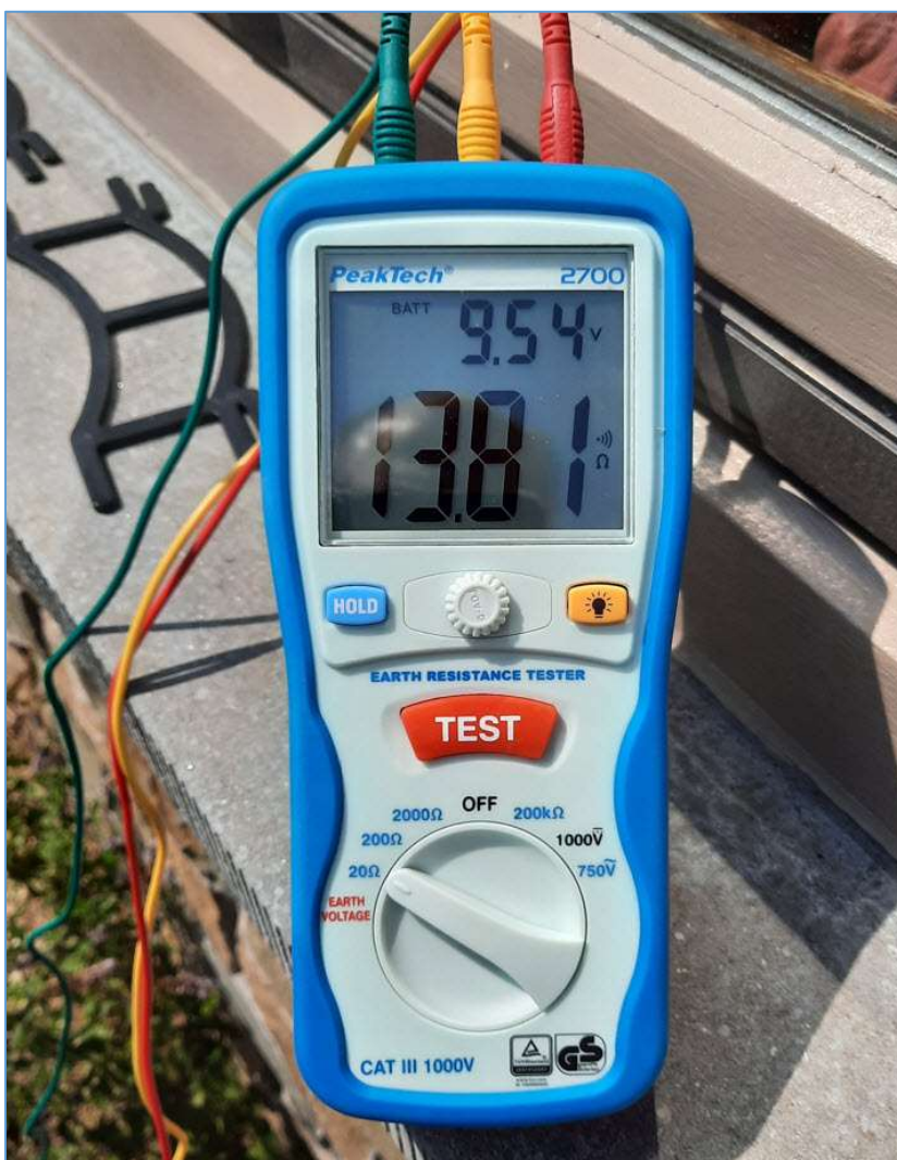
Fig. 37 : Mesure de la résistance de la prise de terre au telluromètre. Photo : ON4HNO.
