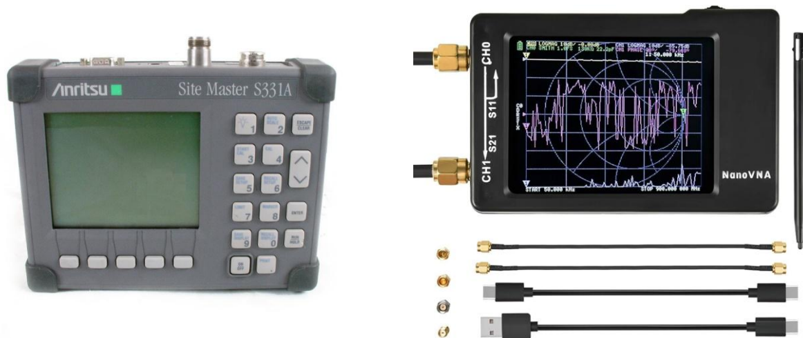
Fig.21 : CAT et VNA low cost. Source : Anritsu et Ali express.
