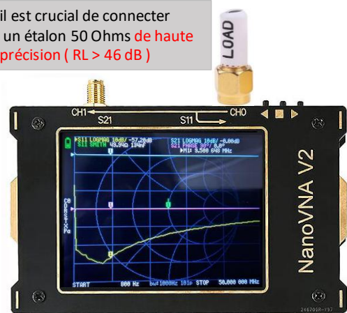
Fig. 1 : Procédure pour la mesure de la directivité d'un VNA ou analyseur antenne. Notons qu'il est possible d'effectuer la même procédure en remplaçant le « bouchon open » par le bouchon « short » en faisant la calibration « short – done » source : KJ4EGU
