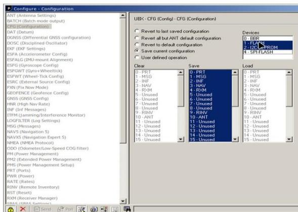
Maintenant que le GPS est programmé, le CH340 n'a maintenant plus d'utilité, il suffira d'alimenter le GPS en 5V et de le mettre à vue des satellites.
