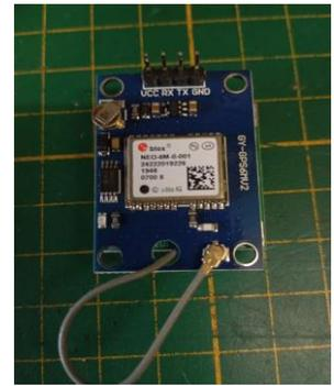
La connexion série entre le ch340 et le GPS est évidente (rx sur tx, tx sur rx, 5 v et masse) un fil sur la résistance qui allume la LED récupérera le signal (pin 3 du neo6-m) qui deviendra notre référence. Si l'on désire ajouter 2 piles AA (pour plusieurs années), le + sera soudé sur la languette supérieure (+) du micro accumulateur, le – à la masse.
