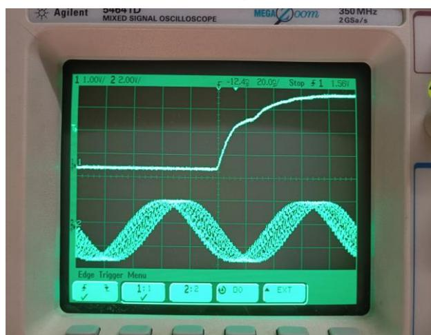
Le 1 kHz sera affiché et synchronisé sur le canal 1 de l'oscilloscope et le 10 MHz à tester sera affiché sur le canal 2.
