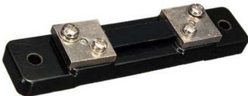
Fig. 7 : Shunt 50 A 75 mV (1,5 mΩ) avec connexions à quatre points.
