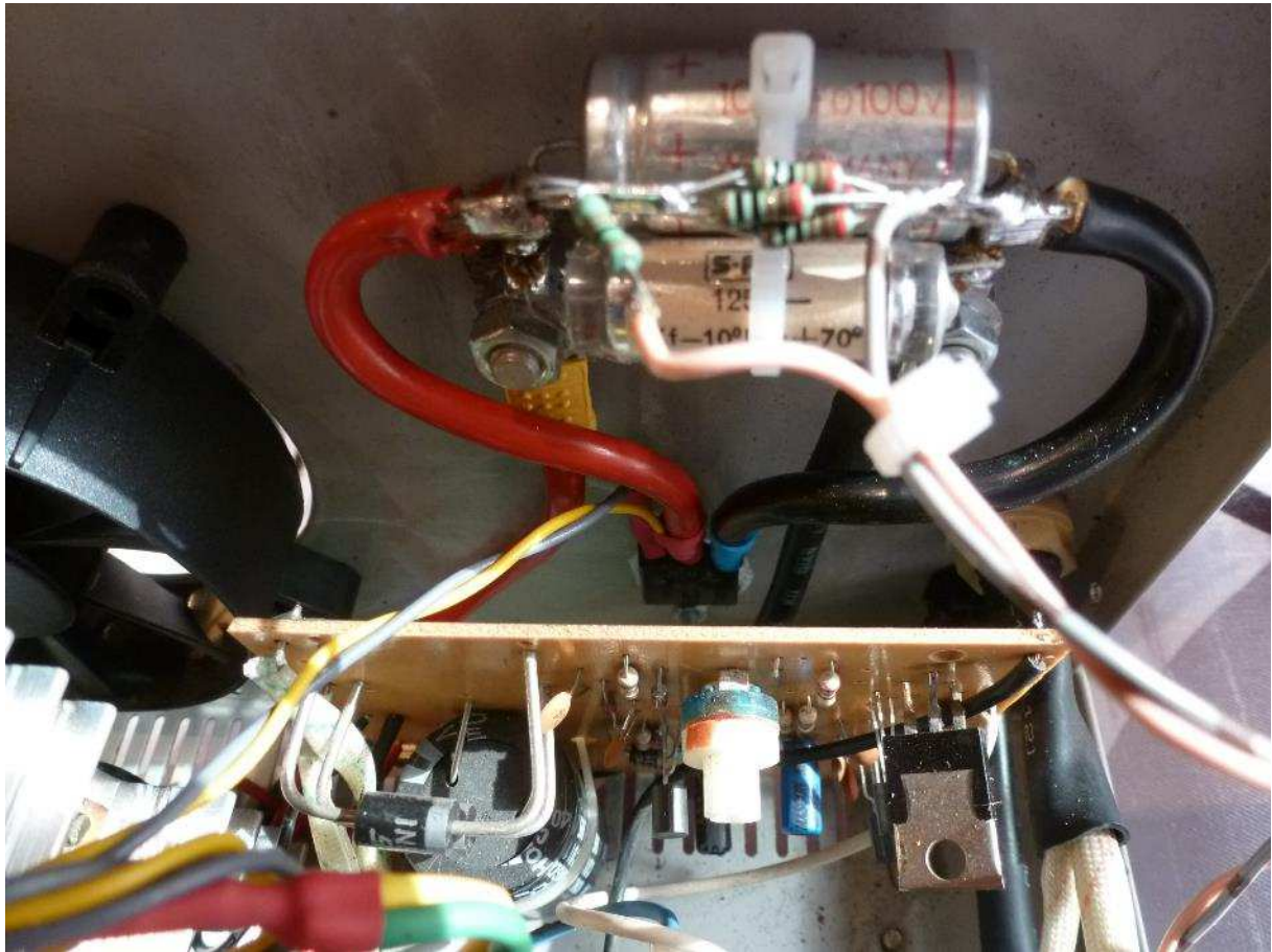
Fig. 17 : Vue de la carte électronique de régulation à l'avant-plan du cliché et des bornes de sortie de l'alimentation à l'arrière-plan. On observera les condensateurs de découplage placés sur les bornes de sortie, les quelques résistances de charge minimale permanente et une résistance pour le calibrage du courant dans la LED de signalisation présence tension. Le thyristor de puissance a été monté en dessous des bornes sur la tôle de la boîte métallique qui fait office de dissipateur.
