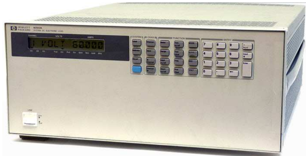
Fig. 18 : Charge électronique Hewlett Packard HP 5060A. (Source : Internet, Helmut Singer Elektronik, Feldchen, Aachen).
