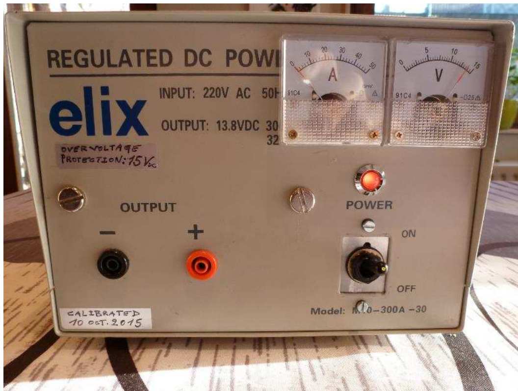
Fig. 13 : Vue de l'alimentation modifiée. L'interrupteur d'origine a dû être changé car il était défectueux par intermittence (défaut de contact). Une petite plaque en aluminium a été usinée pour servir d'interface mécanique avec la découpe d'origine.
