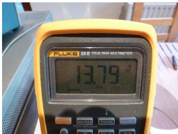
Fig. 25 : Lecture de la tension à vide sur un multimètre.
