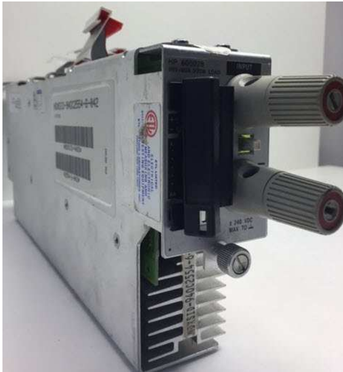
Fig. 19 : Module de charge électronique Hewlett Packard HP60502B : 60 V 60 A 300 W. (Source : Internet, Global Test Equipment).
