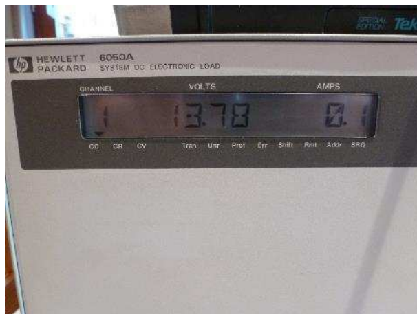
Fig. 26 : Lecture de la tension à vide sur l'indicateur de tension de la charge électronique.
