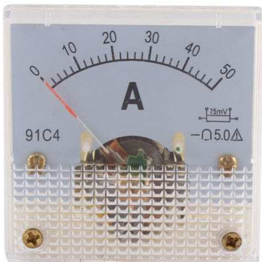
Fig. 6 : Galvanomètre ampèremètre nécessitant un shunt séparé de 50 A 75 mV.
