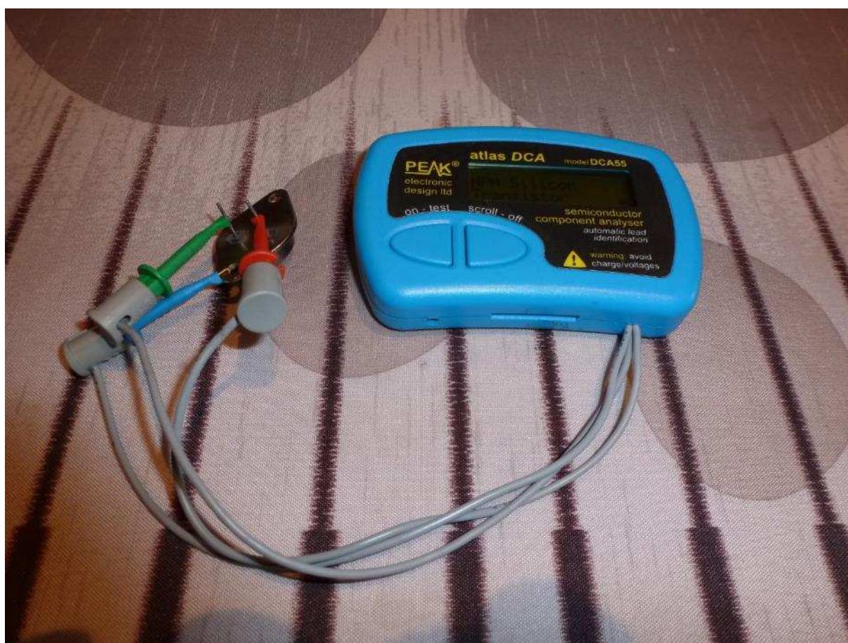
Fig. 3 : Test d'un transistor de puissance au moyen d'un appareil testeur de semi-conducteurs.
