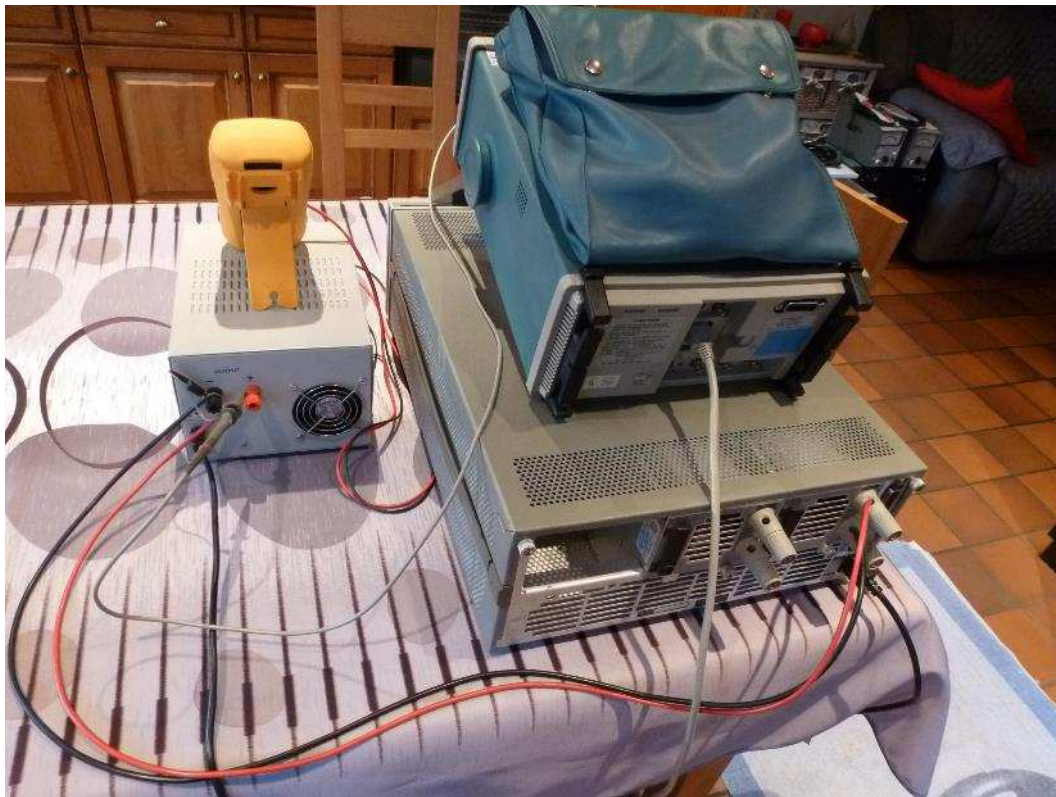
Fig. 23 : Vue du banc de test avec raccords entre l'alimentation et la charge électronique. La sonde de l'oscilloscope est raccordée aux bornes de sortie de l'alimentation.
