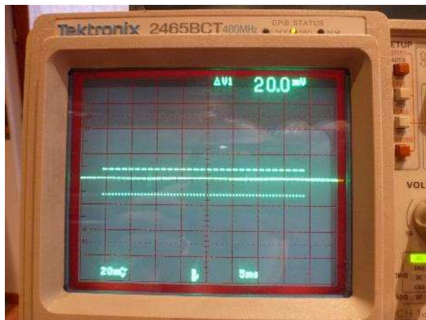
Fig. 28 : Mêmes conditions de mesure que ci-dessus mais avec l'alimentation éteinte (hors tension). Ce cliché a pour but d'illustrer le bruit de fond intrinsèque de l'oscilloscope ; le bruit de fond de l'oscilloscope est négligeable. Quand on veut mesurer des très petits signaux, il est recommandé d'utiliser un oscilloscope analogique qui est bien moins sensible au bruit que les oscilloscopes numériques aussi modernes soient-ils.
