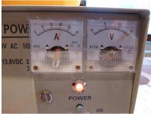
Fig. 29 : Alimentation en charge. Ici, la charge est maximale sur l'alimentation et la lecture du courant sur le galvanomètre ampèremètre avec shunt sur l'alimentation est de 30 A.
