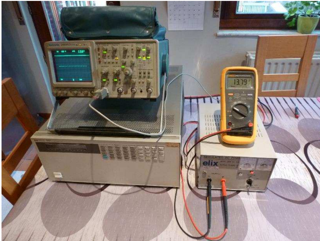
Fig. 22 : Vue du banc de test de l'alimentation avec charge électronique, multimètre et oscilloscope analogique.
