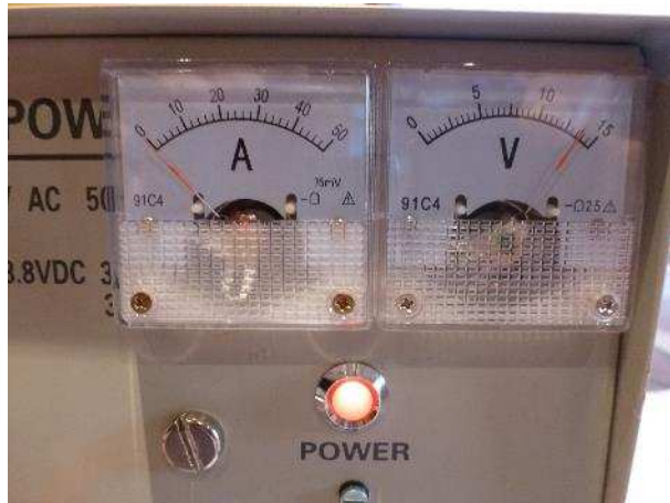
Fig. 24 : Mesure de la tension à vide sur le galvanomètre voltmètre de l'alimentation.
