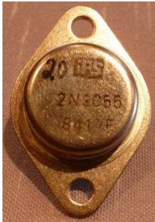
Fig. 4 : Transistor de puissance 2N3055, le gain en courant ( h_{FE} ) est noté sur le boîtier (ici : gain de 20).
