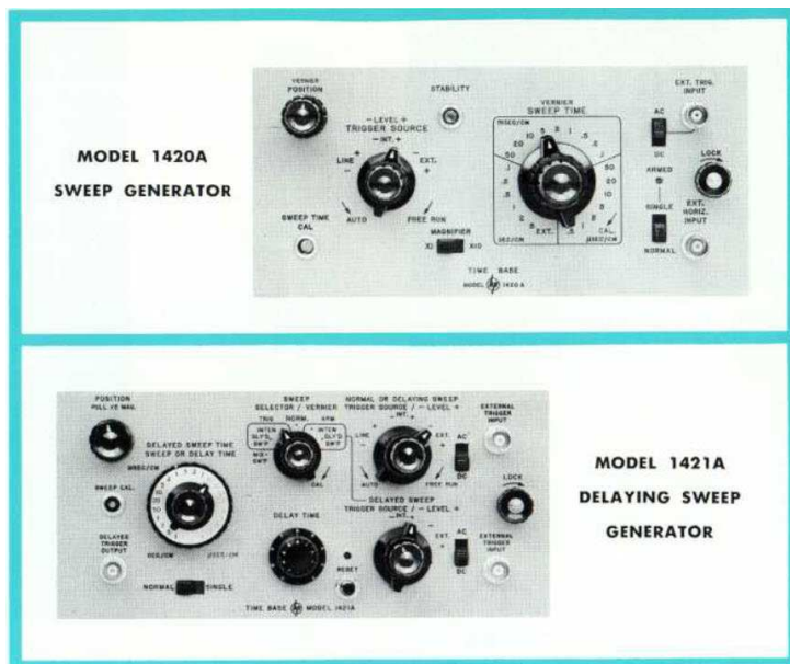
Fig. 8 : Modules de base de temps HP 1420A (simple base de temps) et HP 1421A (double base de temps). Source : HP.
