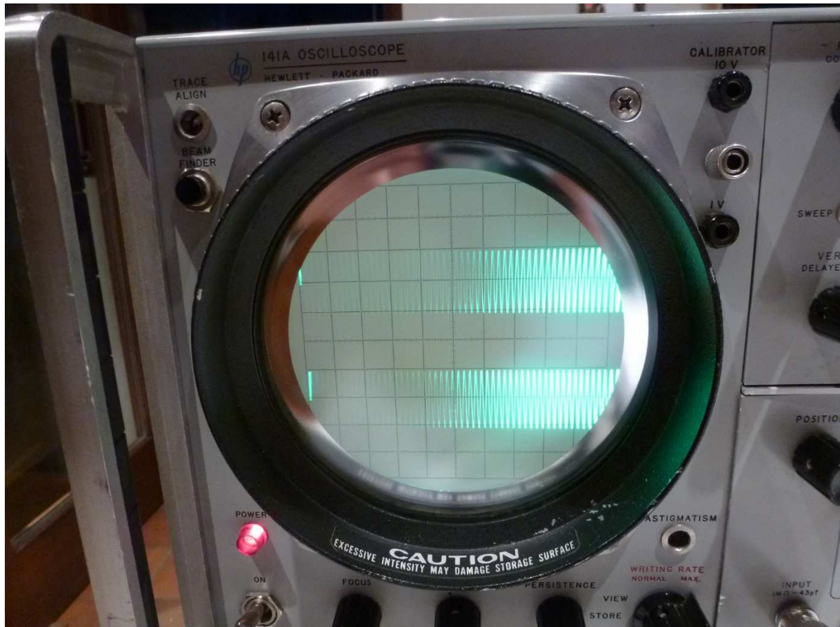
Fig. 23 : Activation de la double trace ; un signal sinusoïdal est appliqué aux deux entrées verticales de l'oscilloscope. Le cliché de la figure illustre les conditions d'augmentation de la persistance par rapport à celle montrée sur la figure précédente. Le calibre de la base de temps a été diminué par rapport au réglage effectué lors du cliché de la figure précédente.
