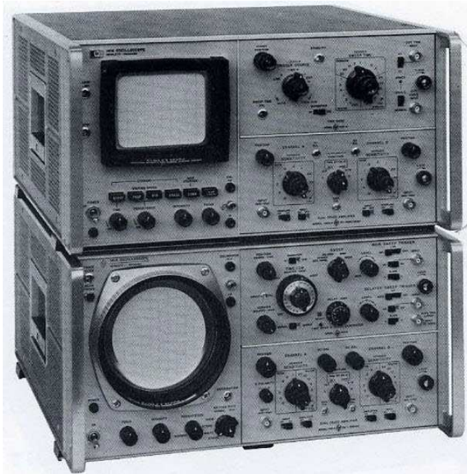
Fig 13 : Les deux versions du rack électronique de base pouvant accueillir la même gamme de modules.
