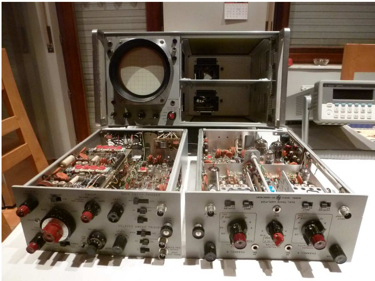
Fig. 5 : Mainframe (rack électronique de base) et plug-in (modules enfichables). Association de multiples technologies avec tubes radio 5642 6DJ8 8233 6AU6 6BL8 5651 ZZ1000, nuvistors 6CW4 (triode miniature à fort \mu , forte pente), transistors au germanium et au silicium.
