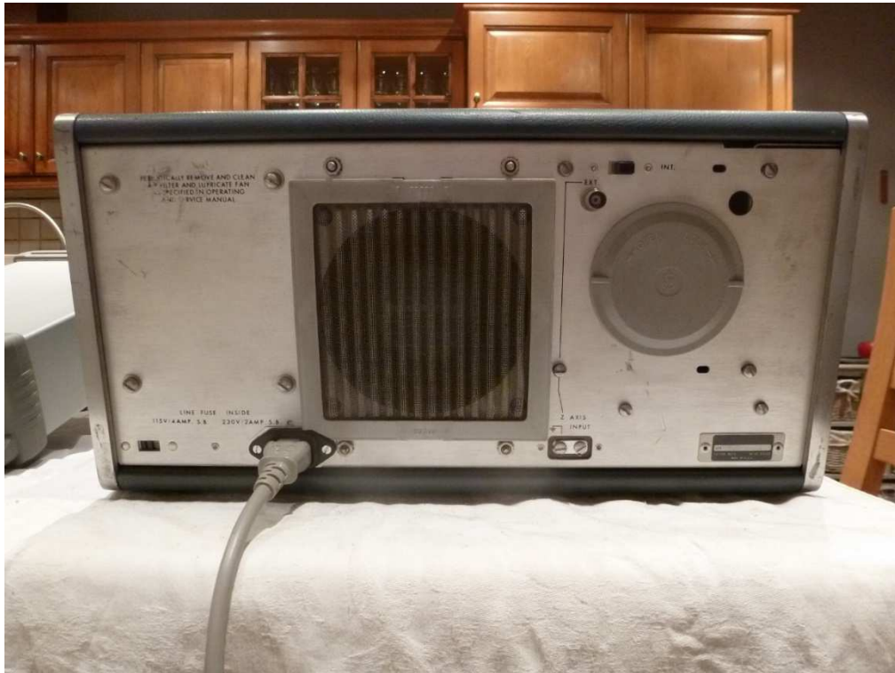
Fig. 2 : HP 141A, vue arrière ; le connecteur châssis pour le raccordement secteur a été remplacé par un modèle actuel pour accueillir les cordons secteurs standards aux normes internationales (IEC).
