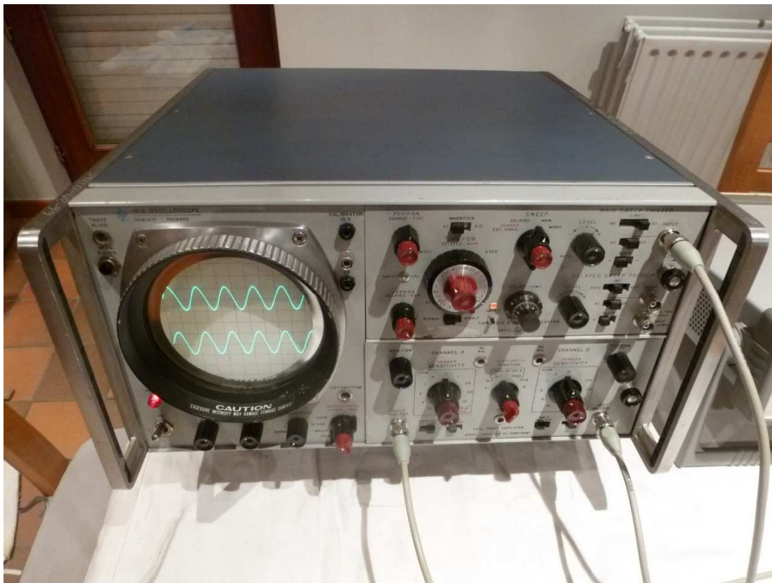
Fig. 1 : Oscilloscope HP 141A à mémoire phosphorescente et à persistance variable configuré ici avec un tiroir HP 1402A amplificateur vertical double trace et un tiroir HP 1421A double base de temps.
