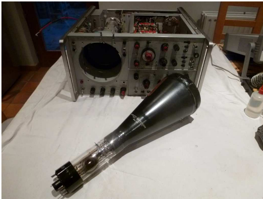
Fig. 17 : Vue de l'appareil avec dépose du tube cathodique (opération délicate) pour un nettoyage complet.
