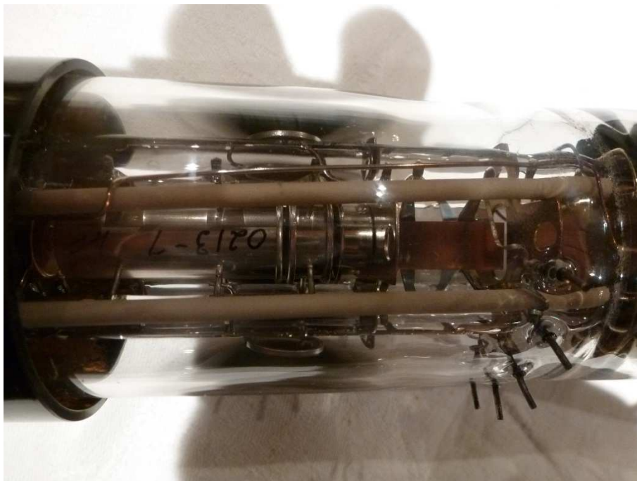
Fig. 18 : Détail du col du tube cathodique où l'on peut observer le montage des électrodes constituant le canon à électrons.
