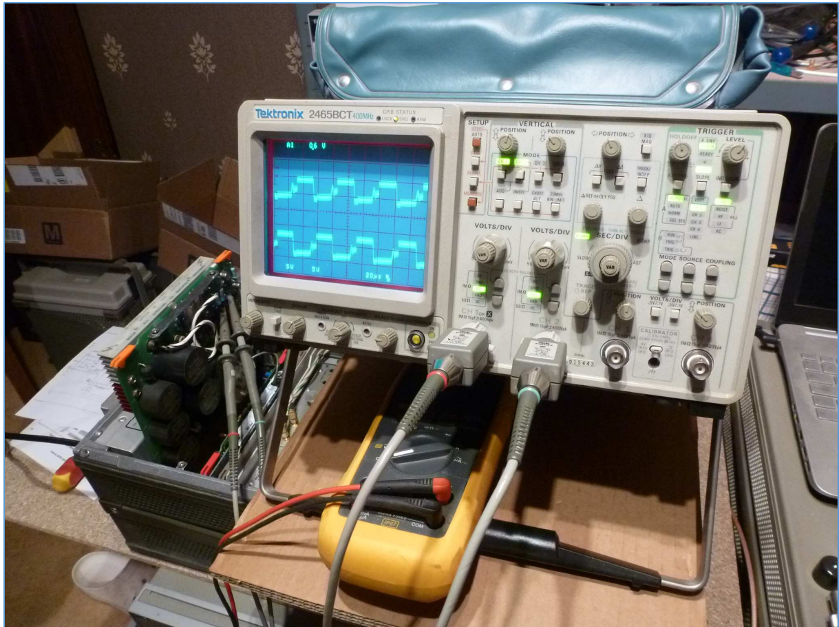
Fig. 19 : Oscilloscope TEK 2465BCT remis en service après dépannage. Le signal mesuré comporte une composante HF superposé au signal carré ; ne venez pas croire que la trace est floue sur le tube de l'oscilloscope. La mesure est effectuée sur une alimentation à découpage d'un générateur radiofréquence HP 8662A. Photo : ON4IJ.
