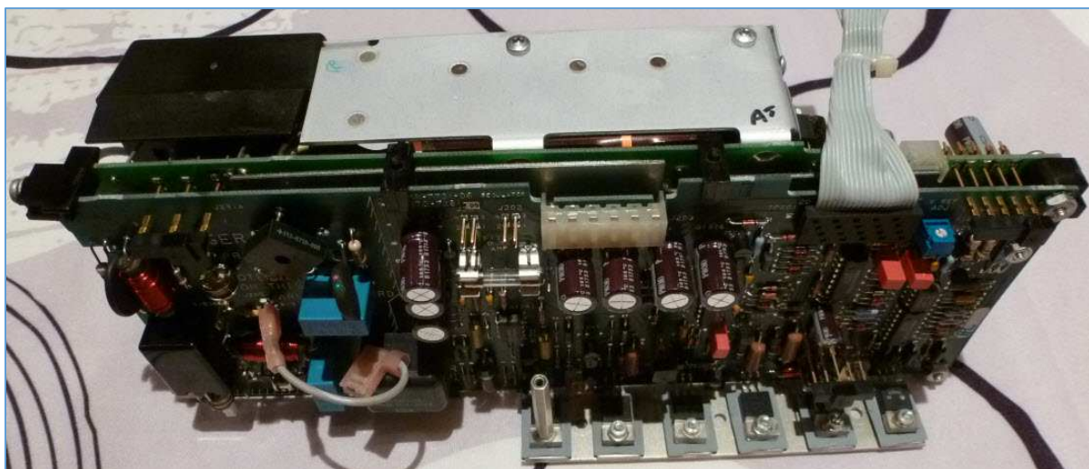
Fig. 13 : Assemblage des deux cartes électroniques du bloc d'alimentation (vu côté A2A1). Photo : ON4IJ.
