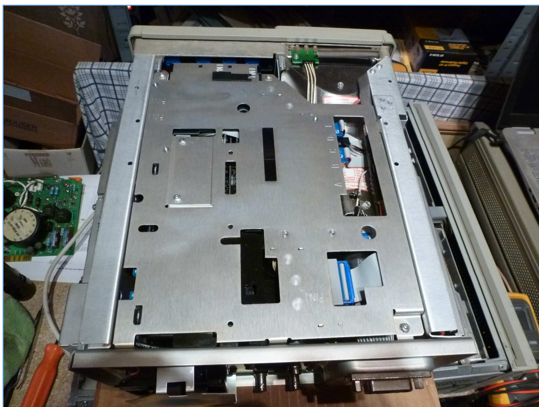
Fig. 18 : Châssis électronique supérieur repositionné dans la partie supérieure de l'oscilloscope. Des peignes de connexions viennent s'enficher sur le bloc d'alimentation. L'opération de repositionnement est particulièrement délicate à effectuer ; patience et dextérité sont de mise. Photo : ON4IJ.
