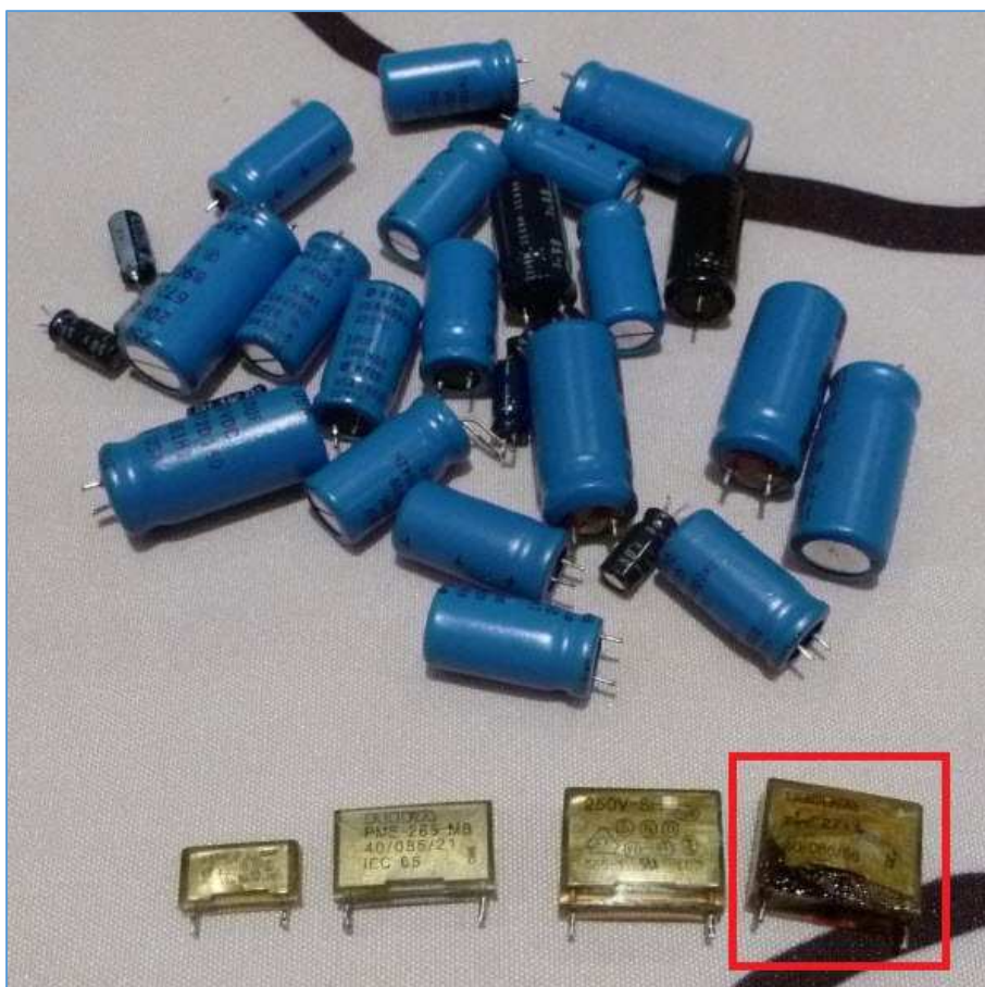
Fig. 9 : Composants électroniques vieillis ayant été remplacés. En bas à droite, le condensateur défectueux. Photo : ON4IJ.
