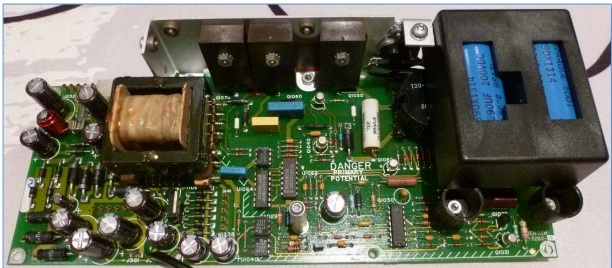
Fig. 11 : Carte électronique A2A3 après remplacement des composants (comparer avec figure 6). Photo : ON4IJ.
