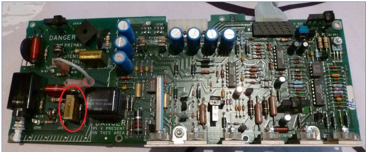
Fig. 2 : Carte électronique A2A1 ( Regulator Board ) d'un oscilloscope TEK 2465BCT. En bas à gauche de la carte (entouré en rouge), un condensateur film étant défectueux et ayant dégagé un nuage de fumée. Photo : ON4IJ.
