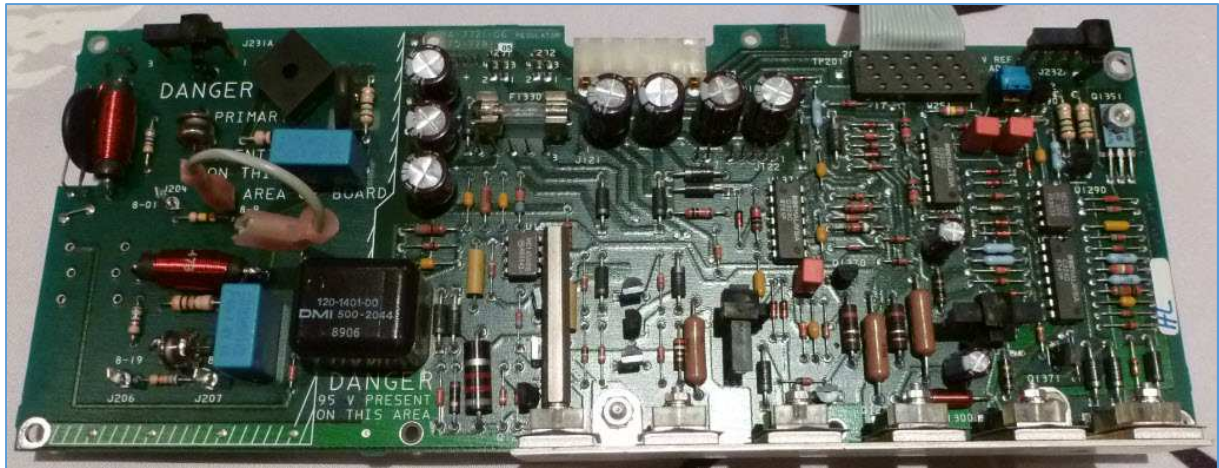
Fig. 10 : Carte électronique A2A1 après remplacement des composants (comparer avec figure 2). Photo : ON4IJ.
