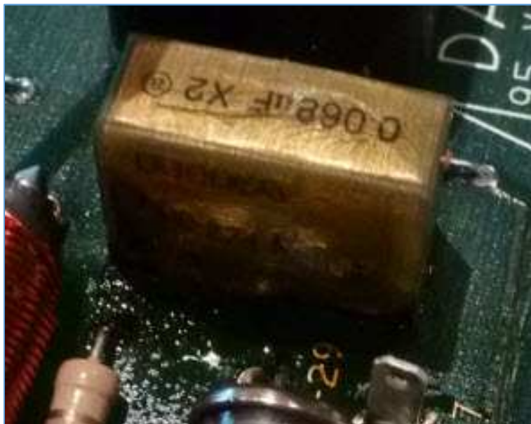
Fig. 3 : Condensateur défectueux du type film. On peut observer des macro-fissures sur le revêtement en époxy transparent du composant. La face latérale à l'avant du condensateur est complètement déformée par l'amorce d'un arc électrique entre électrodes. Des vapeurs d'agents chimiques et plastiques se sont condensés à la surface du circuit imprimé. Photo : ON4IJ.
