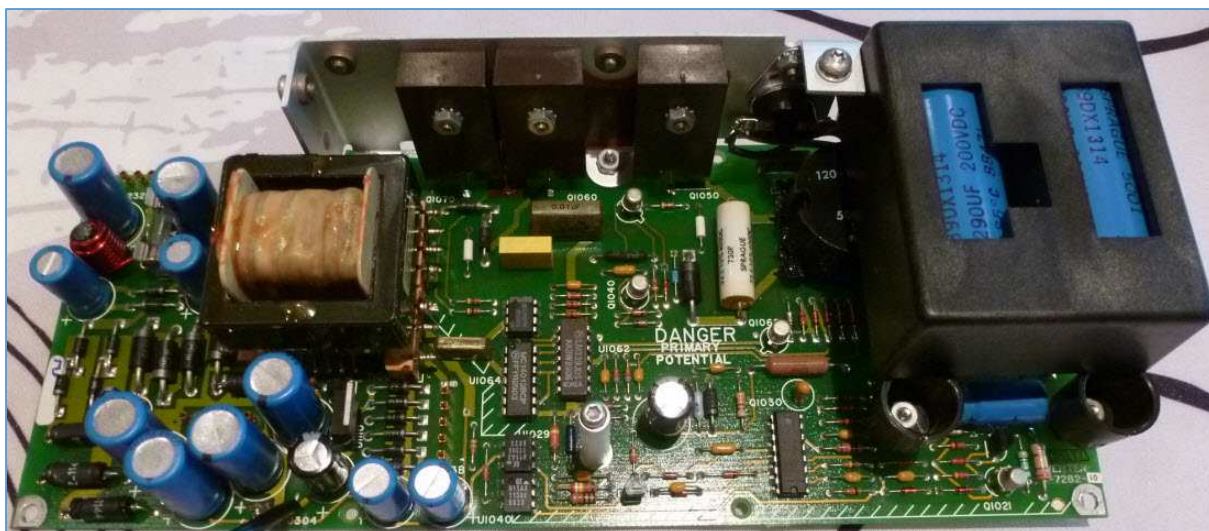
Fig. 6 : Carte électronique A2A3 « Inverter » d'un oscilloscope TEK 2465BCT. Quelques condensateurs du type film à revêtement époxy transparent ont été repérés. Cette carte électronique est équipée de plusieurs condensateurs électrolytique pouvant être potentiellement vieillis. Photo : ON4IJ.
