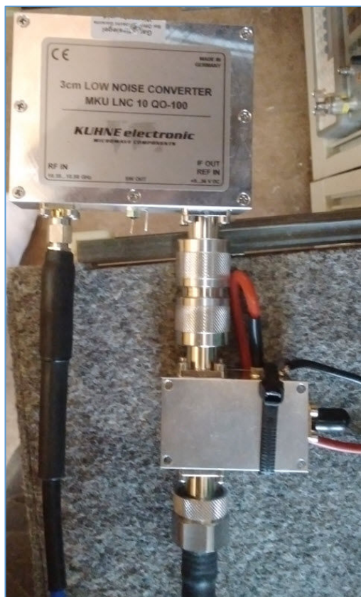
Fig. 2 : Convertisseur de la bande X des 3 cm MKU LNC 10 QO-100 Kuhne Electronic. Sur la gauche, l'entrée SHF 10,300 GHz sur un connecteur SMA avec un câble de mesure reliant l'entrée du LNC à la sortie du générateur Tracking HP 85645A paramétré à un niveau de -45 dBm. Sur la droite, la sortie IF du LNC à 1 060 MHz sur un connecteur type N. L'alimentation du LNC s'effectue par la ligne de transmission coaxiale du signal IF et par l'intermédiaire d'un injecteur DC ( Bias Tee ) que l'on peut observer en bas à droite de la figure. Le niveau de sortie du signal IF, en tenant compte des pertes d'insertion du Bias Tee et du câble de mesure qui y est raccordé est de l'ordre de -1 dBm. Ce niveau constitue un maximum qui ne doit pas être dépassé car il se situe juste avant le point de saturation de la sortie du convertisseur.
