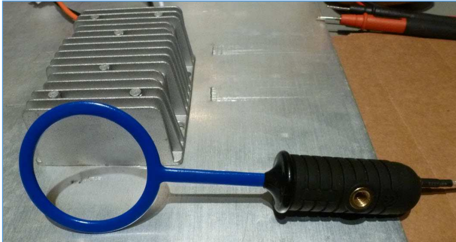
Fig. 13 : Placement d'une boucle inductive le long du flanc du booster pour le relevé en champ proche du rayonnement électromagnétique. Photo : ON4IJ.
