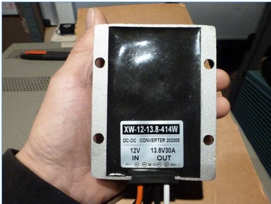
Fig. 1 : Booster de tension sous test. Tension d'entrée 12 V ; tension de sortie 13,8 V ; courant maximal admissible 30 A. Photo : ON4IJ.
