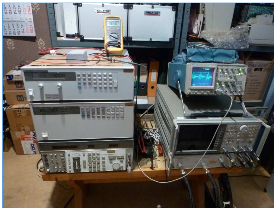
Fig. 2 : Setup de mesure pour l'évaluation d'un booster de tension avec une alimentation DC de labo, une charge active, un multimètre de précision et un oscilloscope analogique. Photo : ON4IJ.
