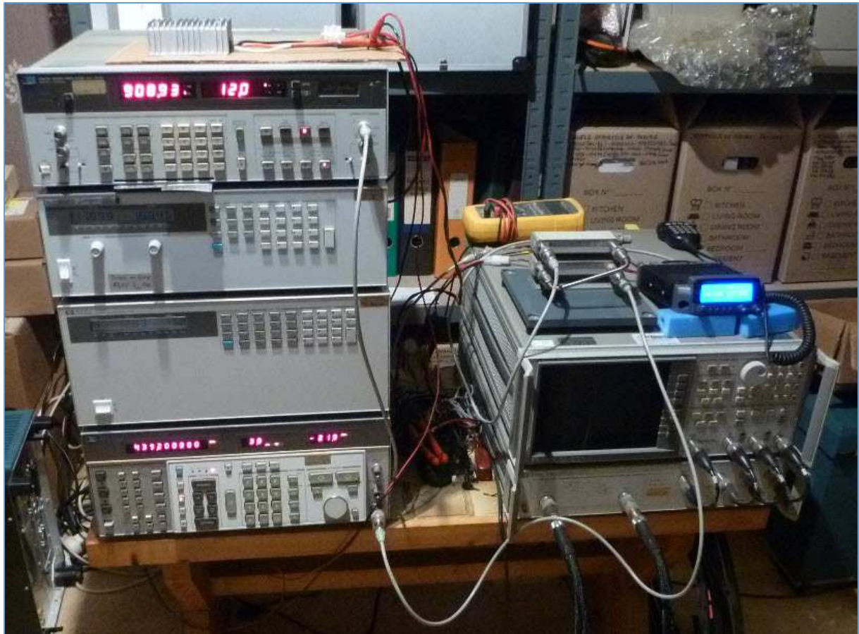
Fig. 15 : Setup de mesure pour le relevé de la sensibilité d'un transceiver sous test avec et sans booster de tension. À gauche de bas en haut : générateur HF HP 8662A avec modulateur FM interne calibré (voir fonctions de Bessel) ; charge active HP 6050A avec 2 tiroirs de charge HP 60504B (60 V ; 120 A ; Load Max. 600 W) ; Alimentation de labo HP 6552A (0-20 V ; 0-25 A) ; Analyseur audio avec fonction SINAD-mètre HP 8903A ; booster de tension. À droite de bas en haut : analyseur de réseau vectoriel pour des travaux de réglage de filtres et de duplexeurs pour des répéteurs radioamateurs ; atténuateur par pas de 10 dB HP 8496B ; atténuateur par pas de 1 dB HP 8494B ; multimètre Fluke 28. En haut à droite, le transceiver sous test Kenwood TM-V7. Photo : ON4IJ.
