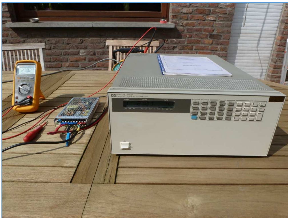
Fig. 7 : Banc de test de l'alimentation en charge au moyen d'une charge électronique HP 6050A.
