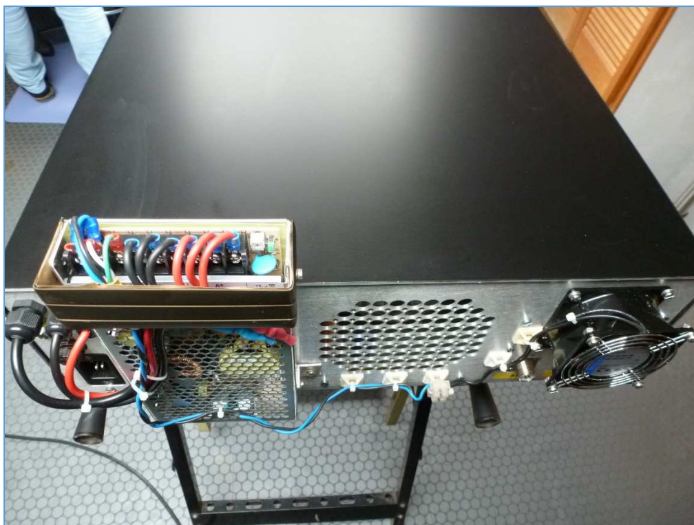
Fig. 13 : Vue de l'arrière du linéaire avec intégration d'une alimentation régulée de la tension filament.
