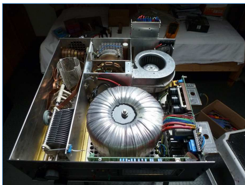
Fig. 10 : Vue d'ensemble du linéaire : circuit de sortie, transfo, alimentation, tube, turbine, etc.
