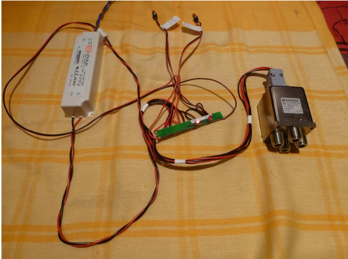
Fig. 7 : Setup de test du relais coaxial transfer switch , modèle TN6V24 Ducommun. Le basculement sur la 1 ère et 2 ème position s'effectue par impulsion au moyen de deux boutons poussoirs distincts. Le contact Indicator est raccordé sur deux LEDs distinctes.
