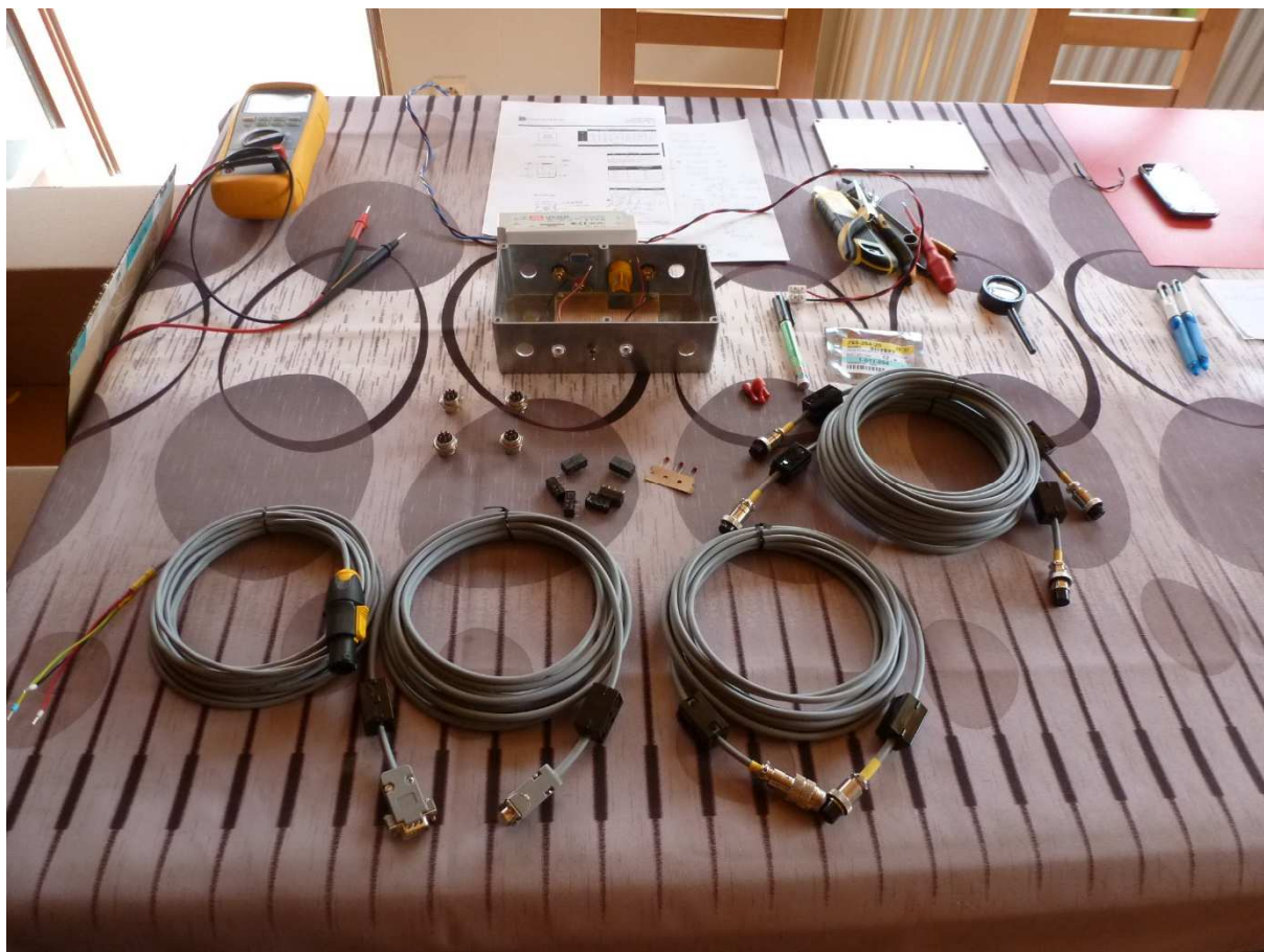
Fig. 32 : Fabrication des câbles blindés pour les différentes liaisons entre les appareils de l'installation.
