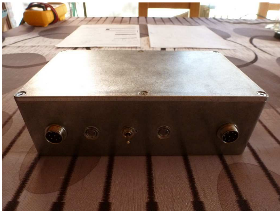
Fig. 34 : Vue de la face avant du boîtier de commande S02R.
