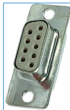
Fig. 25 : Connecteur DB-9
