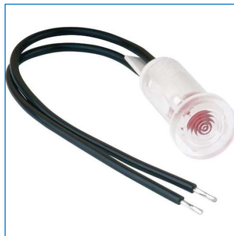
Fig. 18 : Témoin LED à résistance intégrée directement prévu pour être alimenté en 24 Vdc.
