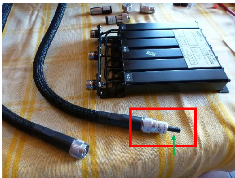
Fig. 27: Raccordement d'un calibre de circuit ouvert à l'extrémité du câble raccordé au 2 ème port de mesure de l'analyseur de réseau vectoriel.
