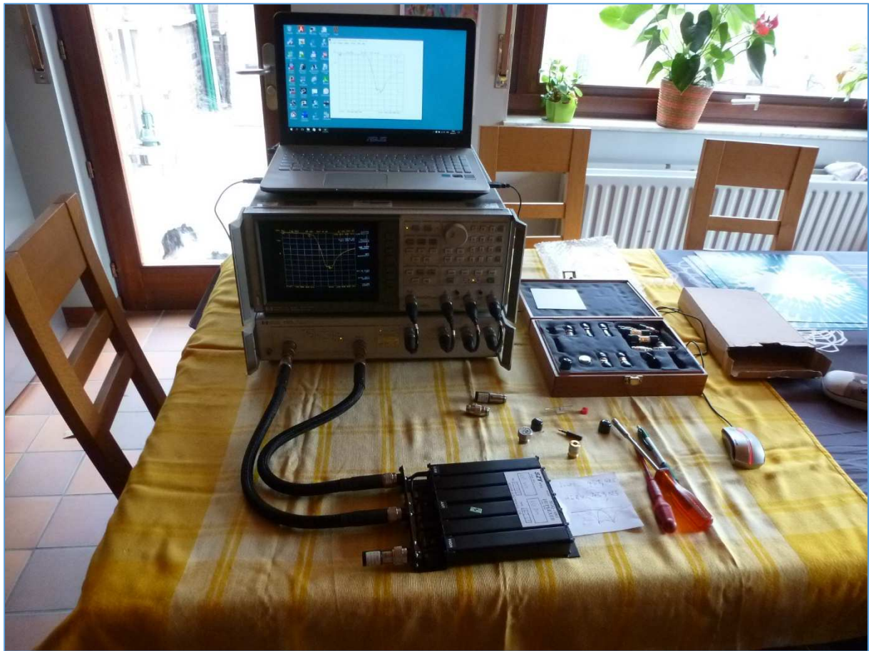
Fig. 23: Duplexeur sous test sur un analyseur de réseau vectoriel. Sur cette figure, on peut observer le raccordement du 1 er port de mesure de l'analyseur sur le port « antenne » du duplexeur et le raccordement du 2 ème port de mesure de l'analyseur sur le port « Low » du duplexeur. Une charge fictive étalon est placée sur le port « High » du duplexeur. L'analyseur vectoriel a été préalablement calibré sur la plage de fréquences de mesure avec des calibres de court-circuit, circuit ouvert, charge étalon et connecteur « I » de traversée coaxiale (correction « SOLT » : Short, Open, Load, Throught ).
