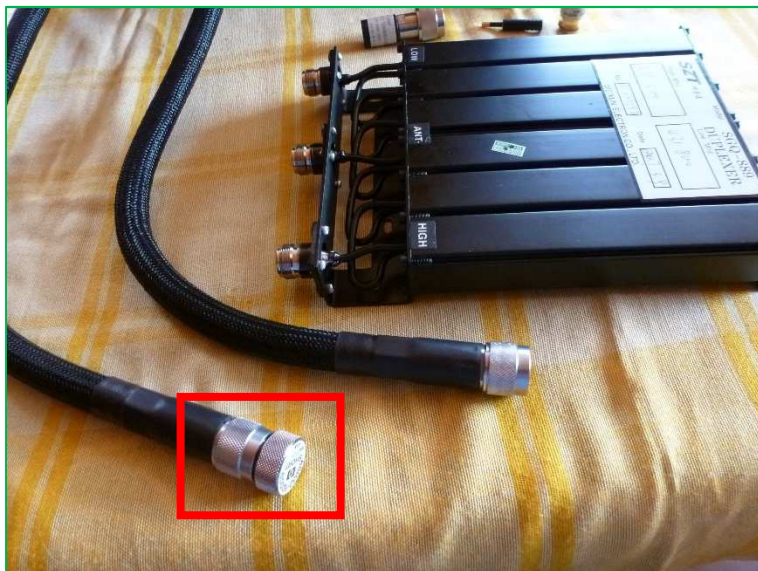
Fig. 25: Raccordement d'un calibre de court-circuit à l'extrémité du câble raccordé au 1 er port de mesure de l'analyseur de réseau vectoriel.
