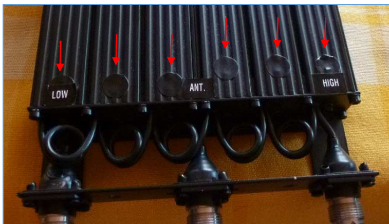
Fig. 44 : Vue de détail sur les réglages de compensation de couplage des cavités en cascade d'un duplexeur. Les accès aux réglages sont protégés par des obturateurs ; ceux-ci sont indiqués par des flèches sur cette figure.
