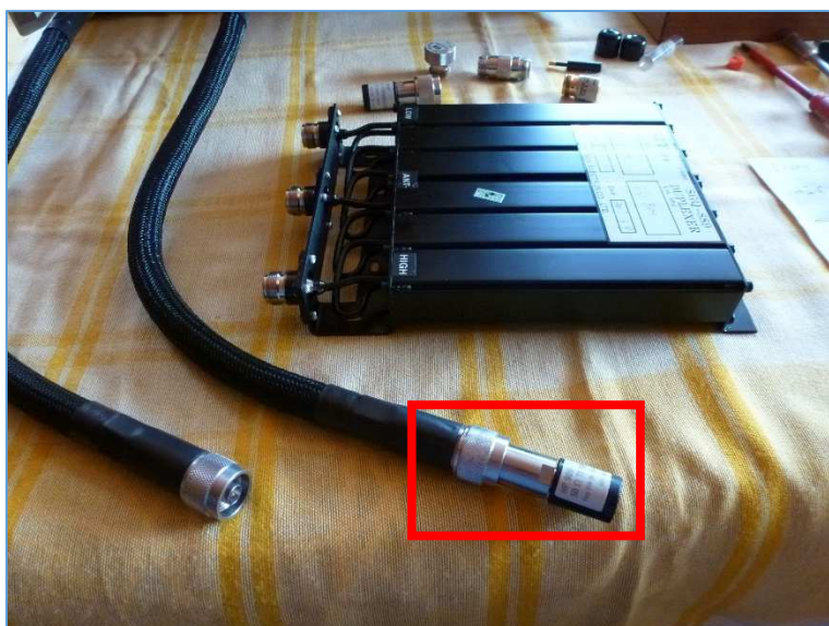
Fig. 29: Raccordement d'une charge fictive étalon à l'extrémité du câble raccordé au 2 ème port de mesure de l'analyseur de réseau vectoriel.
