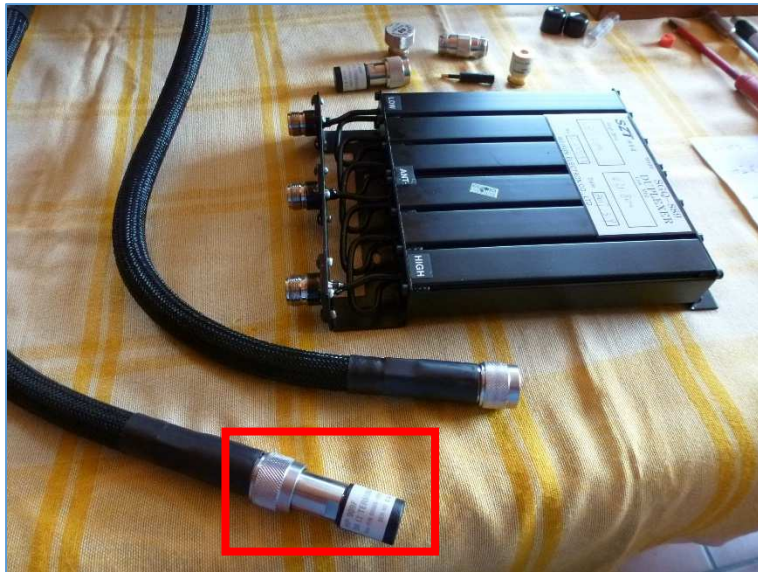
Fig. 26: Raccordement d'une charge fictive étalon à l'extrémité du câble raccordé au 1 er port de mesure de l'analyseur de réseau vectoriel.
