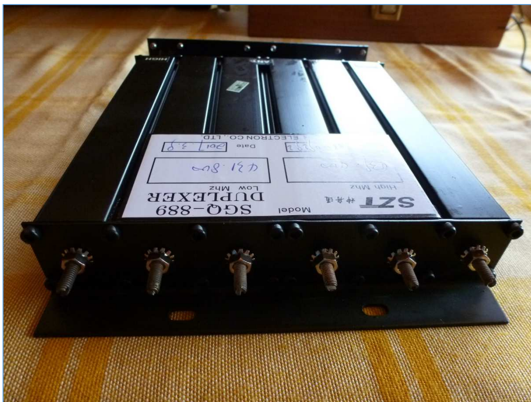
Fig. 16 : Duplexeur UHF à 6 cavités du répéteur ON0RCA. Vue sur les tiges filetées permettant le réglage d'accord en fréquence.
