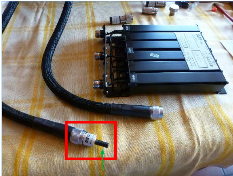
Fig. 24: Raccordement d'un calibre de circuit ouvert à l'extrémité du câble raccordé au 1 er port de mesure de l'analyseur de réseau vectoriel. On remarquera l'insert d'une pin centrale du calibre type N femelle sur le connecteur mâle du câble afin d'éviter toute rupture d'impédance caractéristique au niveau du calibre qui serait due au changement du diamètre d'une pin mâle par rapport au diamètre extérieur d'une pin femelle de ce type de connecteur coaxial. Hé oui, on pousse le détail jusque là-bas !
