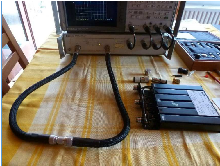
Fig. 30: Raccordement des deux ports de mesure entre eux par l'intermédiaire d'un connecteur « I » de traversée afin de normaliser la mesure du coefficient de transmission entre le 1 er port et le 2 ème port de mesure (transmission dans le sens direct), mais aussi entre le 2 ème et le 1 er port de mesure (transmission dans le sens inverse). Quatre étapes de calibrage sont effectuées : la transmission directe, la transmission inverse, l'adaptation dans les sens direct et l'adaptation dans le sens inverse.
