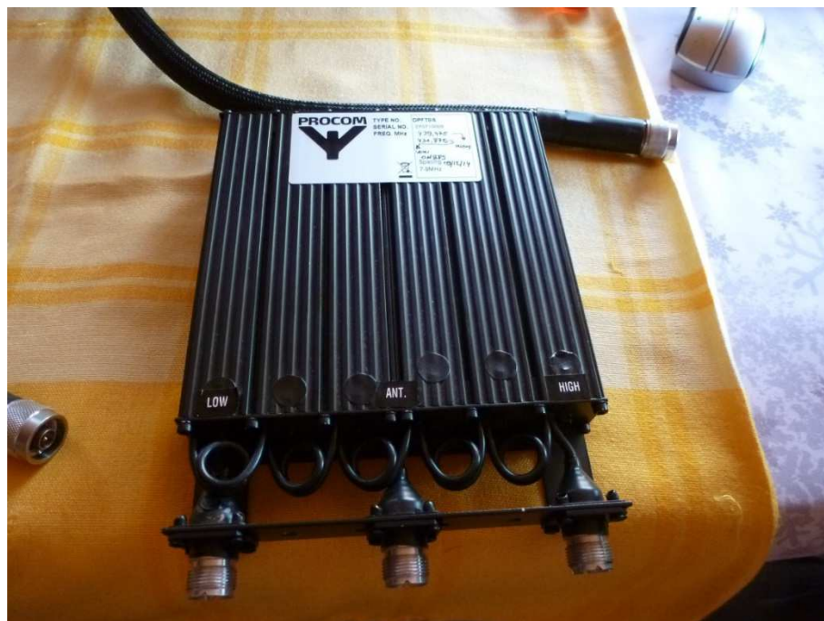
Fig. 38: Duplexeur UHF à 6 cavités du type éliminateur de bande équipant le répéteur ON0LG.
