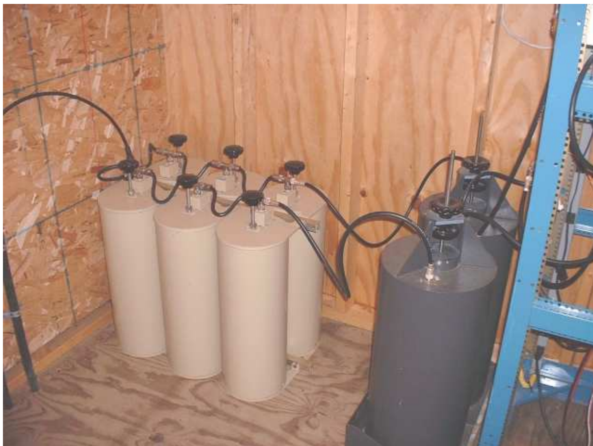
Fig. 6 : Groupe de cavités en cascade d'un répéteur radioamateur. Source : Repeater N1BUG, Stickney Hill, Brownville, Comté de Piscataquis, état du Maine aux USA. Sur la partie de droite de cette photo, on peut observer deux cavités passe-bande. Lors des essais de ce répéteur, ces deux cavités ont été supprimées car elles n'apportaient aucune amélioration sur les performances du relais.
