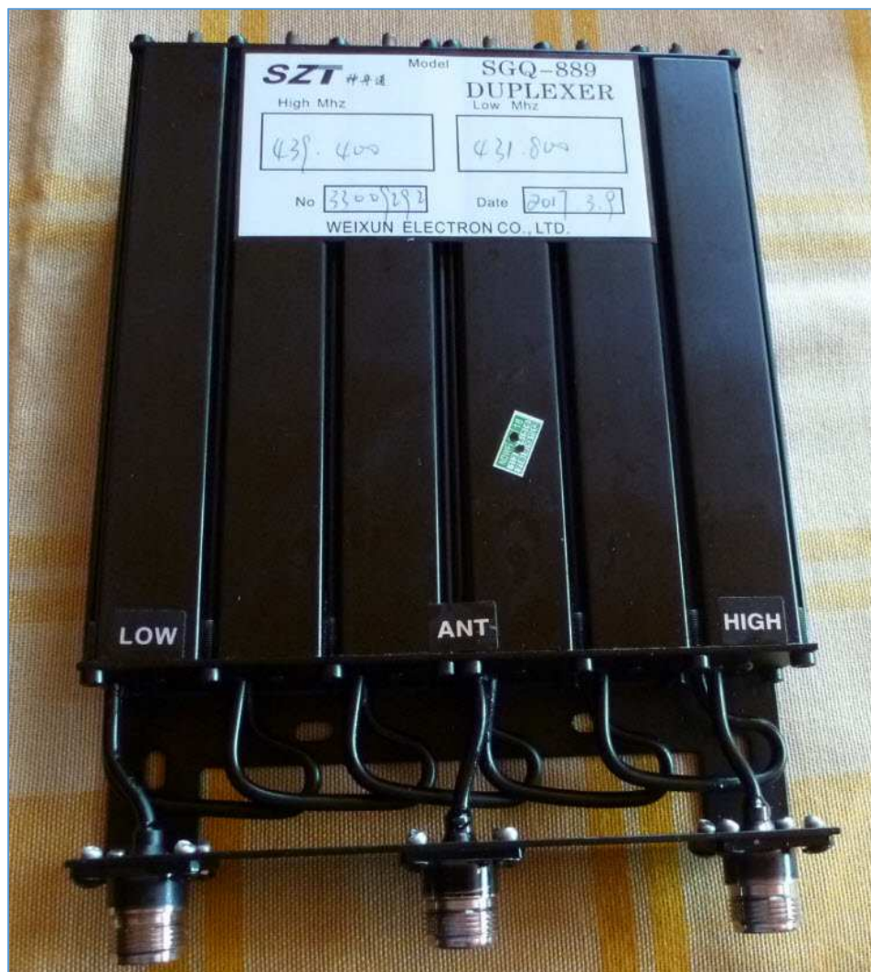
Fig. 15 : Duplexeur UHF à 6 cavités du type éliminateur de bande équipant le répéteur ON0RCA.
