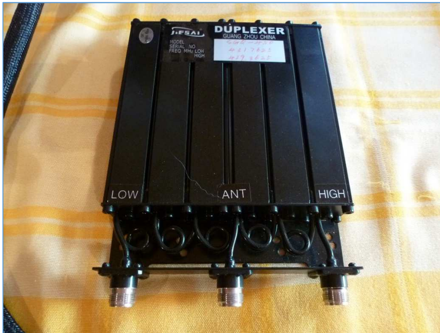
Fig. 45 : Duplexeur servant de « pièce martyre » pour vous montrer, pas à pas, la procédure de réglage.
