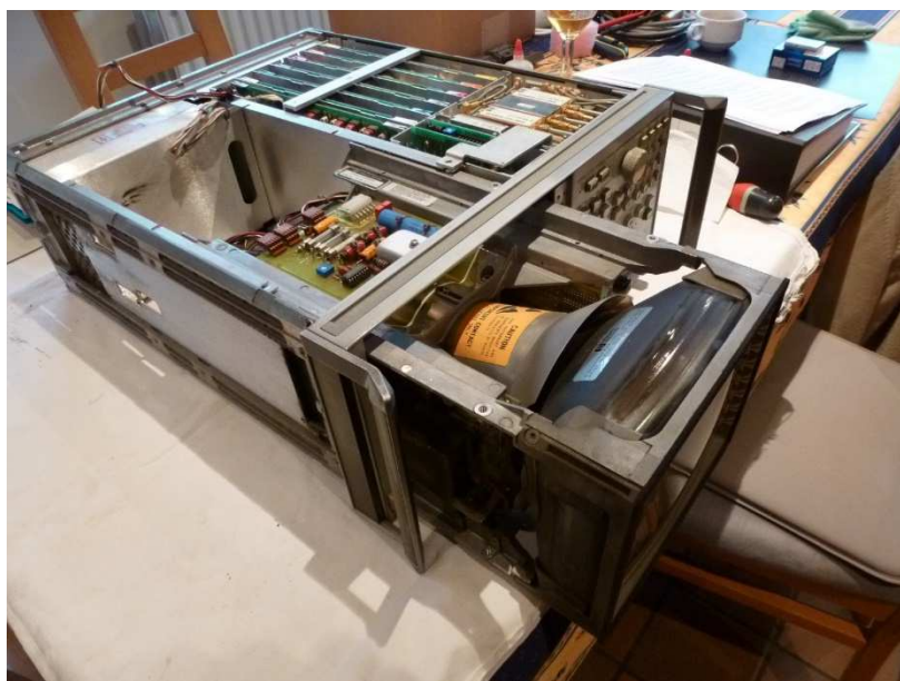
Fig. 31 : Vue avant du moniteur en cours d'extraction.
