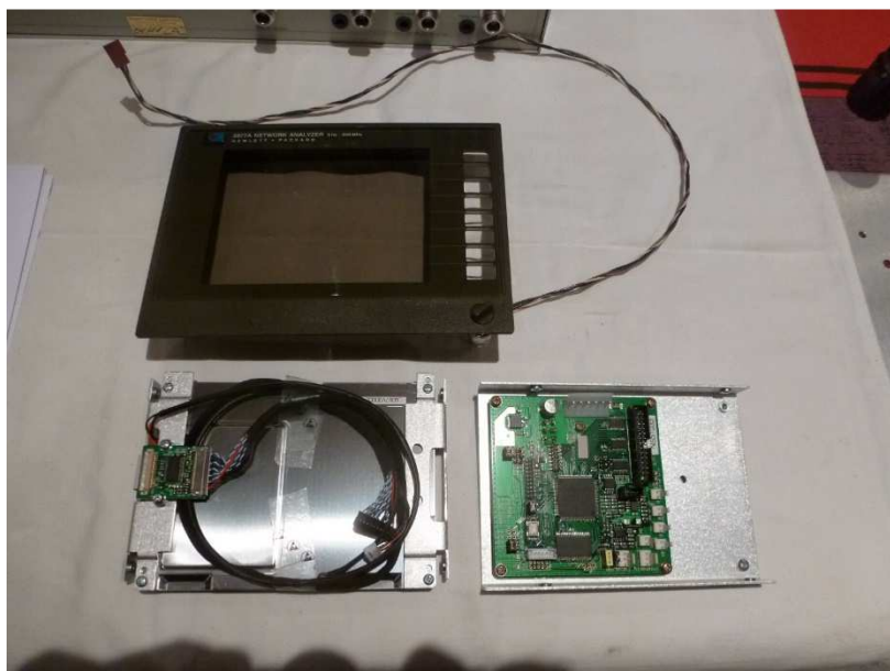
Fig. 6 : Fenêtre de protection frontale du moniteur d'origine ; celle-ci sera remplacée ultérieurement. On peut observer à l'avant plan le LCD couleur et son interface électronique tous deux sur cadres de montage livrés avec le kit.
