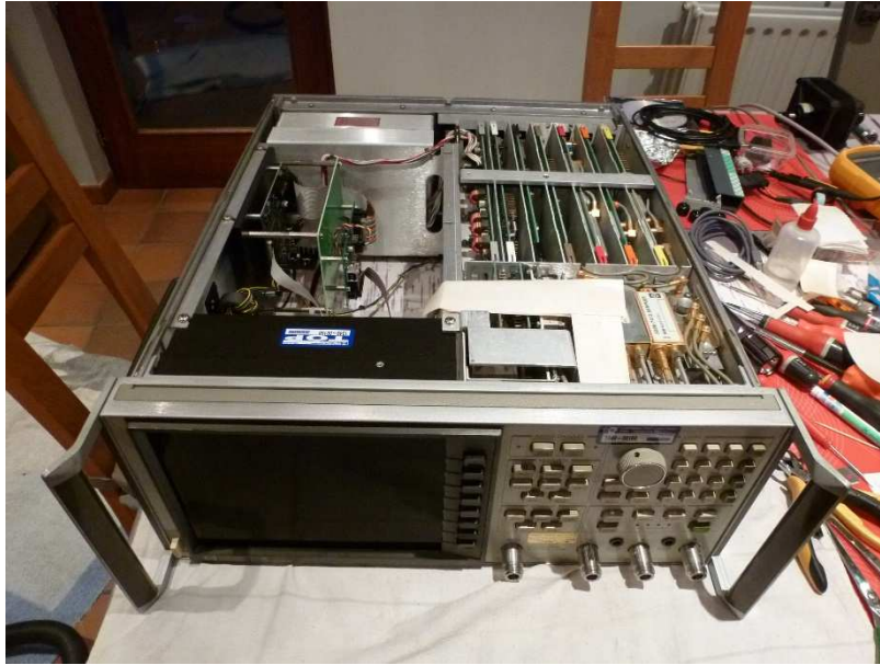
Fig. 44 : Vue d'ensemble d'un analyseur de réseau vectoriel HP 8753B avec un nouvel écran LCD et une interface USB pour l'émulation de l'affichage sur un ordinateur.
