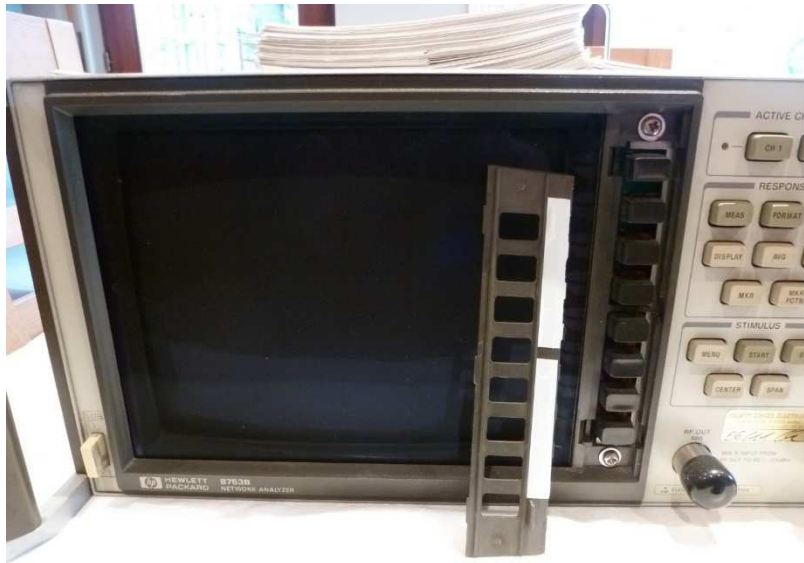
Fig. 26 : Dépose de la garniture des touches de fonctions adjacentes à l'écran. La garniture est fixée par une bande adhésive double face ; celle-ci sera remplacée par une neuve. Les surfaces de contact des pièces en vue du collage adhésif auront été nettoyées avec de l'alcool isopropylique (isopropanol) avant d'apposer la nouvelle bande adhésive.
