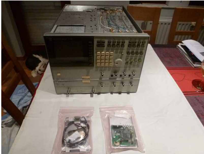
Fig. 3 : Vue générale de l'appareil de mesure avec capot supérieur enlevé ; à l'avant plan on peut observer le kit LCD couleur avec écran monté sur un support mécanique de montage et avec un sous-ensemble électronique d'interface muni des câbles et connecteurs de raccordement.
