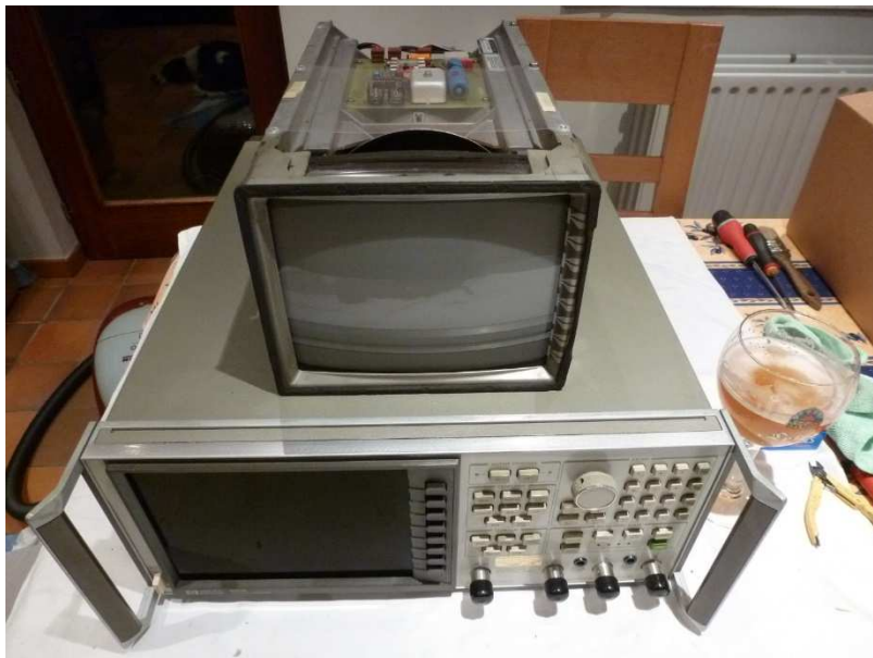
Fig. 37 : Analyseur de réseau vectoriel HP 8753B dont le moniteur à tube cathodique que l'on peut observer déposé au-dessus de l'appareil a été remplacé par un écran LCD.
