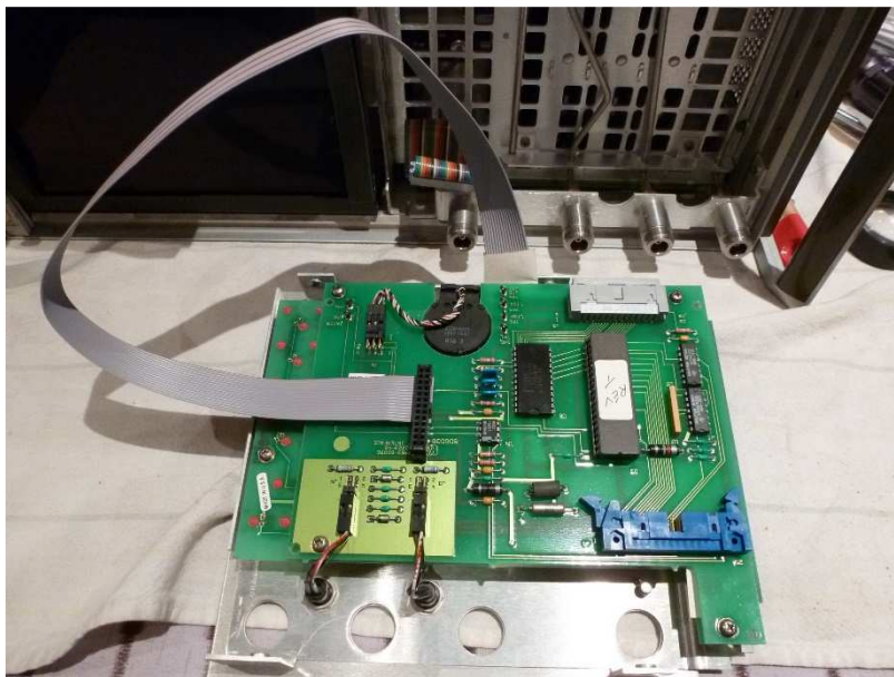
Fig. 41 : La carte électronique d'interface du clavier de l'instrument de mesure est remontée.
