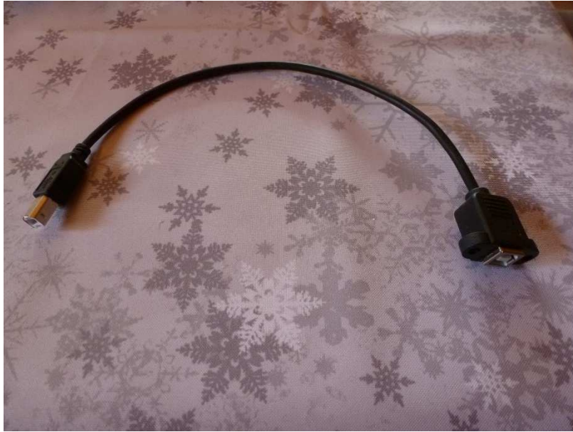
Fig. 46 : Câble USB prolongateur où l'on peut observer le connecteur de traversée sur la partie de droite.
