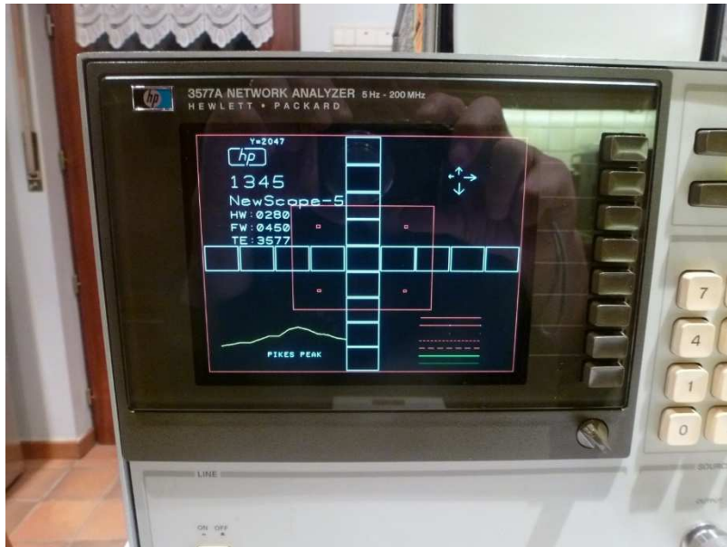
Fig. 12 : Mire de test du moniteur HP 1345A reproduit ici sur le nouvel écran LCD couleur (NewScope-5).
