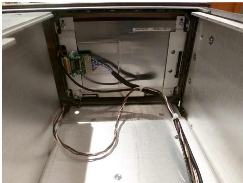
Fig. 8 : Vue arrière de l'écran LCD lorsque la fenêtre de protection est replacée sur l'appareil au-devant de la cavité qui contenait le volumineux moniteur à tube cathodique.
