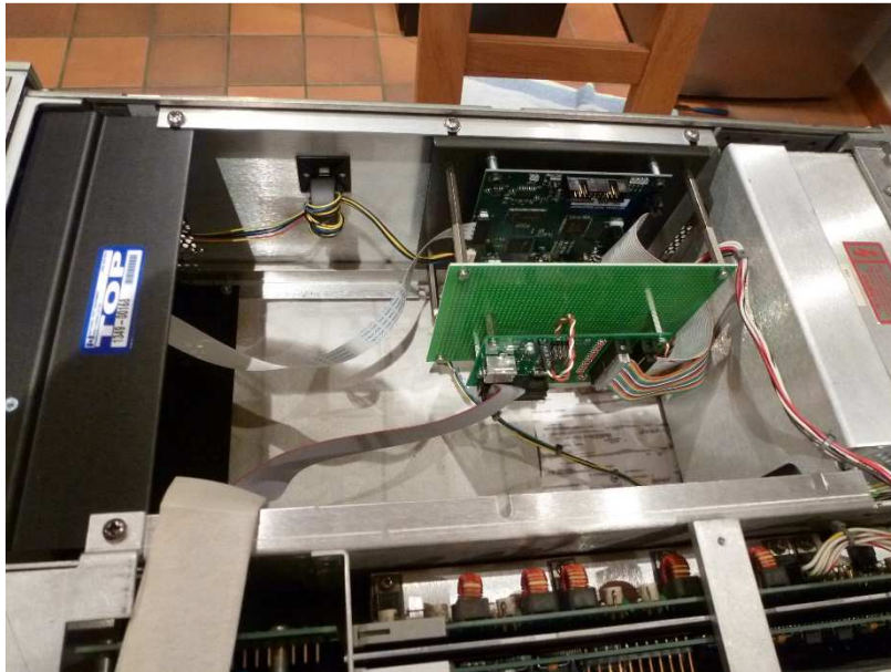
Fig. 42 : Montage de l'interface USB sur la tôle de montage de la carte de pilotage de l'écran LCD.
