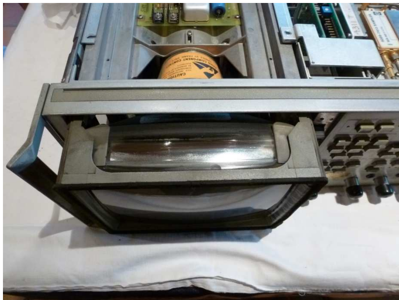
Fig. 28 : Début d'extraction du tiroir moniteur à tube cathodique.
