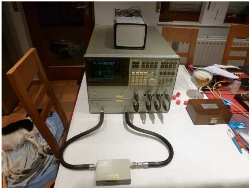
Fig. 11 : Analyseur de réseau vectoriel HP 3577A équipé d'un écran LCD couleur. On peut observer l'ancien moniteur HP 1345A déposé sur le dessus de l'appareil. L'analyseur est raccordé sur un Test-Set HP 35677A. Le calibrage est effectué au moyen des calibres type N du kit HP 35678A. Un filtre passe-bande sous test est raccordé aux ports de mesure.
