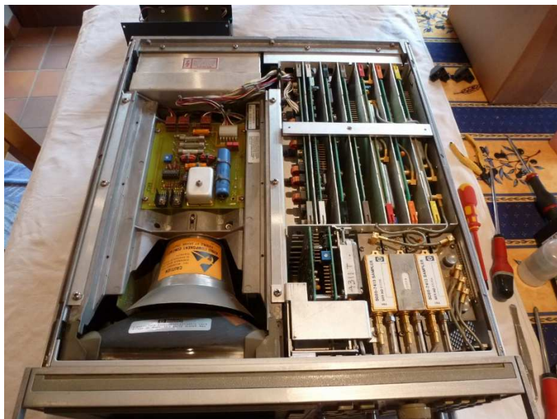
Fig. 16 : Analyseur de réseau vectoriel HP 8753B avec moniteur d'origine à tube cathodique.
