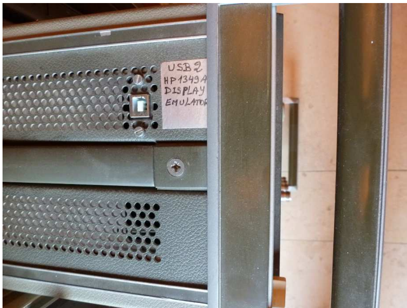
Fig. 45 : Connecteur USB de traversée fixé sur le panneau latéral gauche du rack de l'analyseur.
