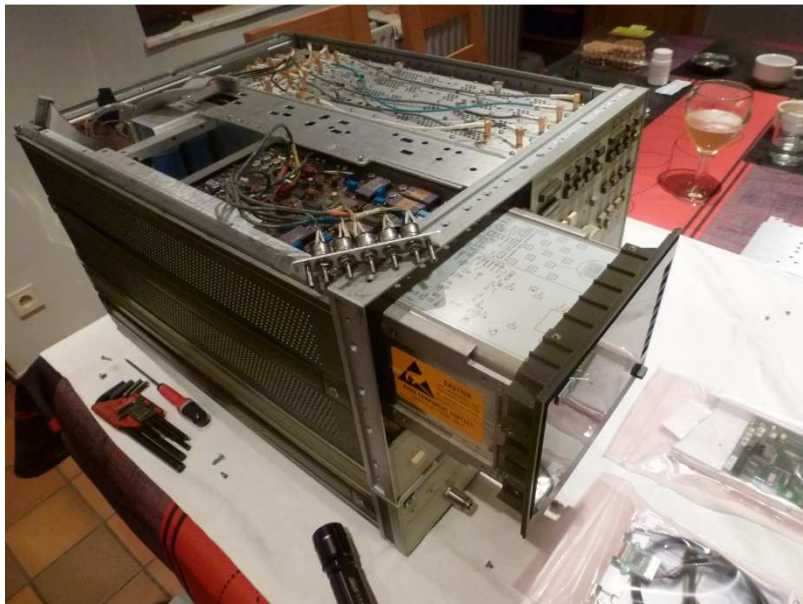
Fig. 4 : Le moniteur monochrome à tube cathodique est extrait comme un tiroir par l'avant de l'appareil. Les potentiomètres de réglage d'origine du moniteur sont déposés de la face arrière. Les connexions entre le moniteur et l'appareil de mesure ont été débrochées (câble plat et connecteur d'alimentation).
