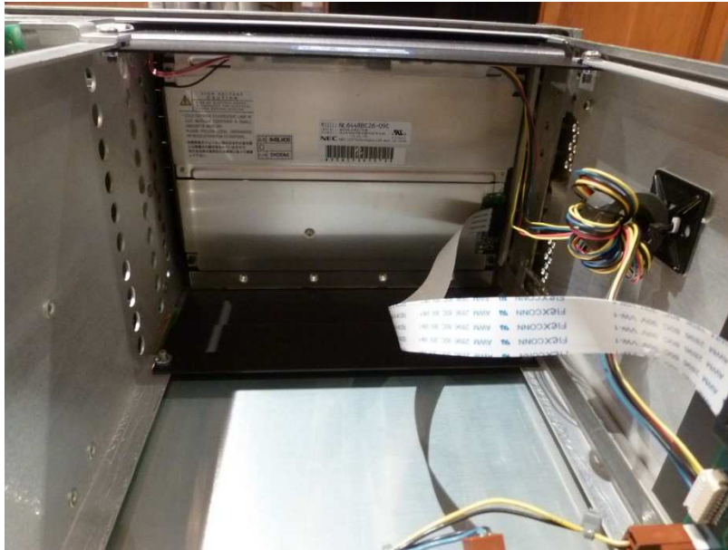
Fig. 36 : Vue arrière de l'écran LCD avec sur la droite un tore ferrite placé sur les fils conducteurs de raccordement entre l'interface électronique et l'écran LCD.
