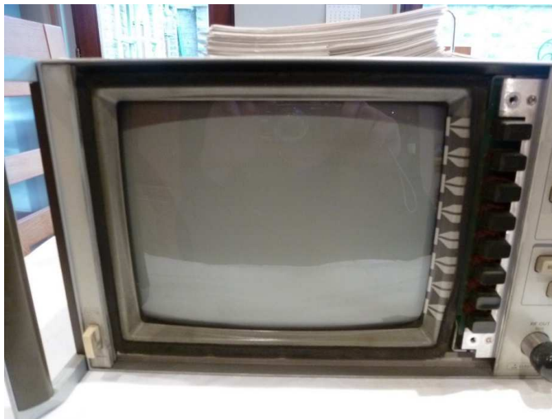
Fig. 27 : Dépose de la fenêtre de protection de l'écran. L'écran du tube cathodique est à présent apparent.
