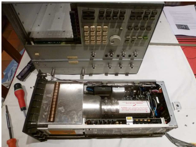
Fig. 5 : Vue du moniteur monochrome d'origine qui est déposé et où l'on peut observer le canon à électron du tube cathodique, l'alimentation THT et l'électronique d'interface.
