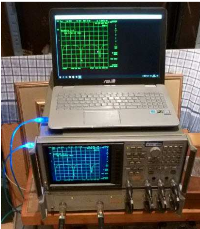
Fig. 47 : Ordinateur portable raccordé sur un analyseur de réseau vectoriel HP 8753B par l'intermédiaire d'une interface USB émulateur du moniteur HP 1349A.
