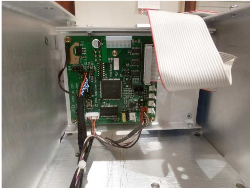
Fig. 9 : Interface électronique de pilotage de l'écran LCD.
