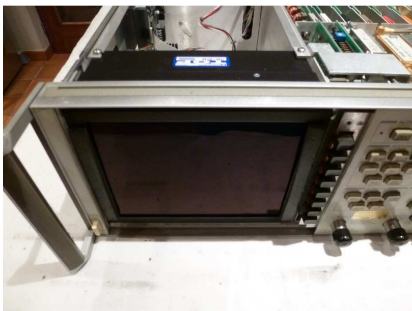
Fig. 33 : Le cadre de montage de l'écran LCD est fixé aux mêmes points d'ancrage de l'ancien moniteur.
