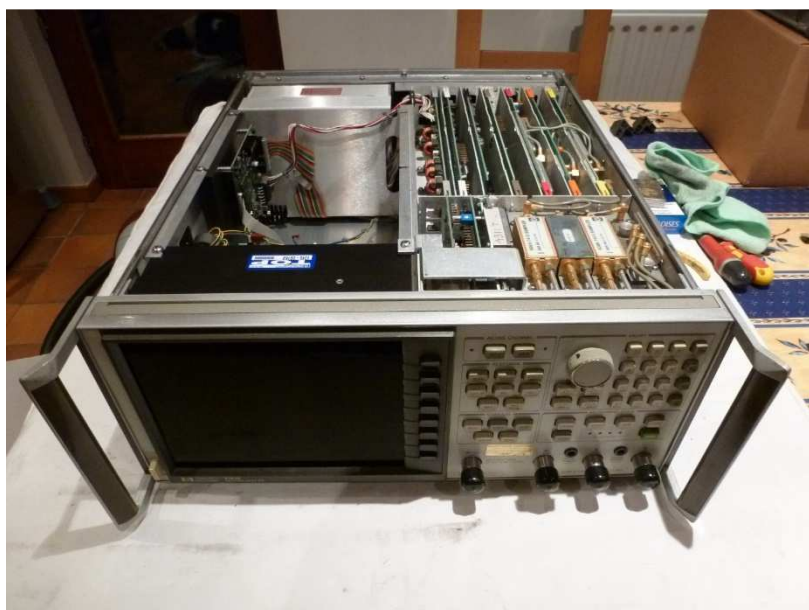
Fig. 17 : Le même analyseur avec un nouvel écran LCD monochrome à haute définition.
