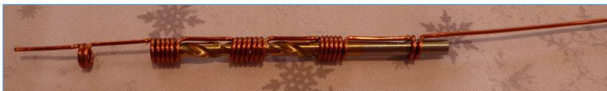
Fig. 21 : Bobinage des inductances des cellules en série du filtre sur la queue d'un foret. Photo : ON4IJ.
