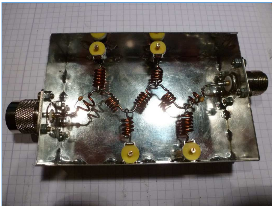
Fig. 28 : Idem figure ci-dessus mais en plus avec les bobines et capacités des cellules shunt . On remarquera les condensateurs céramiques axiaux placés en parallèle sur les bobines de la première et de la dernière cellule du filtre. Ces condensateurs permettent d'atteindre la valeur requise avec les trimmers prévus à cet effet. Photo : ON4IJ.
