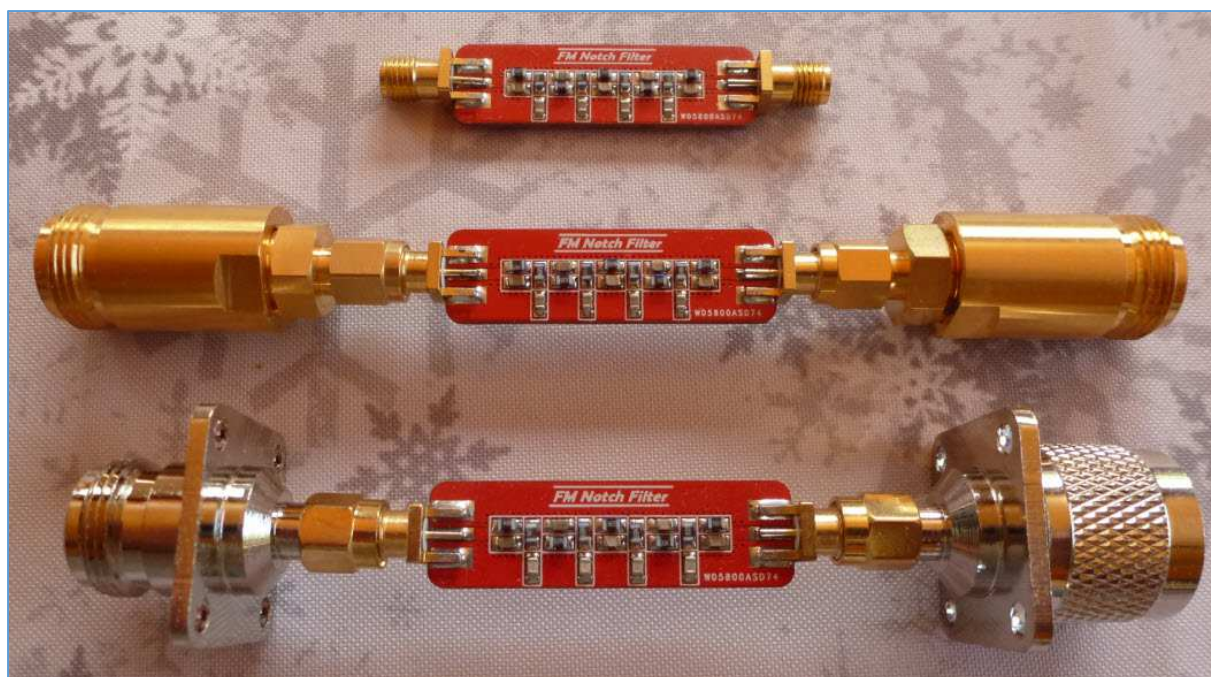
Fig. 12 : Filtrés éliminateurs de bande 88 MHz - 108 MHz du commerce et constitués d'un circuit Butterworth du 9 ème ordre. Photo : ON4IJ.
