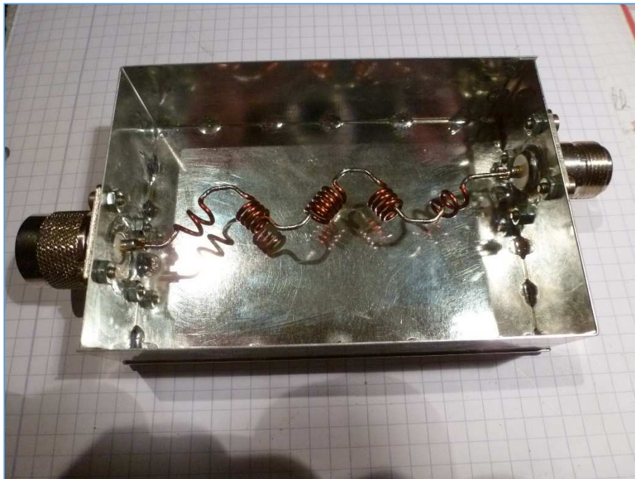
Fig. 27 : Nouveau filtre en cours de construction ; ici on peut observer les bobines des cellules en série du filtre. Photo : ON4IJ.
