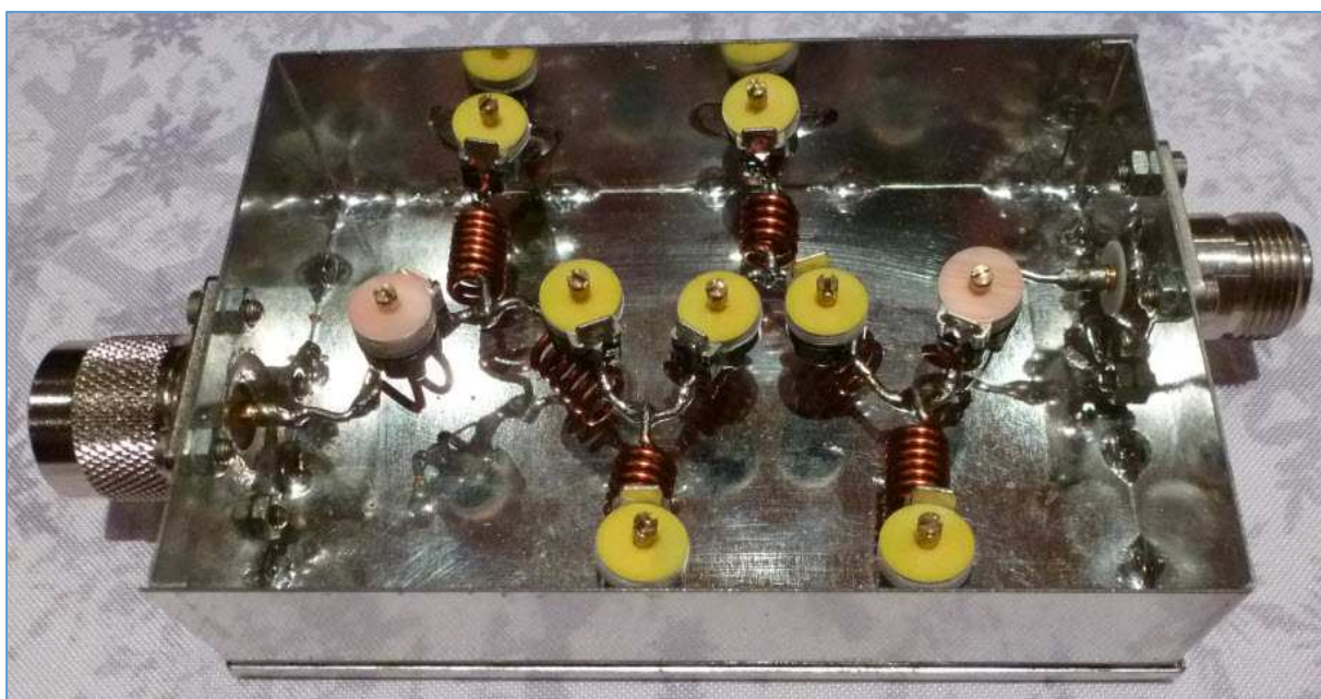
Fig. 23 : Filtre complètement assemblé avec les condensateurs variables trimmers isolés au téflon. Photo : ON4IJ.
