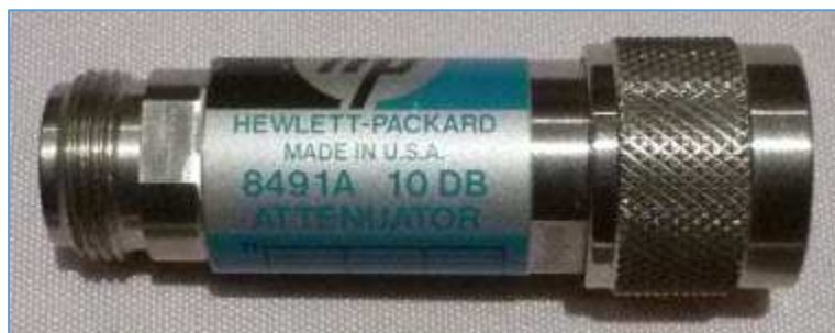
Fig. 2 : Atténuateur HP 8491A de 10 dB pouvant être placé, en cas de nécessité, à l'entrée HF d'un analyseur de spectre. Photo : ON4IJ.
