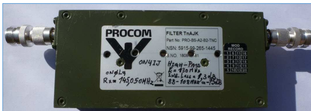
Fig. 79 : Filtre Procom TnAJK modifié en filtre passe-haut. Cinq trous ont été forés sur la coquille supérieure pour permettre le réglage du filtre lorsque celui-ci est complètement blindé. Photo : ON4IJ.
