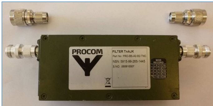
Fig. 34 : Filtre Procom TnAJK, modèle PRO-BS-A2-B2-TNC dont le raccordement à des équipements munis de câbles coaxiaux équipés de connecteurs type N s'effectue par des adaptateurs Type N - TNC. Photo : ON4IJ.
