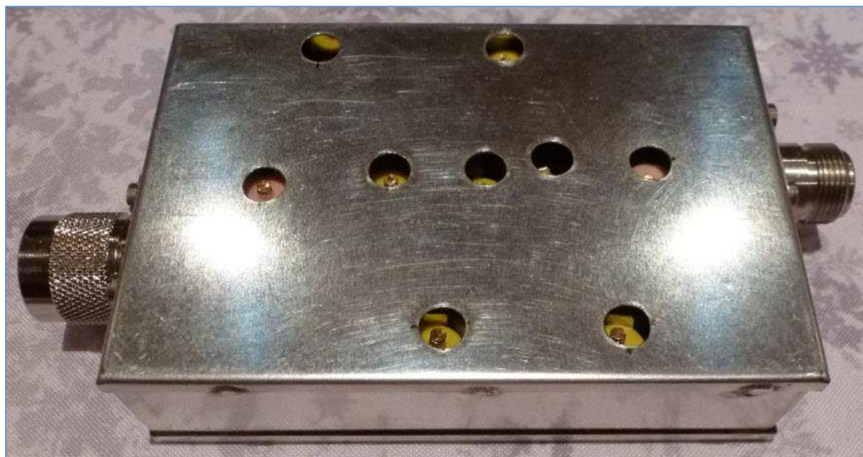
Fig. 25 : Filtre éliminateur de bande terminé avec couvercle de blindage assemblé sur le boîtier. Photo : ON4IJ.
