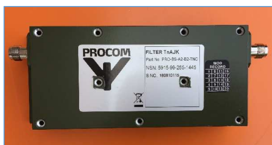
Fig. 32 : Filtre Procom de fabrication spéciale et de caractéristiques inconnues mais qui toutefois devrait être un filtre éliminateur de bande entre des fréquences de l'ordre de 70 MHz et 105 MHz. Source : photo de ON7PC.
