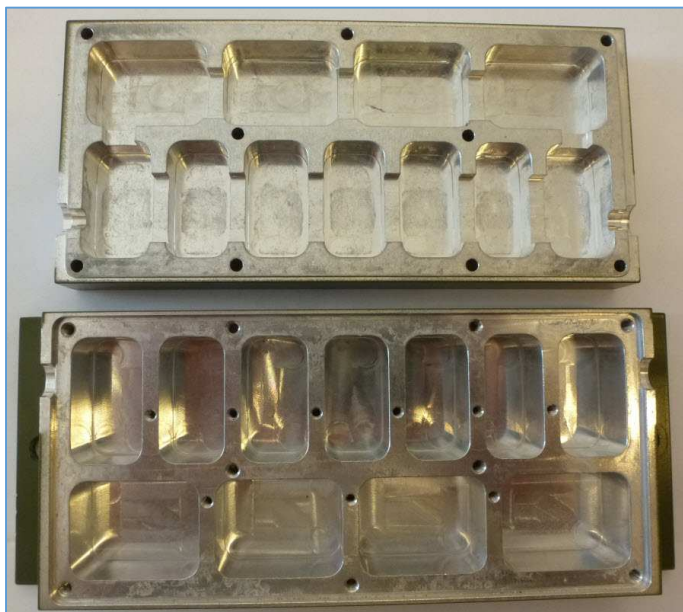
Fig. 35 : Coquilles du blindage du filtre Procom avec usinage de logettes séparées par fraisage hors masse pour les cellules du filtre. Photo : ON4IJ.
