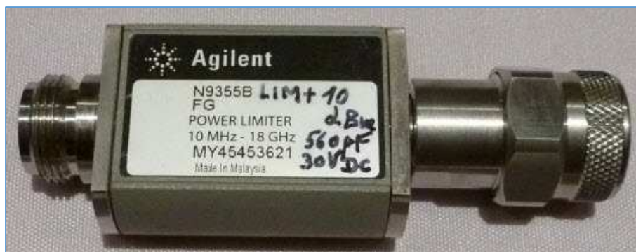
Fig. 3 : Dispositif de protection « Power Limiter » pouvant judicieusement être raccordé directement à l'entrée HF d'un analyseur de spectre. Photo : ON4IJ.
