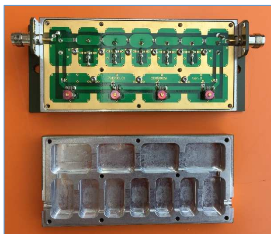
Fig. 33 : Même filtre avec dépose du capot supérieur qui révèle une série de logettes dans le boîtier blindé. Les composants du filtre sont assemblés sur un circuit imprimé où apparaissent les condensateurs. Les bobines ne sont pas visibles sur ce cliché et doivent probablement être situées sur la face inférieure du circuit imprimé. Source : photo de ON7PC.
