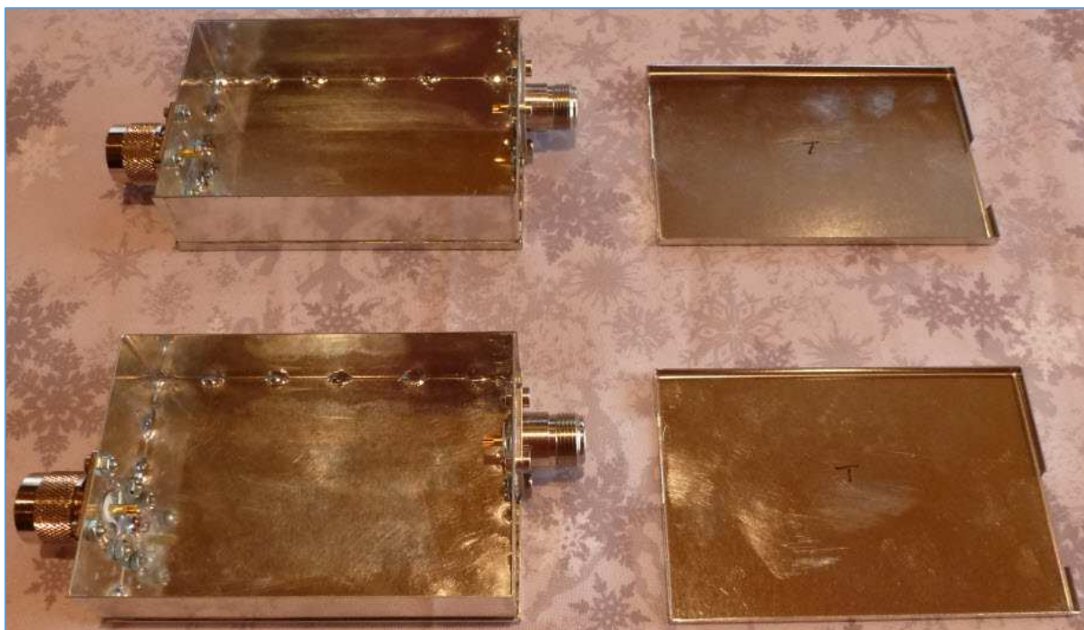
Fig. 20 : Blindage préassemblé avec les connecteurs type N d'entrée et de sortie du filtre. Photo : ON4IJ.
