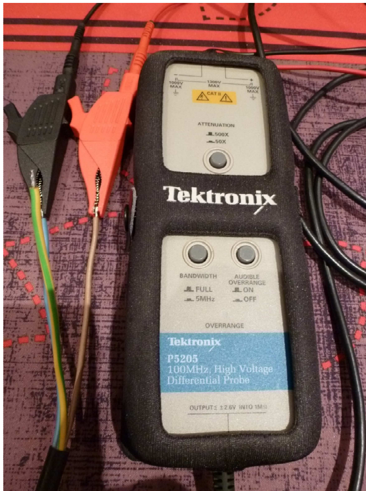
Fig. 49 : Sonde différentielle haute tension utilisée entre autres pour les mesures sur des réseaux électriques. Il y a lieu de se rappeler qu'une tension efficace de 230 V représente une amplitude crête à crête de 650 V pp . Il s'agit donc bien de haute tension !
