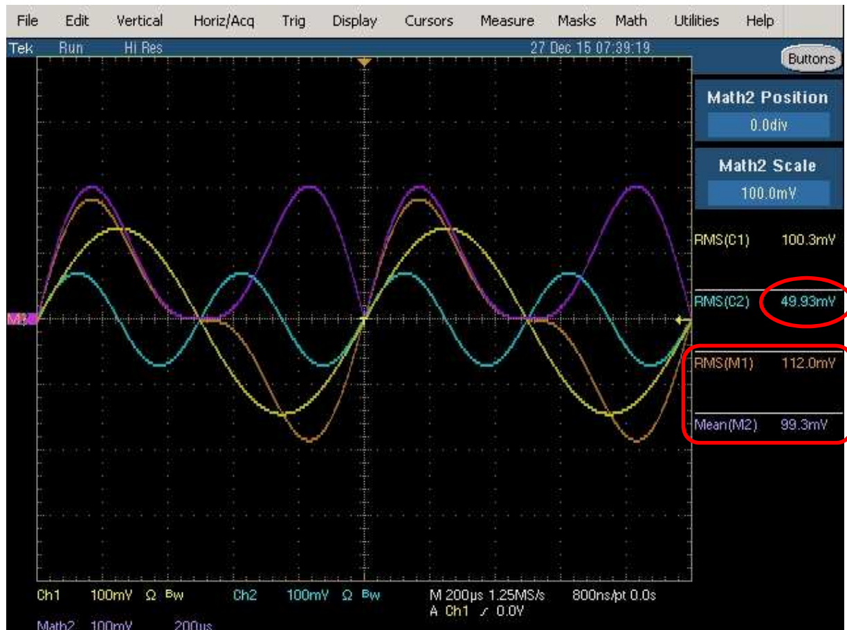
Fig. 36 : Fondamental (1 kHz, 100 mV RMS ) et 2 ème harmonique (2 kHz, 50 mV RMS ) avec phase relative de 0°. L'origine des phases est visualisée au centre de l'écran.
