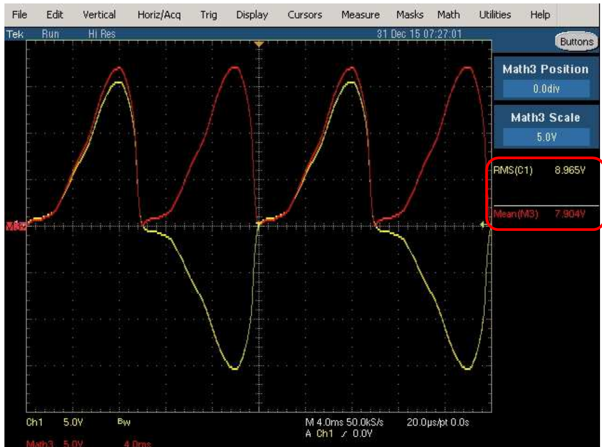
Fig. 58 : Mesure True RMS et average responding de la tension de sortie transfo. Le Variac est réglé vers la position du maximum de tension pour obtenir une tension nominale de 9 V_{RMS} au secondaire transfo.
