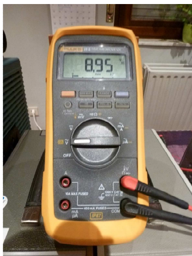
Fig. 60 : Mesure de la tension nominale de 9 V au secondaire transfo sur un multimètre True RMS .
