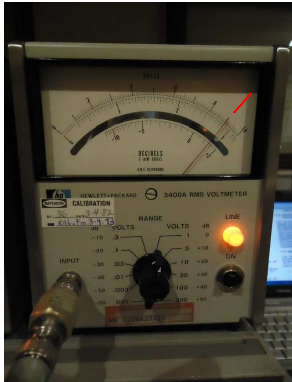
Fig. 10 : (à gauche) Grandeur mesurée (sinusoïdal) HP 400E average responding de 905 mV RMS . Fig. 11 : (à droite) Grandeur mesurée (sinusoïdal) HP 3400A RMS responding de 902 mV RMS .
