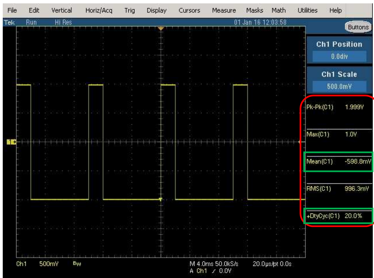
Fig. 42 : Signal rectangulaire symétrique (100 Hz, 2 V pp ) d'un rapport cyclique de 20 % . Mesures de U pp , U peak , U moy , U RMS (AC+DC), rapport cyclique.
