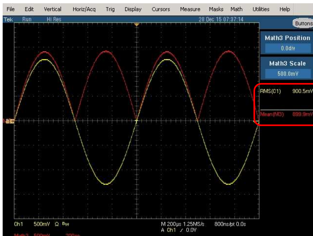
Fig. 9 : Relevé sur l'oscilloscope d'une tension True RMS de 900,5 mV et en simulation RMS average responding de 899,9 mV RMS . Les deux mesures sont cohérentes pour un signal sinusoïdal pur.
