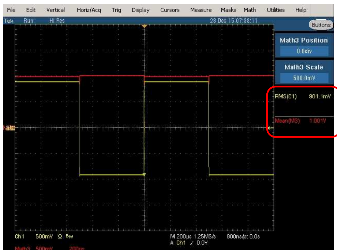
Fig. 14 : Relevé sur l'oscilloscope d'une tension True RMS de 901,1 mV et en simulation RMS average responding de 1,001 V RMS . Les deux mesures ne sont plus cohérentes pour un signal carré.
