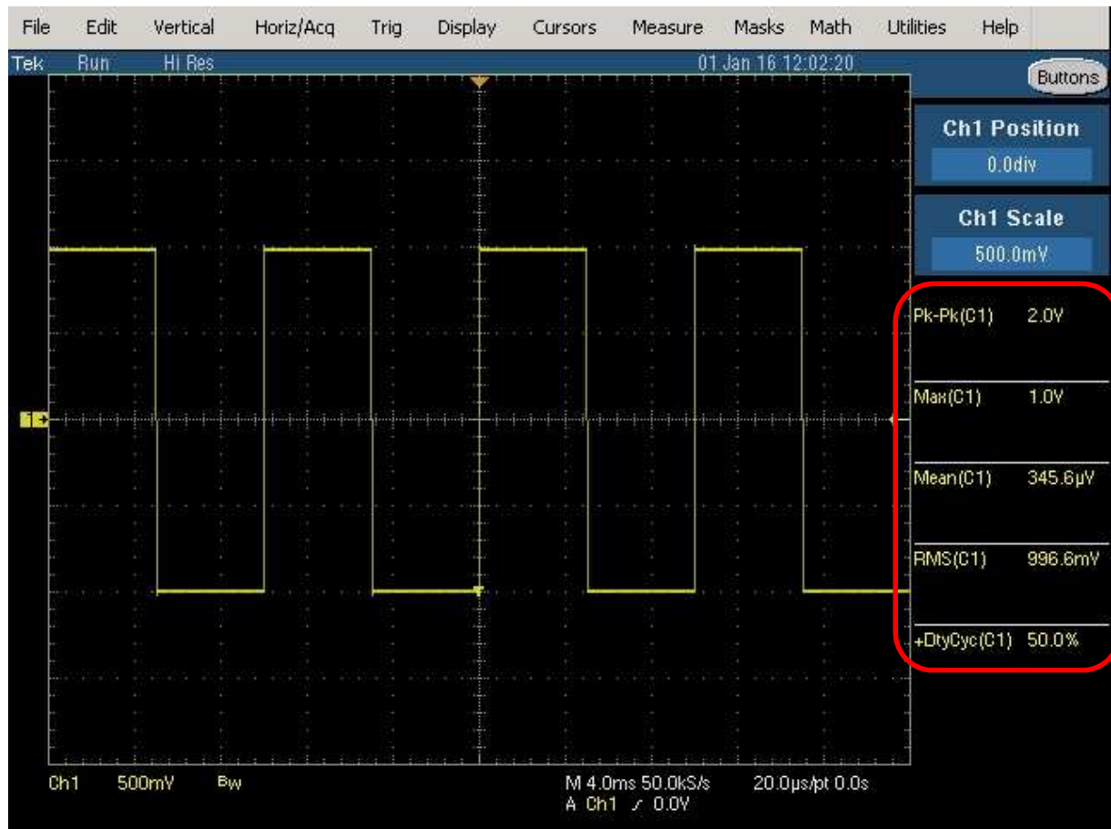
Fig. 39 : Signal rectangulaire symétrique (100 Hz, 2 V pp ) d'un rapport cyclique de 50 % (signal carré symétrique). Mesures de U pp , U peak , U moy , U RMS (AC+DC), rapport cyclique.
