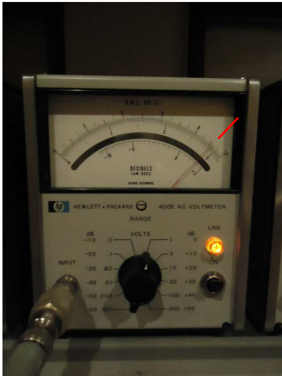
Fig. 10 : (à gauche) Grandeur mesurée (sinusoïdal) HP 400E average responding de 905 mV RMS . Fig. 11 : (à droite) Grandeur mesurée (sinusoïdal) HP 3400A RMS responding de 902 mV RMS .
