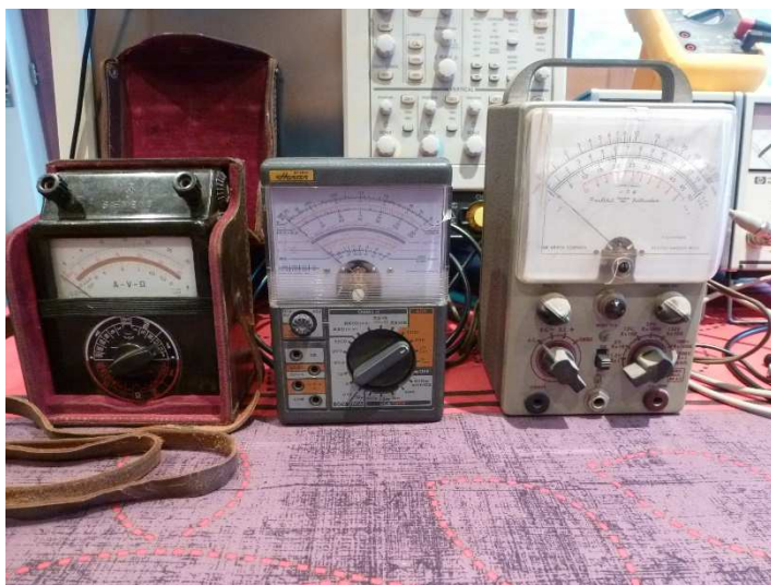
Fig. 61 : Voici les vieux multimètres poussiéreux qui appartenaient à grand-papa. Ces voltmètres ne sont pas True RMS mais sont tous du type average responding . Attention à ce que l'on mesure, ou ce que l'on croit mesurer.
