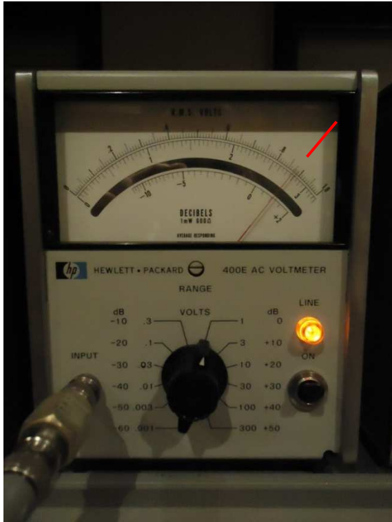
Fig. 20 : (à gauche) Grandeur mesurée (triangle) HP 400E average responding de 866 mVRMS. Fig. 21 : (à droite) Grandeur mesurée (triangle) HP 3400A RMS responding de 900 mVRMS.
