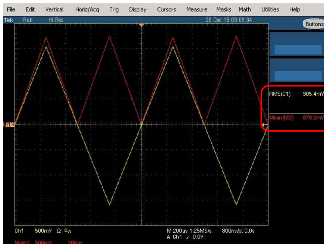
Fig. 19 : Relevé sur l'oscilloscope d'une tension True RMS de 905,4 mV et en simulation RMS average responding de 870,2 mV RMS . Les deux mesures ne sont plus cohérentes pour un signal triangulaire.
