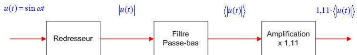
Fig. 3 : Schéma bloc d'un voltmètre alternatif RMS average responding . Ce principe est appliqué au voltmètre analogique HP 400E.
