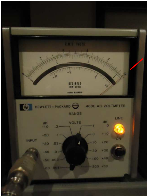
Fig. 15 : (à gauche) Grandeur mesurée (carré) HP 400E average responding de 1,000 VRMS. Fig. 16 : (à droite) Grandeur mesurée (carré) HP 3400A RMS responding de 900 mVRMS.
