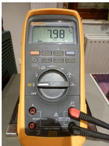
Fig. 57 : Mesure de la tension nominale 8 V_{RMS} secondaire transfo sur un multimètre True RMS .
