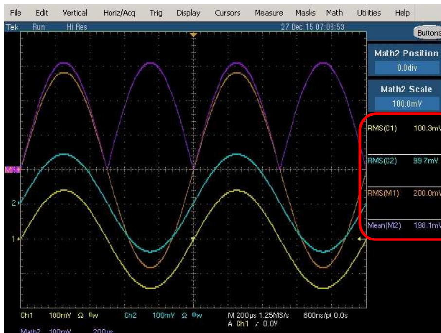
Fig. 27 : Pour se familiariser avec les oscillogrammes qui vont suivre, voici une composition de deux sinusoïdes de même fréquence (1 kHz), de même amplitude (100 mV RMS ) et qui sont en phase (ondes constructives). La légende de couleur des traces est : jaune = canal 1 ; cyan = canal 2 ; brun orangé (Math 1) = somme des canaux 1 et 2 ; magenta (Math 2) = simulation du fonctionnement d'un voltmètre RMS average responding . L'affichage des mesures à la droite de l'écran est de la même légende de couleur et l'objet de ces mesures a été décrit à la figure précédente.
