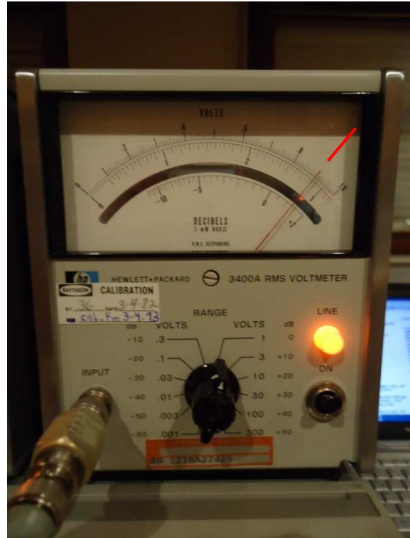
Fig. 15 : (à gauche) Grandeur mesurée (carré) HP 400E average responding de 1,000 VRMS. Fig. 16 : (à droite) Grandeur mesurée (carré) HP 3400A RMS responding de 900 mVRMS.
