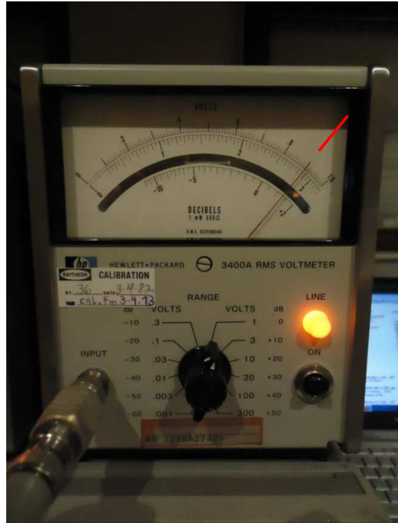
Fig. 20 : (à gauche) Grandeur mesurée (triangle) HP 400E average responding de 866 mVRMS. Fig. 21 : (à droite) Grandeur mesurée (triangle) HP 3400A RMS responding de 900 mVRMS.
