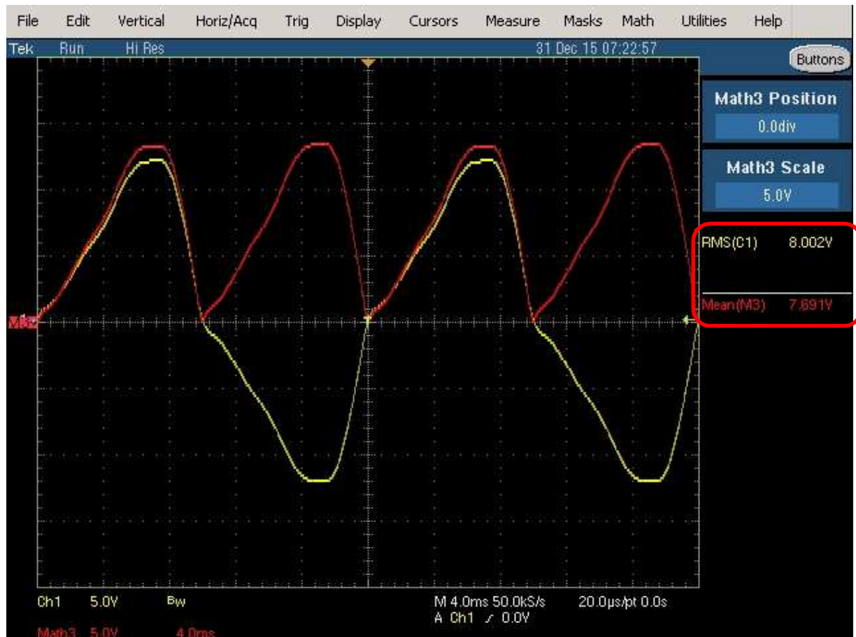
Fig. 55 : Mesure True RMS et average responding de la tension de sortie transfo. Le Variac est réglé vers la position du minimum de tension pour obtenir une tension nominale de 8 V RMS au secondaire transfo.
