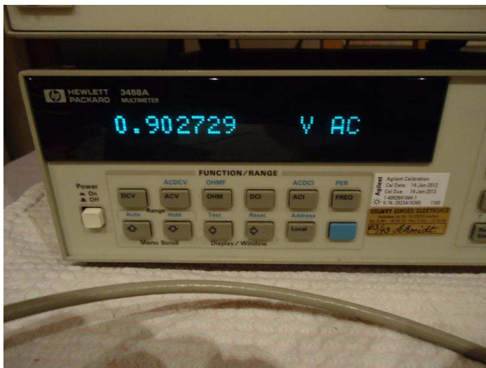
Fig. 22 : Grandeur mesurée (triangle) HP 3458A True RMS de 902,7 mV RMS .
