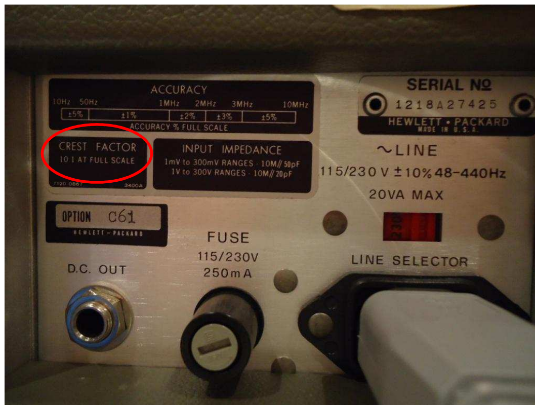
Fig. 23 : Voltmètre RMS HP 3400A : RMS Responding . Caractéristique de facteur de crête de 10 : 1 (à fond d'échelle).
