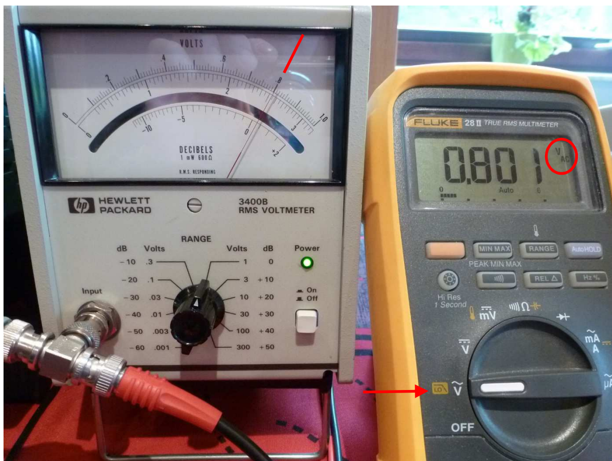
Fig. 43 : Mesures d'un signal rectangulaire symétrique (100 Hz, 2 V pp ) d'un rapport cyclique de 20 % . Mesures de la tension efficace vraie U_{\text{RMS (AC)}} au moyen d'un voltmètre analogique RMS responding et d'un multimètre True RMS .
