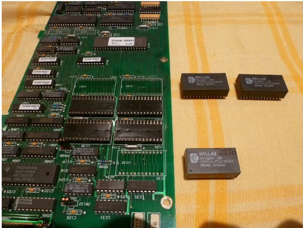
Fig. 23 : Dépose des trois NVRAM.
