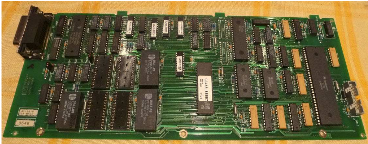
Fig. 21 : Carte CPU du multimètre numérique HP 3458A où sont visibles les emplacements de l'extension mémoire RAM, les trois NVRAM (Dallas) et l'EPROM du firmware .
