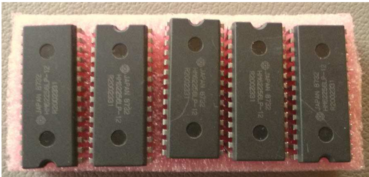
Fig. 22 : Composants mémoires RAM (4 pièces et une de réserve).
