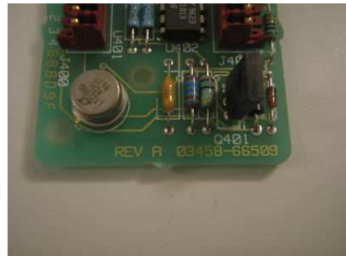
Fig. 4 : Détail de la référence de tension.
