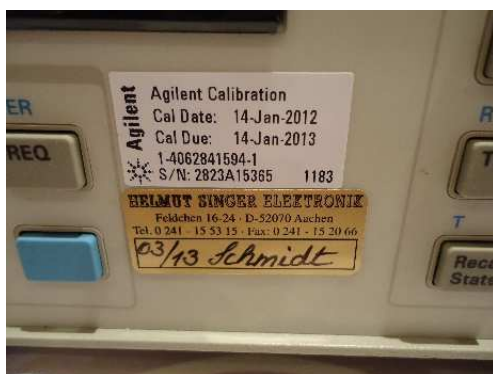
Fig. 16 : Estampille de calibrage de l'instrument de mesure en laboratoire Agilent.
