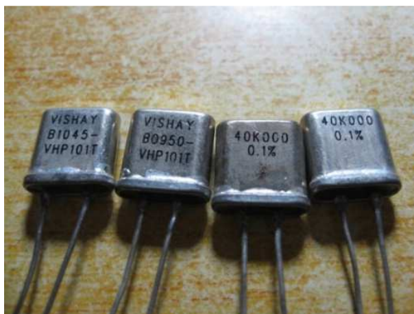
Fig. 15 : Quelques exemplaires de résistance Vishay VHP101. Source image Internet.
