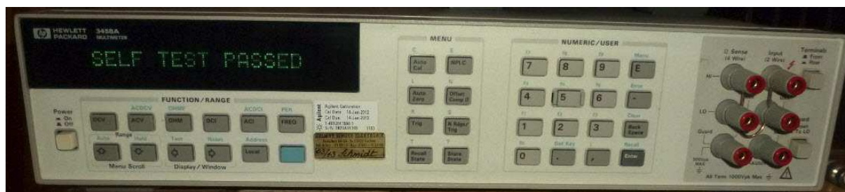
Fig. 29 : Autotest réussi sans erreur après remplacement des NVRAM et à la remise sous tension de l'appareil de mesure.
