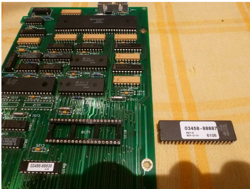
Fig. 24 : Placement de l'EPROM du firmware sur soquet de circuit intégré.
