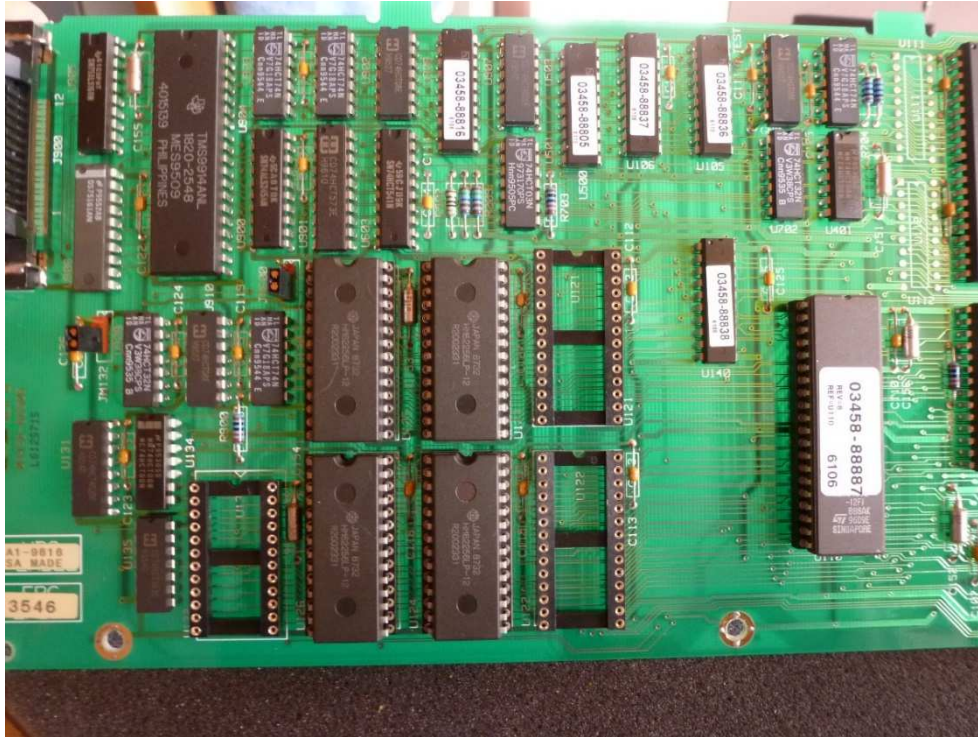
Fig. 27 : Placement de l'extension de mémoire RAM sur leurs soquets appropriés.
