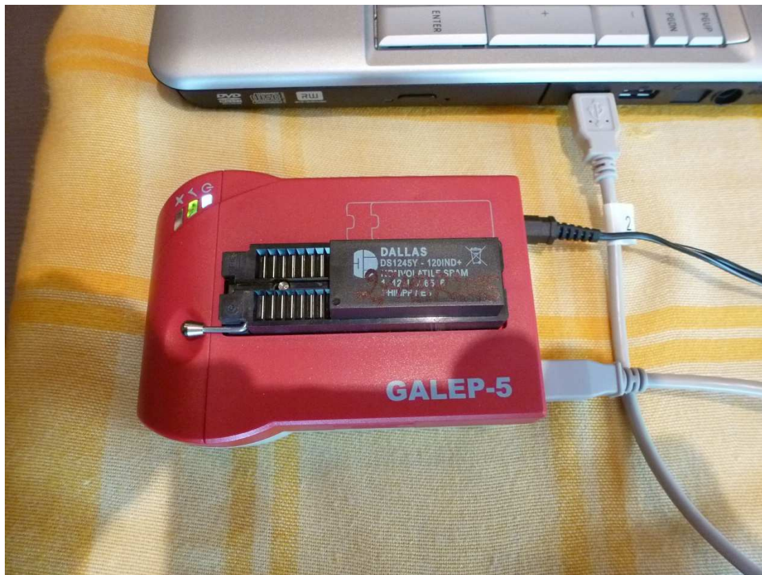
Fig. 5 : Programmeur universel pour la lecture de la NV-RAM d'origine et enregistrement de son contenu sous forme de fichier .BIN sur un PC portable. Programmation d'une nouvelle NV-RAM.
