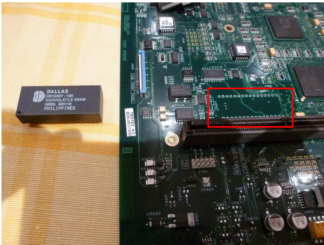
Fig. 4 : Dépose de la NV-RAM d'origine au moyen d'une station de dessoudage appropriée.
