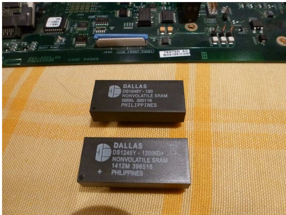
Fig. 1 : NV-RAM Dallas DS1245Y-120 (120 ns) remplacée par une version récente (120+) avec gamme de température étendue (120IND+).
