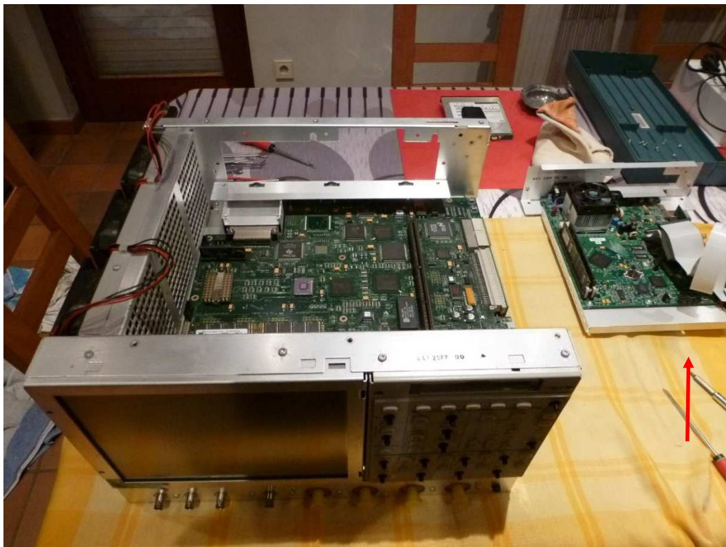
Fig. 2 : Ouverture de l’instrument de mesure et dépose de la carte mère NLX (carte processeur PPC), dépose du lecteur Floppy , du lecteur DVD et du disque dur.
