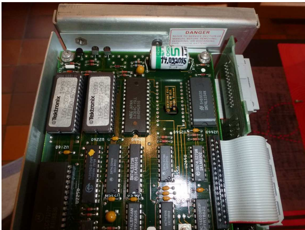
Fig. 14 : La carte CPU est remplacée dans l'oscilloscope. La date de mise en service de la nouvelle pile lithium Saft est inscrite sur celle-ci : 14.09.2015.
