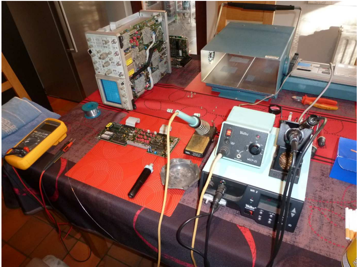
Fig. 9 : Environnement de travail avec outillage approprié : fer à souder, station de dessoudage (à l'avant-plan), multimètre électronique. L'oscilloscope est visible à l'arrière-plan de la prise de vue.
