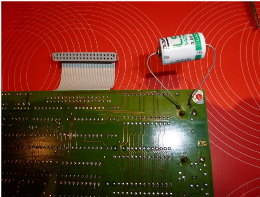
Fig. 10 : Raccordement d'une alimentation externe (2 ème pile lithium) pour maintenir la mémoire RAM sous tension.
