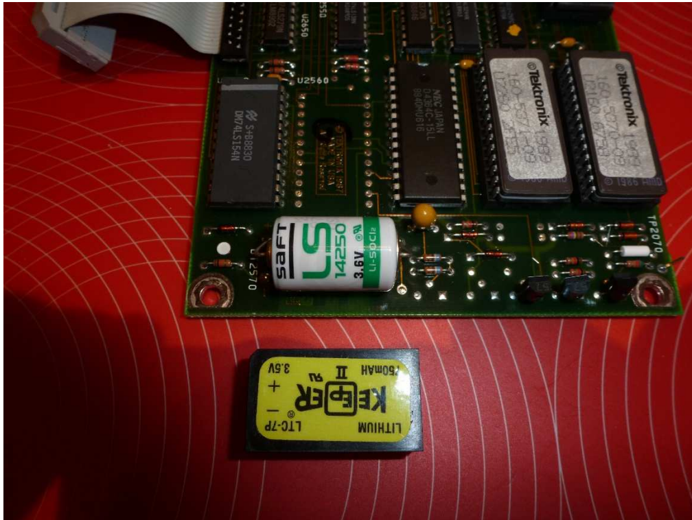
Fig. 13 : La 2 ème pile lithium ayant servi d'alimentation externe de la RAM peut à présent être enlevée.
