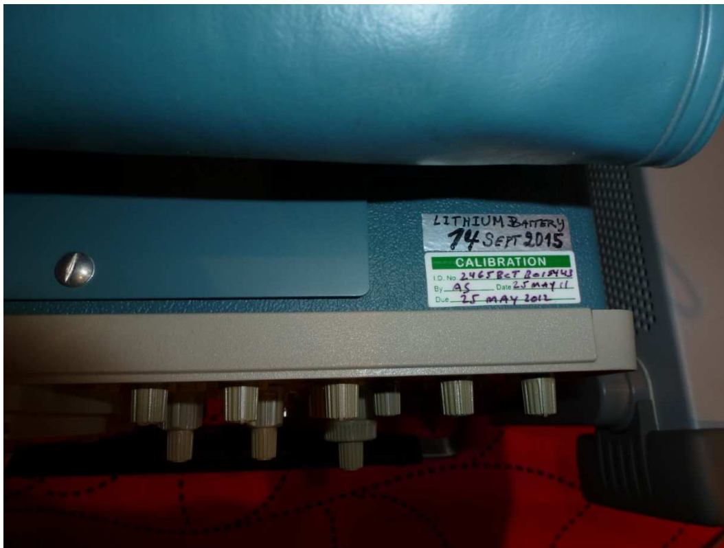
Fig. 16 : Une étiquette mentionnant la date de mise en service de la nouvelle pile au lithium est apposée près de l'estampille de calibrage de l'appareil.
