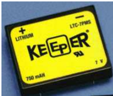
Fig. 3 : Pile au lithium Keeper LTC-7P, 3,5 V 750 mAh d'origine sur la carte CPU de l'oscilloscope 2465BCT.
