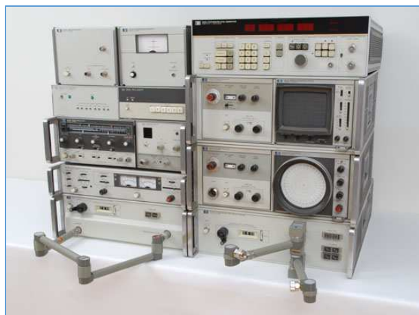
Fig. 29 : Ensemble HP 8409B : analyseur de réseau vectoriel HP 8410B en station semi-automatique. Source : HP Memory Project.
