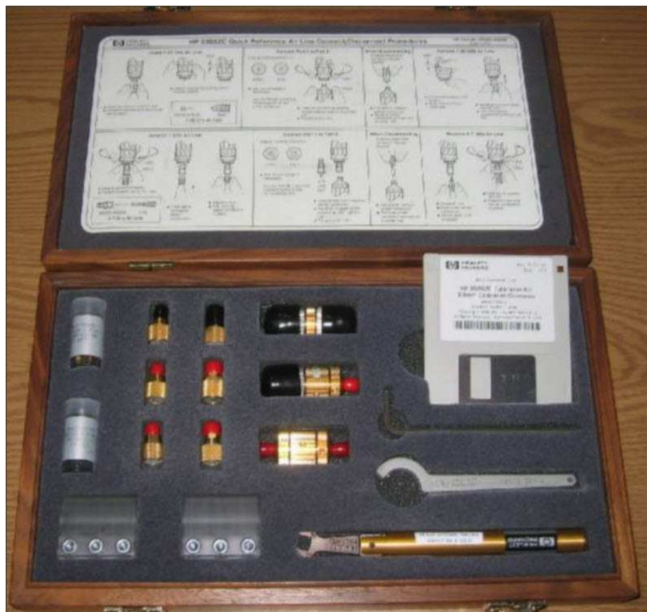
Fig. 148 : Kit de calibrage « TRL » APC 3.5 HP 85052C. Source : Axiom Test Equipment 2610 Commerce Way Vista, CA 92081 USA.
