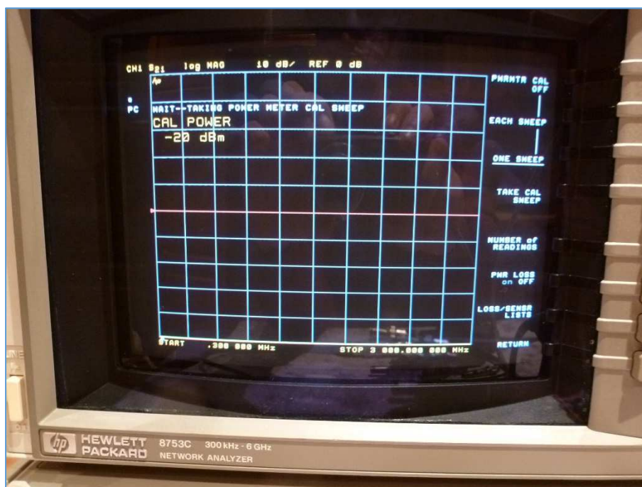
Fig. 188 : Message « WAIT - - TAKING POWER METER CAL SWEEP » lors du balayage du calibrage avec Power Meter . Photo : ON4IJ.
