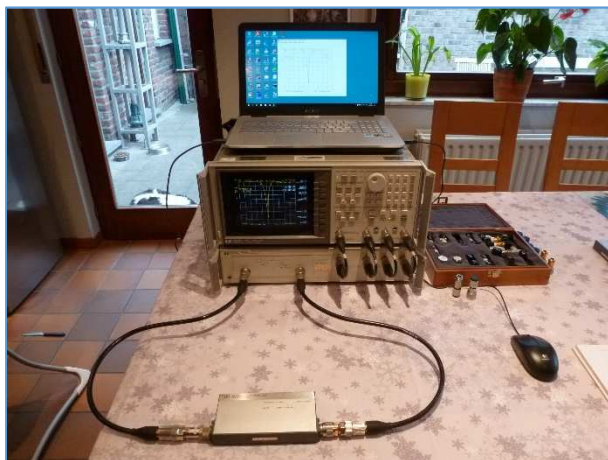
Fig. 83 : Mesure de transmission d'un filtre éliminateur de bande sur un analyseur de réseau vectoriel HP 8753C où l'on vient d'effectuer un calibrage « Response and Isolation ». Photo : ON4IJ.
