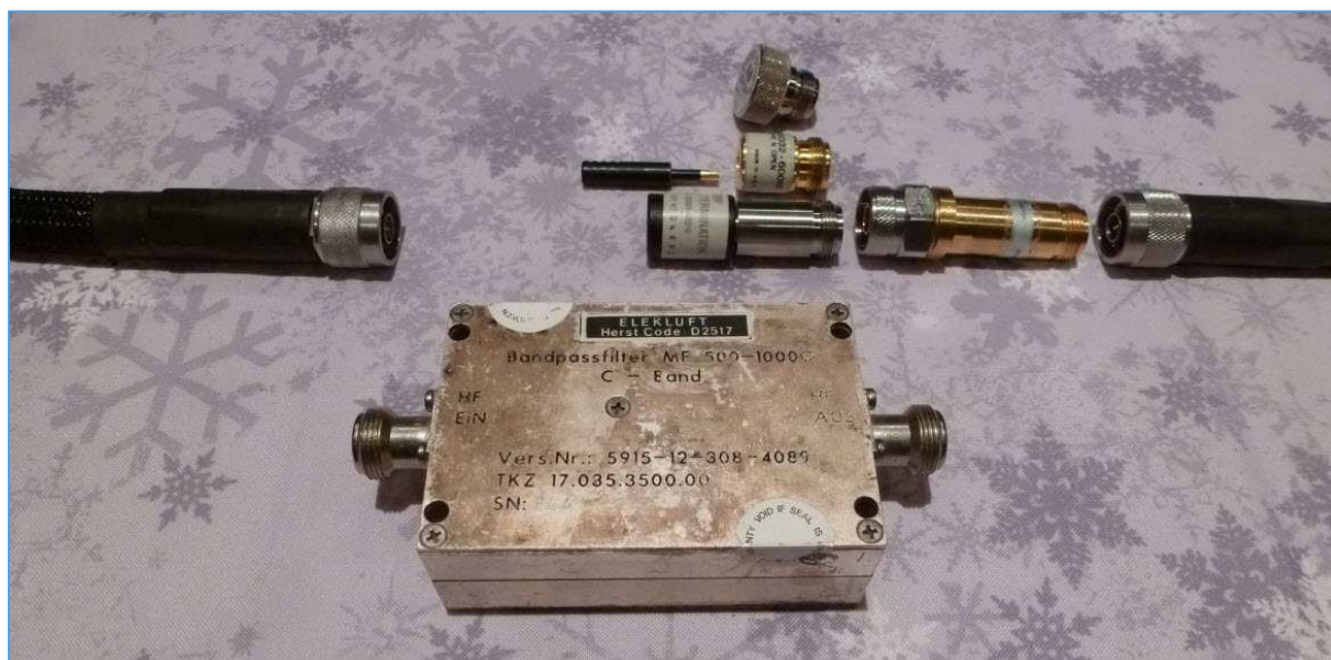
Fig. 161 : Calibrage « SOLT » 2 ème partie S_{22} Short-Open-Load sur le 2 ème port de mesure où a été placé un adaptateur Type N mâle/Type N femelle dont la longueur d'onde électrique correspond à celle du calibre Thru qui sera utilisé dans la 3 ème partie du calibrage. Photo : ON4IJ.
