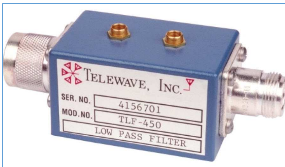
Fig. 139 : Filtre passe-bas UHF ; perte d'insertion 0,25 dB (max.) ; atténuation du second harmonique -50 dB. Source : Telewave, Inc. San Jose, California USA.
