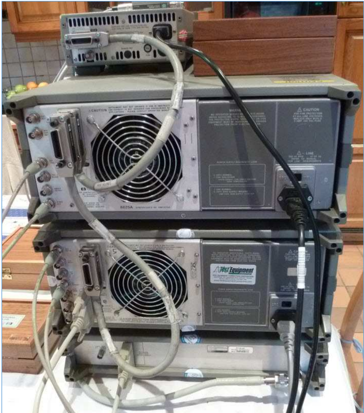
Fig. 214 : HP 8753C Option E20 Frequency Converter Test System ; vue arrière où l'on peut observer les liaisons GPIB pour le dialogue entre les appareils. Photo : ON4IJ.
