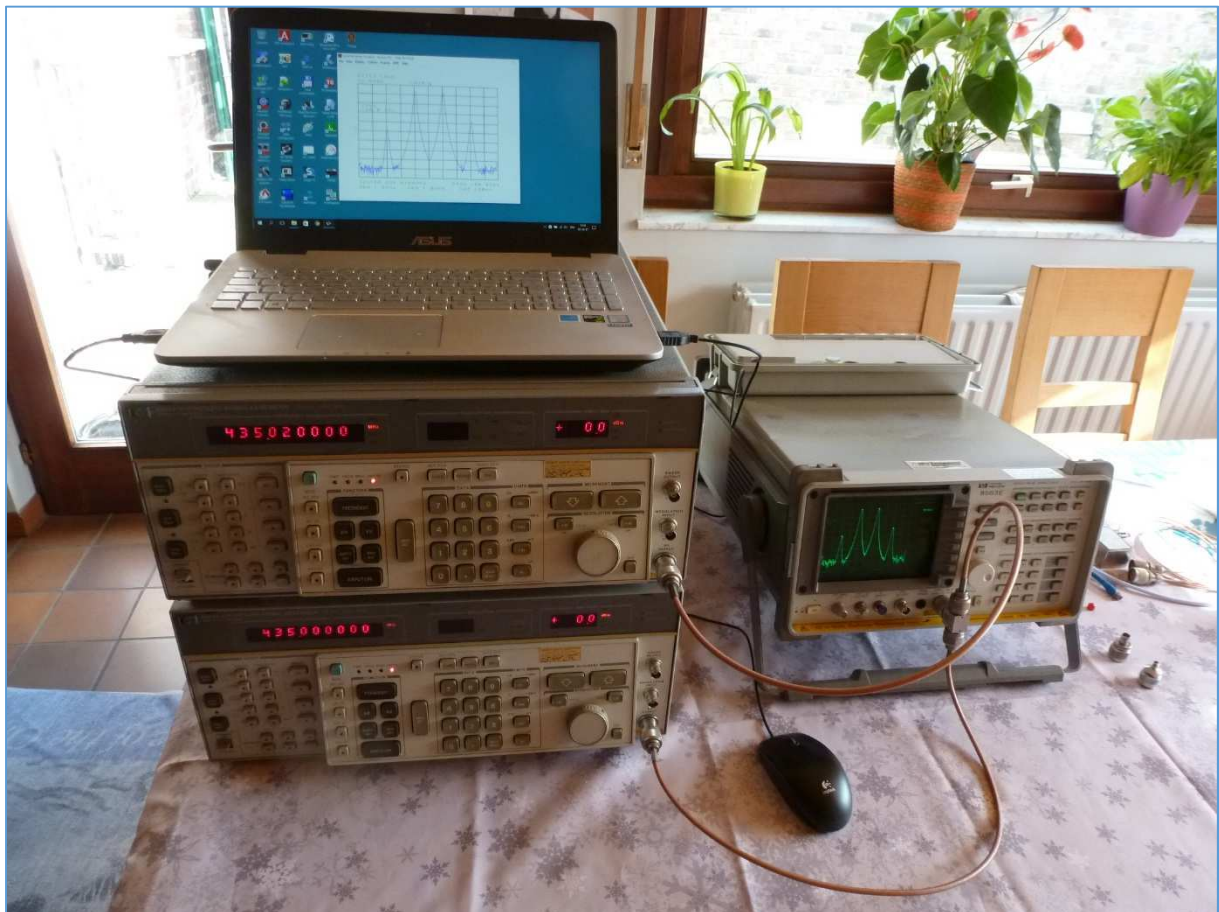
Fig. 131 : Raccordement de deux générateurs HF au moyen d'un simple diviseur de puissance (HP 11636A) placé à l'entrée de l'analyseur de spectre. Ceci va faire apparaître des produits d'intermodulation à cause de la faible isolation d'un tel dispositif. Photo : ON4IJ.
