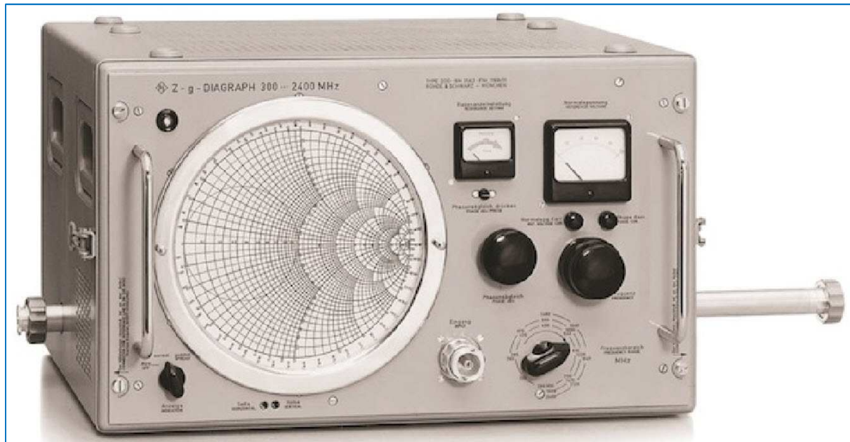
Fig. 5 : Le premier « analyseur » de réseau vectoriel au monde inventé par le constructeur Rohde & Schwarz : le diagraph Zg. Source EDN News Electronic Test 1936-1955, a look back, part 3, Janine Love, 24 Mai 2013.
