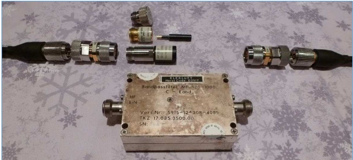
Fig. 156 : Calibrage « SOLT » 1 ère partie S_{11} Short-Open-Load avec adaptateur APC7/Type N mâle sur le 1 er port de mesure. Le dispositif sous test est non insérable avec deux connecteurs Type N femelles. Photo : ON4IJ.
