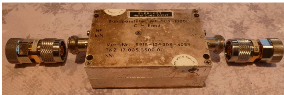
Fig. 45 : Adaptateurs APC7/type N mâle placé à l'entrée et à la sortie du dispositif sous test « non insérable ». L'adaptateur APC7/type N mâle placé à la sortie du dispositif sous test doit avoir la même longueur d'onde électrique que l'adaptateur APC7/type N femelle qui avait servi pour le calibrage de l'appareil de mesure. Photo : ON4IJ.
