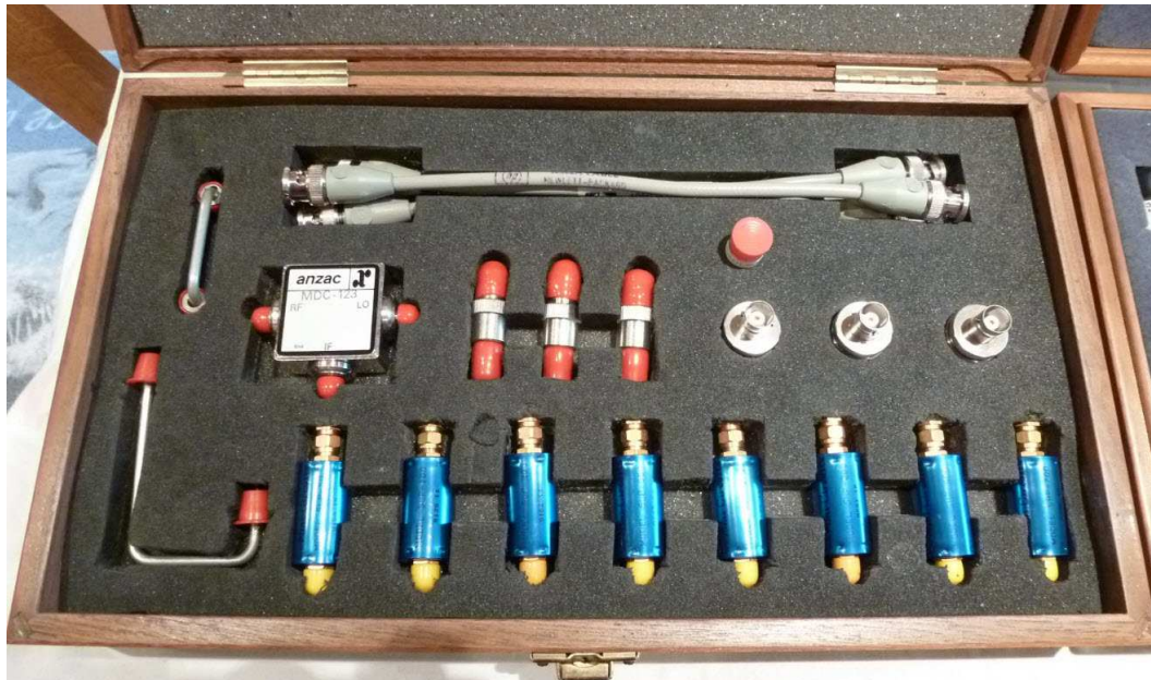
Fig. 215 : HP P/N 85046-60025, Mixer Test Set Accessory Kit ; ce kit contient plusieurs filtres passe-bas et passe-haut (du constructeur Mini Circuit), divers adaptateurs, câbles de liaison et un mélangeur de référence Anzac (M/A-COM) MDC-123. Photo : ON4IJ.
