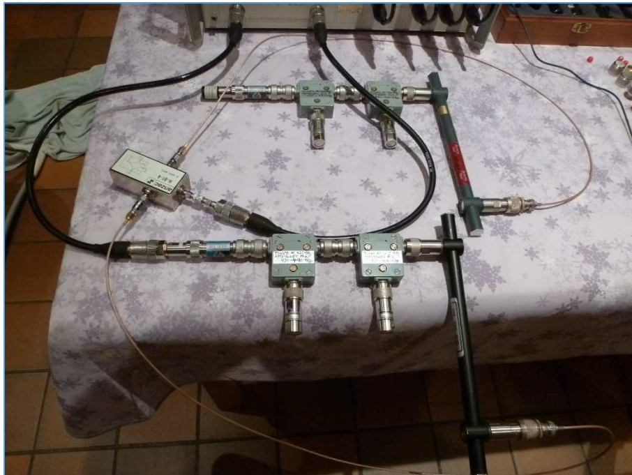
Fig. 120 : « Combining Network » raccordé sur un analyseur de réseau vectoriel. Les ports de mesure sont raccordés entre une des deux entrées et la sortie du dispositif sous test ; une charge est placée sur la deuxième entrée. Photo ON4IJ.
