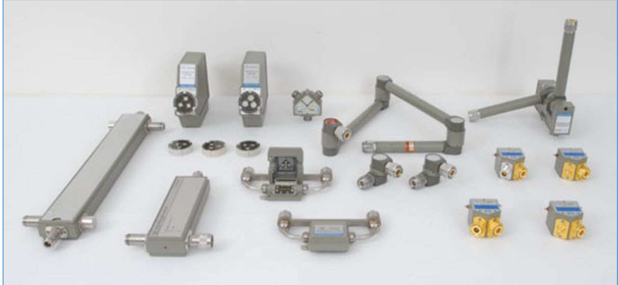
Fig. 54 : Accessoires du S-Parameter Test Set HP 8745A. De gauche à droite : coupleurs directionnels, dispositif de raccordement de transistors, bras articulés et relais coaxiaux. Source : HP Memory Project.
