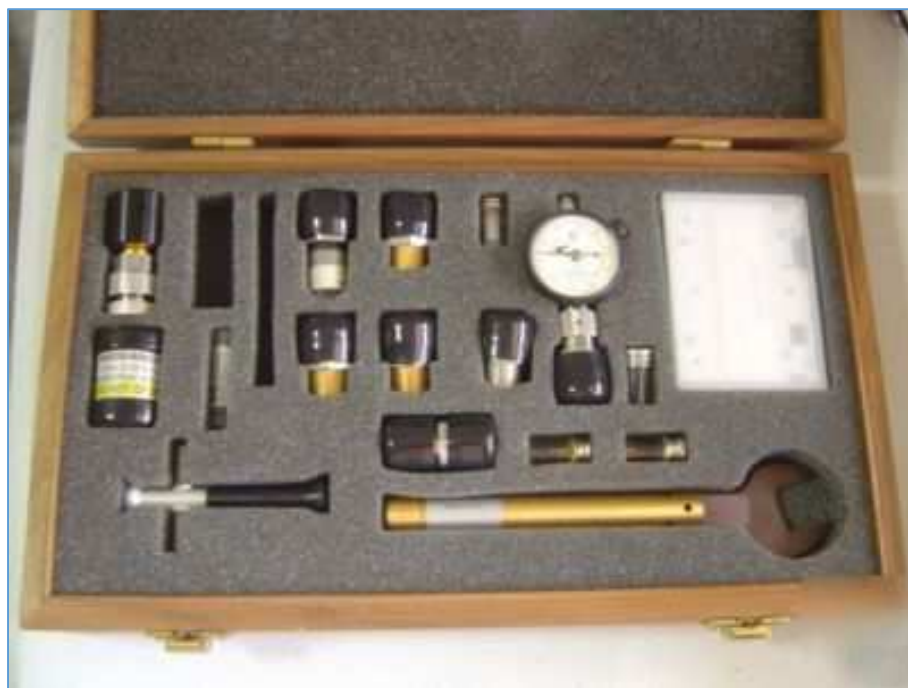
Fig. 147 : Kit de calibrage « TRL » APC7 HP 85050C. Source : Wisconsin Parts Database.
