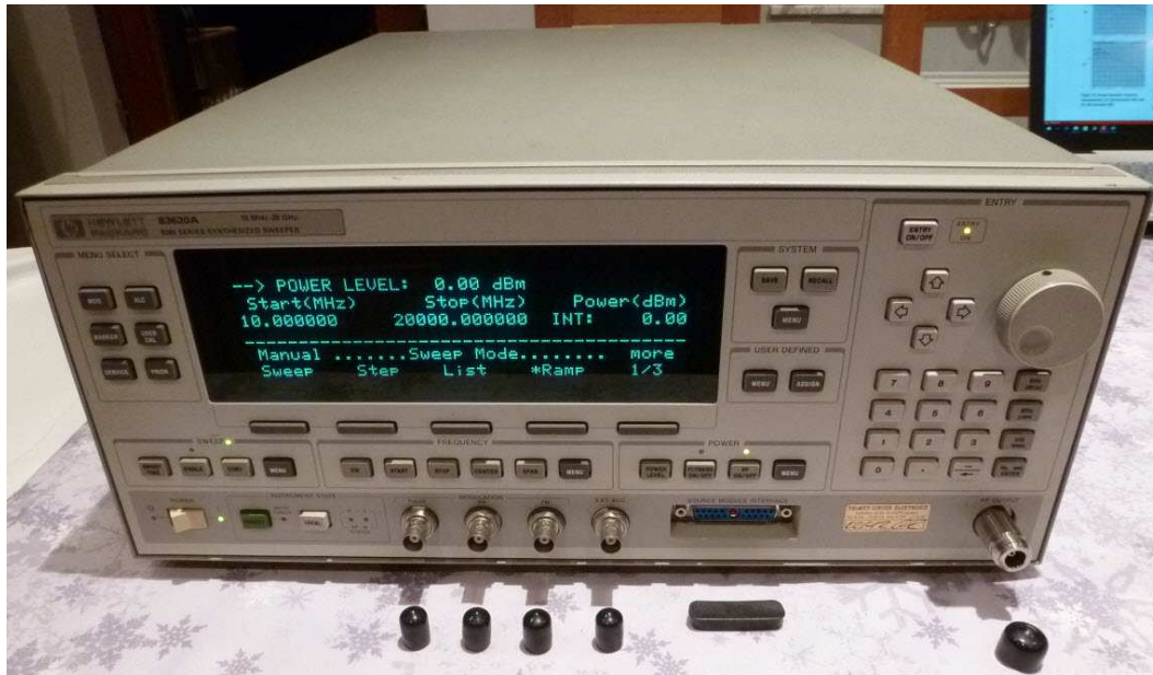
Fig. 26 : Sweeper synthétiseur HP 83620B de 10 MHz à 20 GHz. Ce modèle fait partie de la série HP 8360 qui décline des synthétiseurs à balayage de fréquence large bande jusqu'à des fréquences de 40 GHz en un seul appareil. Cette série de Sweeper constitue une référence pour les analyseurs de réseaux vectoriels performants et haut de gamme (HP 8510C, par exemple). Photo : ON4IJ.
