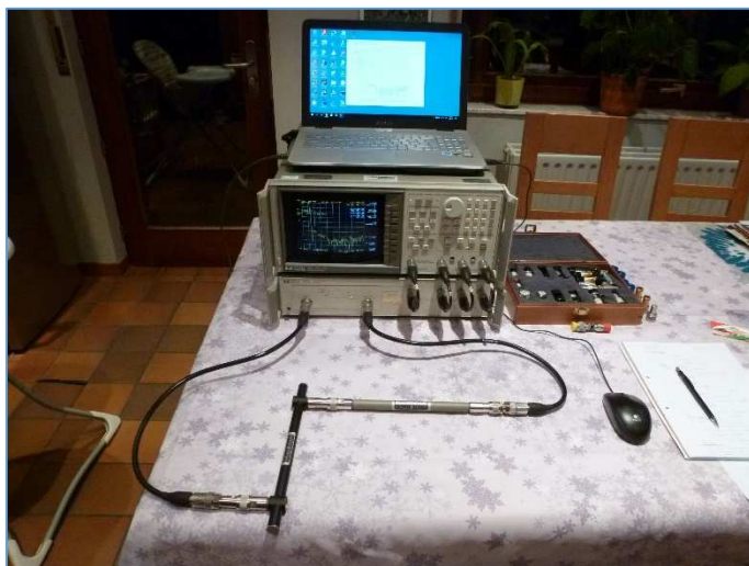
Fig. 107 : Relevé de la transmission de deux filtres passe-bas en cascade (700 MHz et 2,2 GHz). Photo : ON4IJ.
