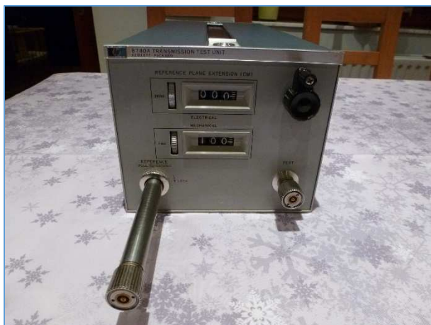
Fig. 37 : Ici, la ligne mécaniquement extensible est réglée sur une longueur de 10 cm. Photo : ON4IJ.
