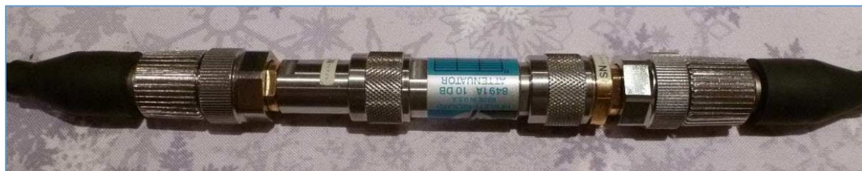
Fig. 100 : Atténuateur fixe de 10 dB HP 8491A raccordé aux câbles de mesure d'un analyseur de réseau vectoriel. Photo : ON4IJ.
