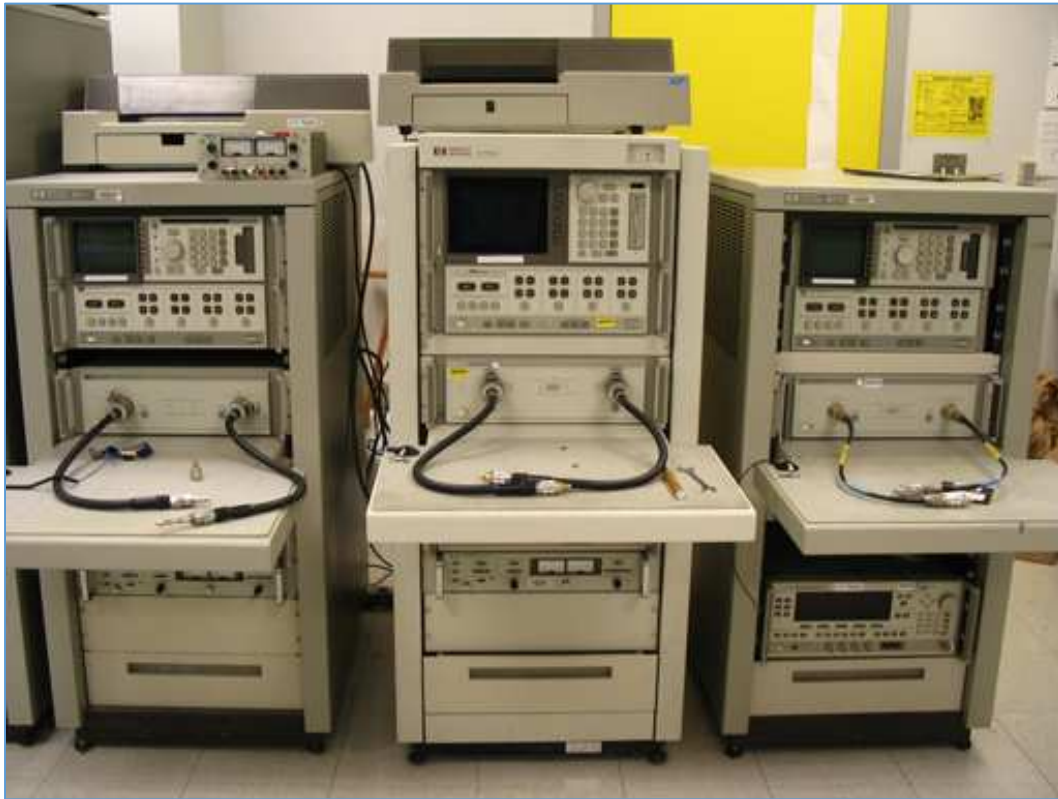
Fig. 61 : Analyseurs de réseaux vectoriels HP 8510 placés dans des armoires de mesure avec différents Test Set et générateurs Sweeper . Des plateaux sont fixés aux armoires pour pouvoir y déposer les dispositifs sous test juste à hauteur des ports de mesure des Test Set . Source : Microwave Devices, Antennas and Systems Laboratory (MDASL) Laboratory Facility, Department of Electrical and Computer Engineering, University of California Davis, One Shields Avenue, Davis CA 95616.
