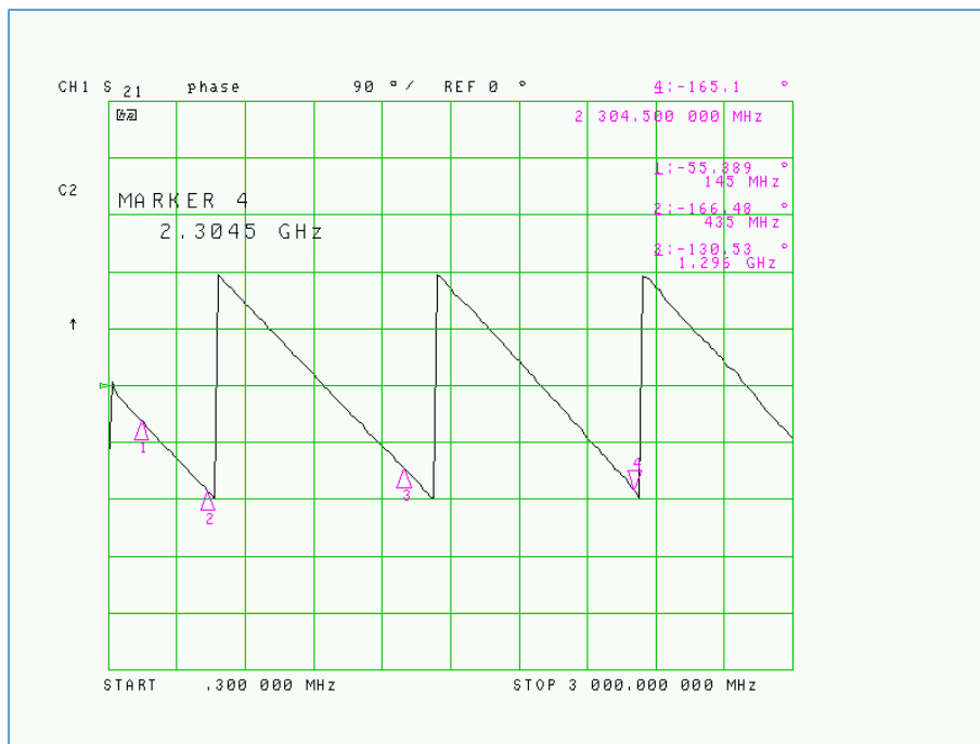
Fig. 172 : Mesure de la phase du préamplificateur sous test. Celle-ci est parfaitement linéaire en fonction de la fréquence, mais c'est la mesure du délai de groupe (voir figure suivante) qui pourra confirmer la linéarité en phase. Cliché ON4IJ.
