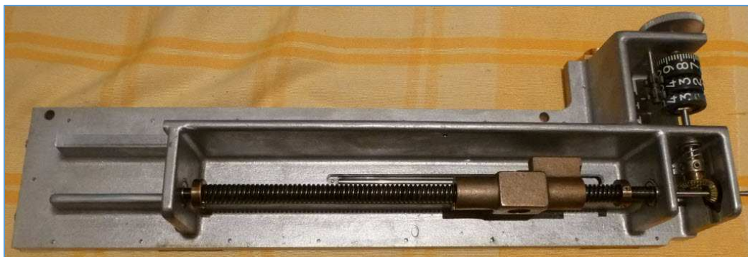
Fig. 42 : Mécanisme de déploiement de la ligne étirable avec une vis sans fin. Photo : ON4IJ.
