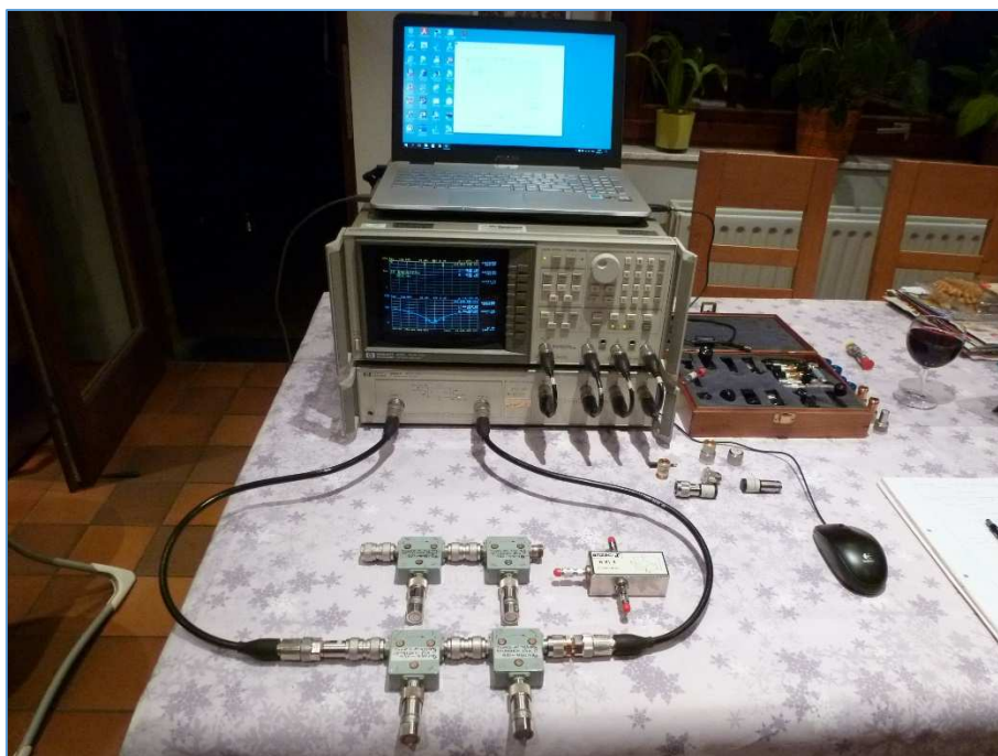
Fig. 117 : Mesures, sur un analyseur de réseau vectoriel, du S_{21} (transmission) et du S_{12} (isolation) de circulateurs montés en double isolateur. Photo : ON4IJ.
