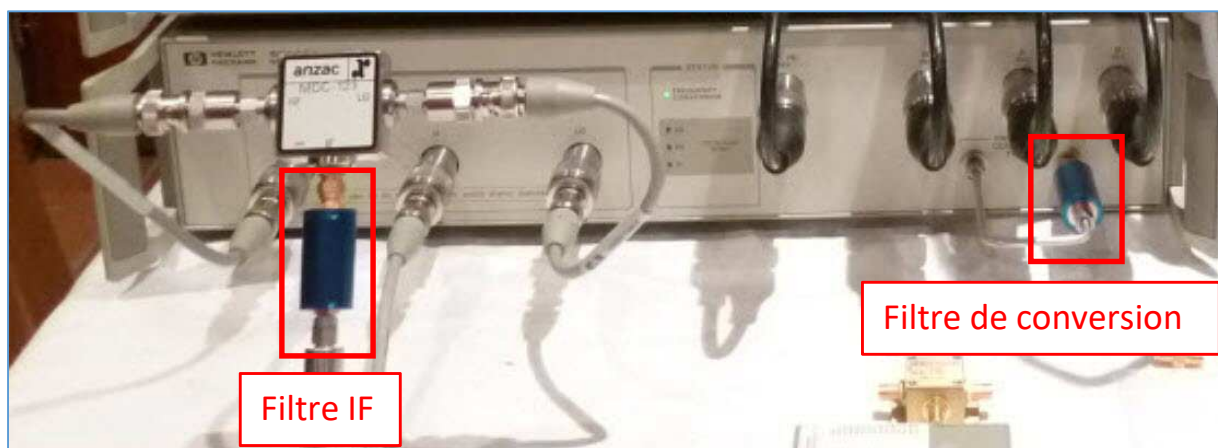
Fig. 221 : Filtre de conversion placé sur le Mixer Test Set et filtre IF raccordé sur le mélangeur sous test. Photo : ON4IJ.
