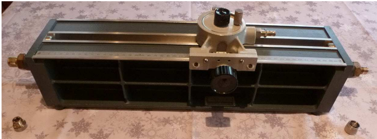
Fig. 3 : Ligne à fente ( Slotted Line ) HP 805A pour la mesure du rapport d'onde stationnaires (VSWR), mesure de magnitude et de phase (catalogue HP de 1950). Le détecteur était raccordé à un voltmètre de mesure à amplificateur faible bruit et gradué en VSWR (HP 415A). Photo : ON4IJ.
