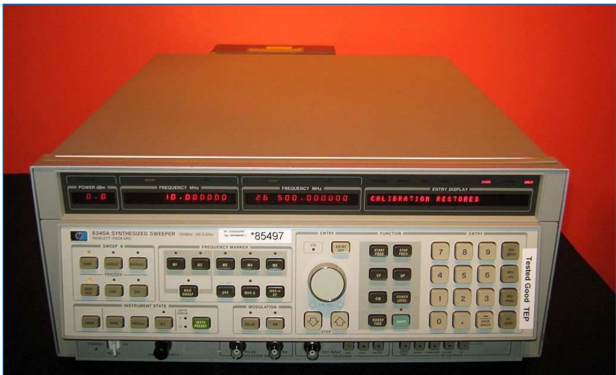
Fig. 25 : Sweeper synthétiseur HP 8340A large bande de 10 MHz à 26,5 GHz. Ce modèle est utilisé pour plusieurs modèles d'analyseurs de réseaux vectoriels. Source : Tech Systems USA.
