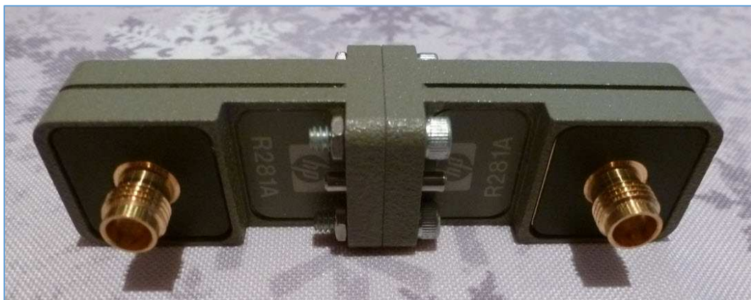
Fig. 150 : Calibrage « Thru » où les deux brides des adaptateurs guide d'onde sont placées bout à bout. La longueur du « Thru » est ici strictement zéro. Photo : ON4IJ.
