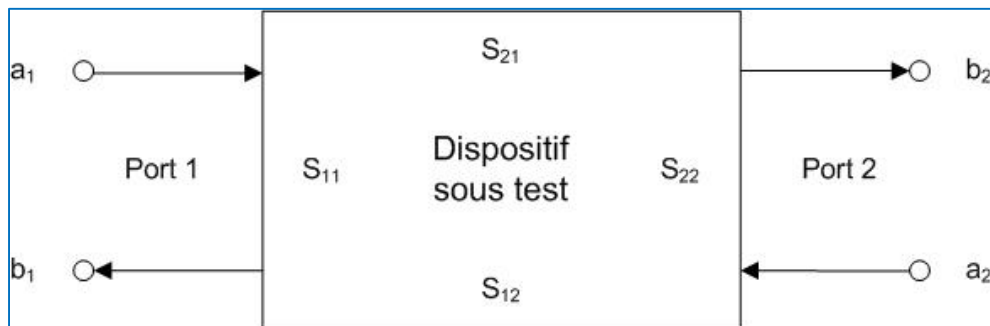
Fig. 15 : Modèle des paramètres S pour un dispositif à deux ports (entrée et sortie). Graphisme ON4IJ.
