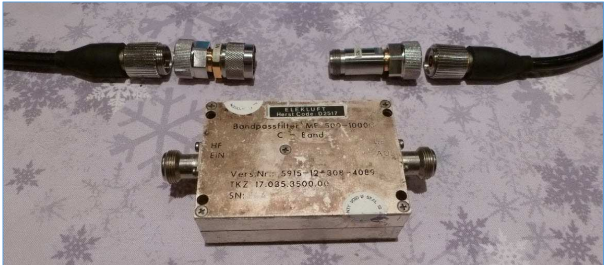
Fig. 158 : Calibrage « SOLT » 3 ème partie S_{21} et S_{12} Thru où l'adaptateur a été changé par un modèle APC7/Type N femelle sur le 2 ème port de mesure. Les deux câbles de mesure peuvent être connectés ensemble. Photo : ON4IJ.
