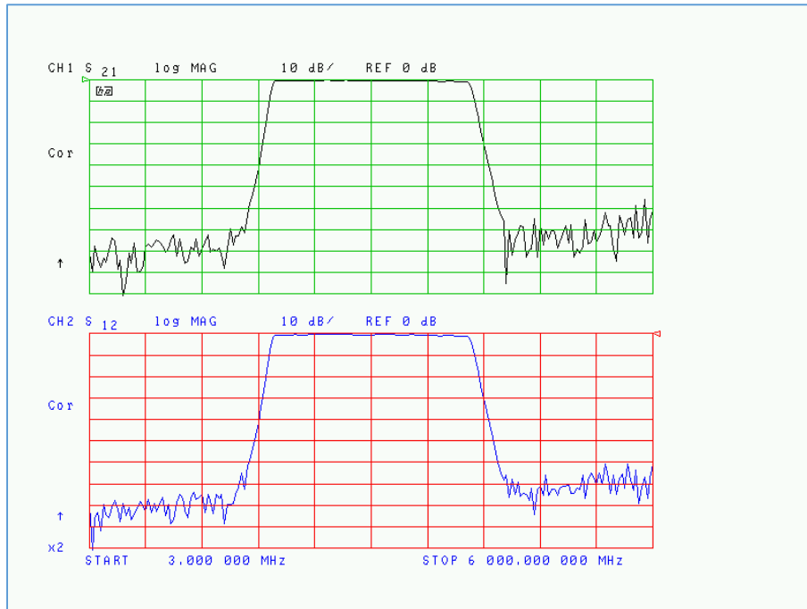
Fig. 98 : Mesures de transmission directe S_{21} et inverse S_{12} d'un filtre passe bande. Les deux courbes se ressemblent comme on pouvait s'y attendre. Cliché ON4IJ.
