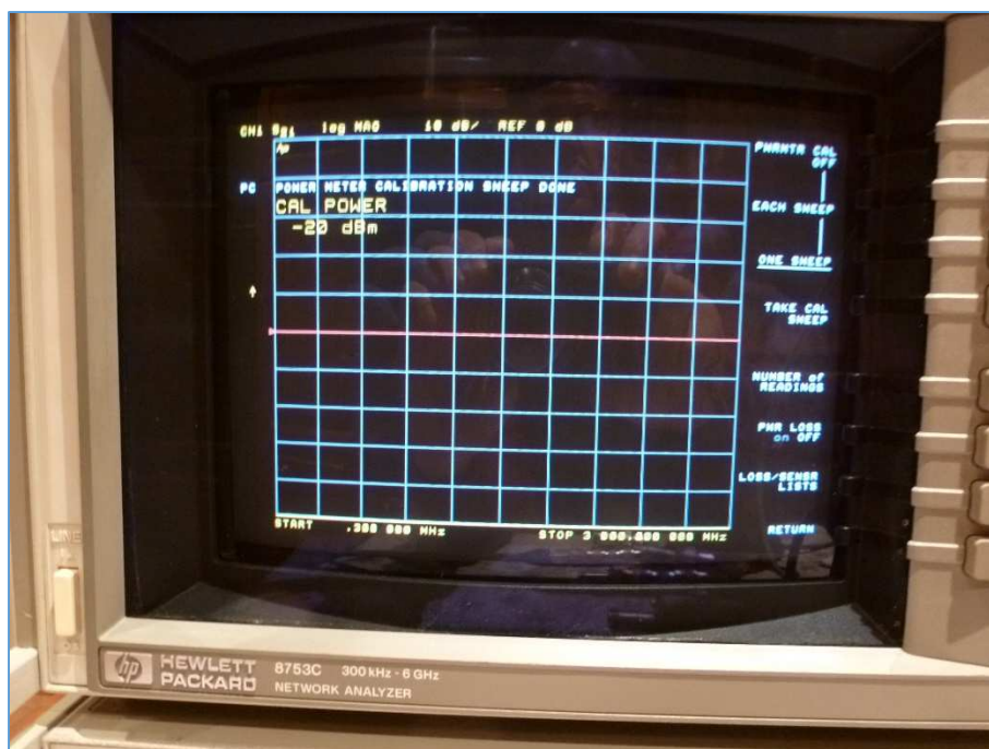
Fig. 189 : Message « POWER METER CALIBRATION SWEEP DONE » lorsque le balayage du calibrage avec Power Meter est accompli. Photo : ON4IJ.
