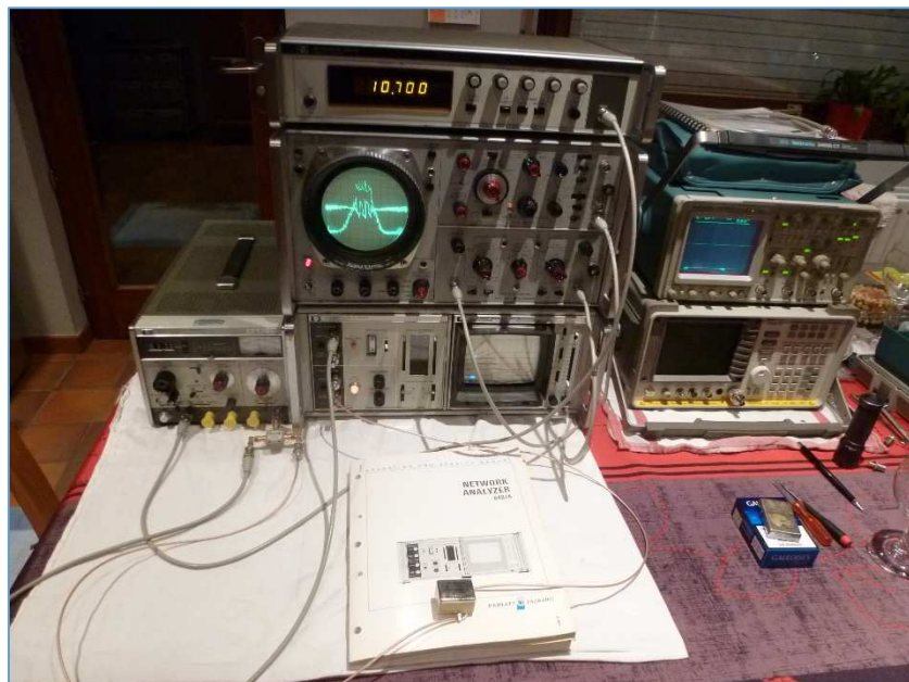
Fig. 56 : Analyseur de réseau vectoriel HP 8407A avec Sweeper HP 8601A et marqueur numérique HP 8600A. Un diviseur de puissance résistif ( Power Splitter ) est raccordé directement à la sortie du Sweeper . Les diagrammes d'amplitude et de phase d'un filtre à quartz de 10,7 MHz sont affichés non seulement sur l'analyseur mais aussi sur un oscilloscope à mémoire phosphorescente HP 141A. Sur la droite, un oscilloscope et un analyseur de spectre ayant servi au calibrage complet de l'analyseur de réseau vectoriel selon la procédure décrite dans le manuel de service. Photo : ON4IJ.
