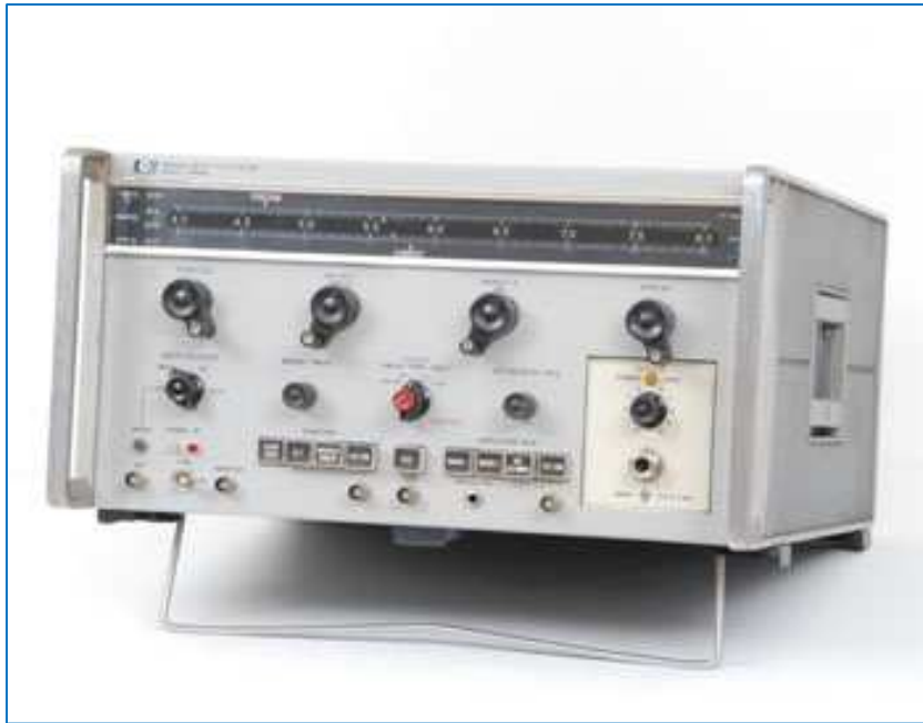
Fig. 22 : Sweeper BWO HP 8690A équipé d'un tiroir HP 8692A de 2 GHz à 4 GHz. Source : HP Memory Project.
