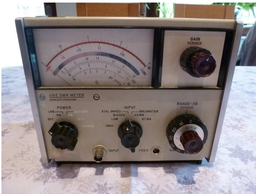
Fig. 4 : Indicateur SWR HP 415E (1967), version moderne du HP 415A de 1950. Cet appareil équipe encore aujourd'hui en 2017 certains laboratoires de mesures. Photo ON4IJ.
