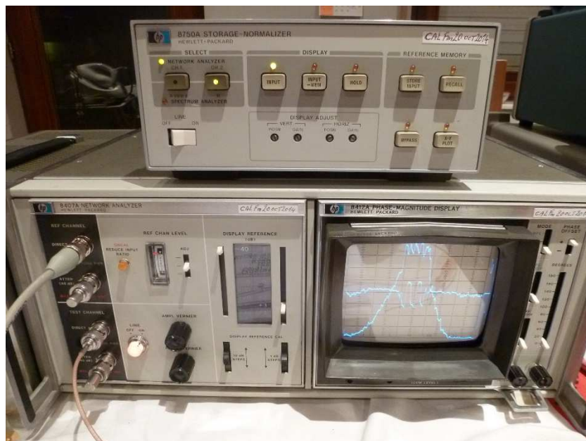
Fig. 57 : Analyseur de réseau vectoriel HP 8407A avec un dispositif de mémorisation de l'affichage par un « Storage Normalizer » HP 8750A. Ceci permet un affichage complet de la trace sans évanouissement de celle-ci à cause de la faible rémanence du tube cathodique. Même dispositif sous test que celui de la figure précédente. Photo : ON4IJ.
