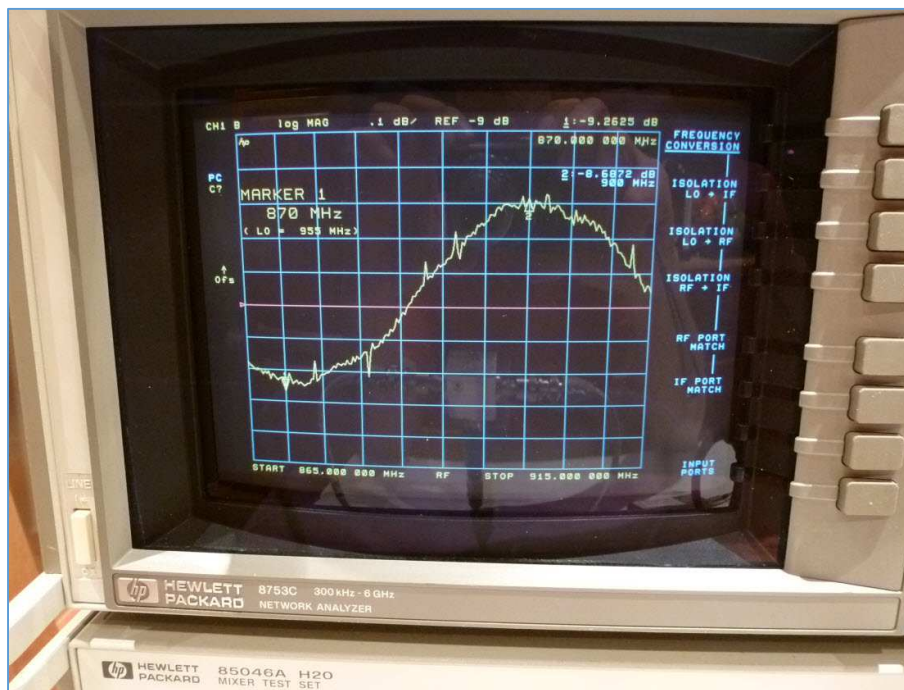
Fig. 224 : Exemple d'affichage de la courbe de réponse des pertes de conversion d'un mélangeur sous test. Photo : ON4IJ.
