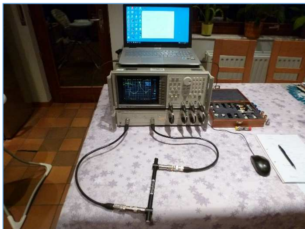
Fig. 104 : Mesures des caractéristiques d'un filtre passe-bas coaxial Type N HP 360A (fréquence de coupure de 700 MHz). Photo : ON4IJ.
