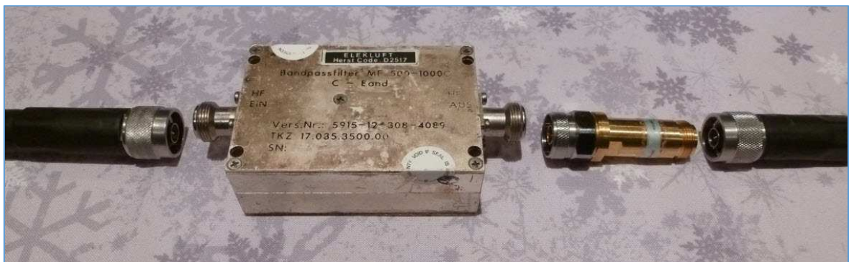
Fig. 163 : Insertion du dispositif sous test où l'adaptateur Type N mâle/Type N femelle a été remplacé sur le 2 ème port de mesure. Photo : ON4IJ.
