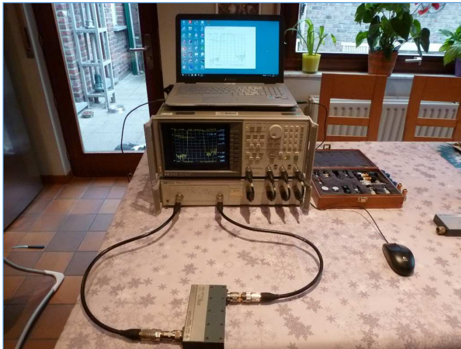
Fig. 79 : Analyseur de réseau vectoriel HP 8753C avec S-Parameter Test Set HP 85047A. L'instrument de mesure vient d'être calibré et on peut dès lors caractériser le dispositif sous test, ici un filtre passe-bande HP 8431A. Photo : ON4IJ.
