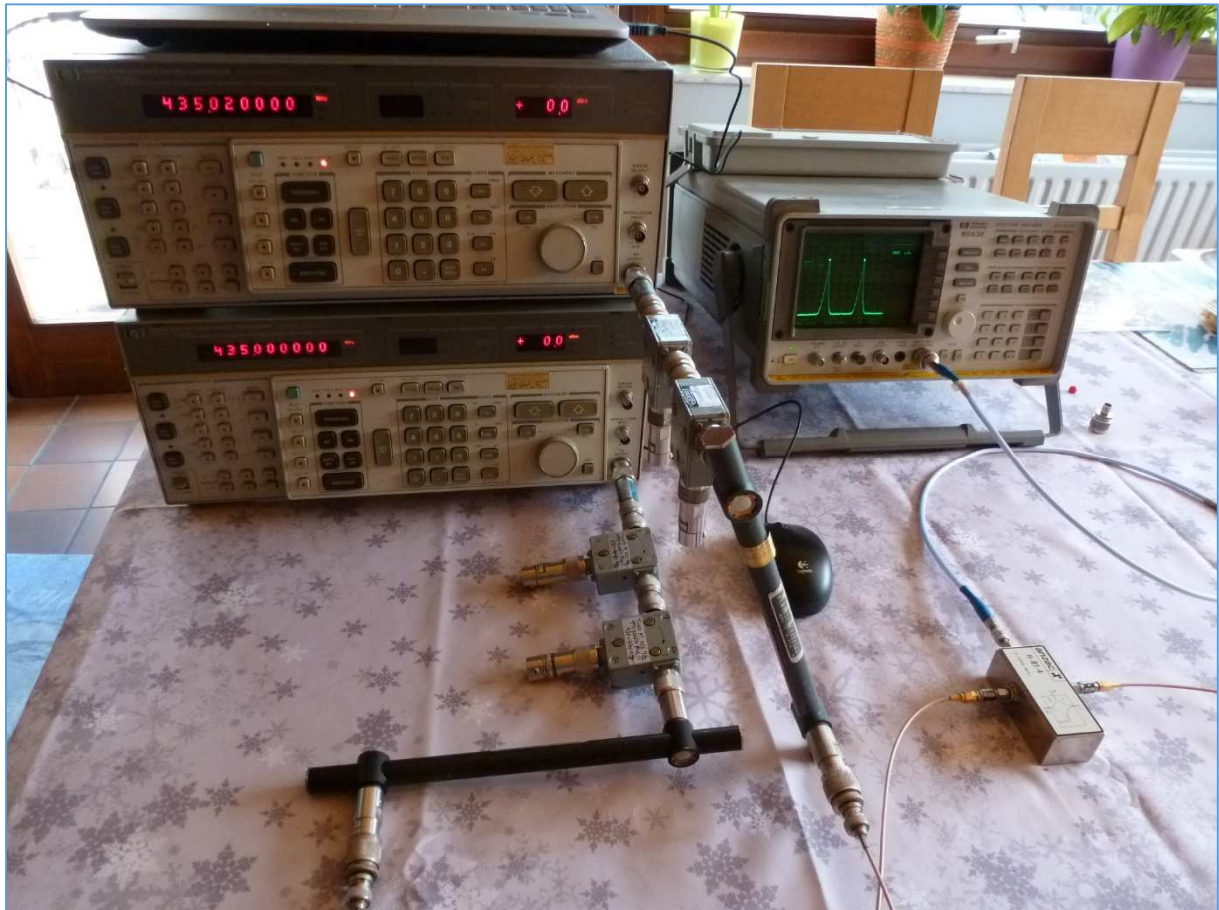
Fig. 124 : Vérification sur un analyseur de spectre (HP 8563E) de l'absence d'intermodulation d'un signal deux tons radiofréquence issu de deux générateurs HF à faible bruit de phase (deux HP 8662A) et combinés avec un « Combining Network ». Les deux signaux des deux générateurs sont combinés selon le schéma-bloc de la figure 119 avec des circulateurs montés en double isolateur, filtres passe-bas (HP 360A), atténuateurs, et avec un coupleur hybride (Anzac H-81-4 ; 5 MHz – 1000 MHz). Photo : ON4IJ.
