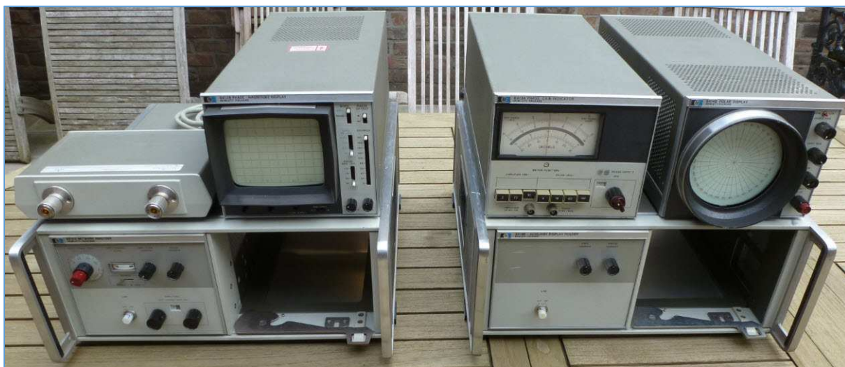
Fig. 32 : À gauche, rack analyseur de réseau vectoriel HP 8410C avec convertisseur HP 8411A (option 18 GHz) et tiroir à tube cathodique rectangulaire pour les mesures d'amplitude et de phase. À droite, rack auxiliaire pour accueillir un tiroir à tube cathodique polaire pour les mesures d'impédances complexes. Juste à côté du tiroir à tube cathodique polaire on peut observer le tiroir à galvanomètre pour la mesure d'amplitude et de phase. Photo : ON4IJ.
