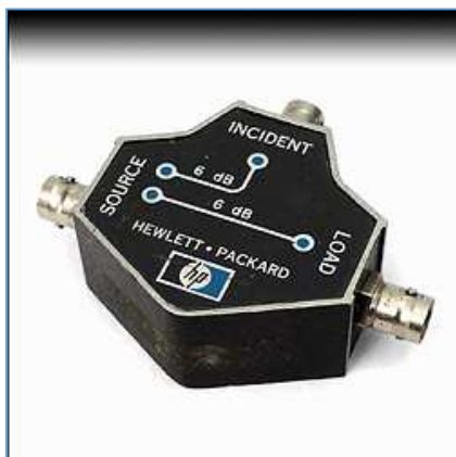
Fig. 59 : Pont directionnel résistif HP 8721A (100 kHz – 110 MHz) prévu pour l'analyseur HP 8409A. Source : Helmut Singer Elektronik, Feldchen, Aachen.
