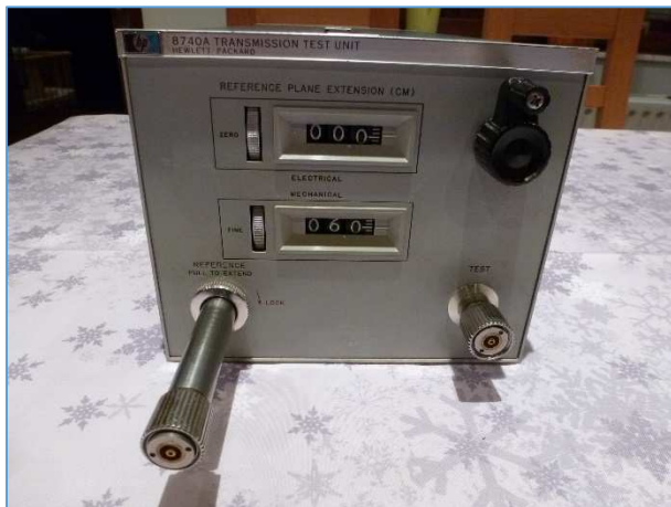
Fig. 36 : Sur cette figure, la ligne mécaniquement extensible est réglée à une longueur de 6 cm. Cette ligne coaxiale est sortie comme un piston. Photo : ON4IJ.
