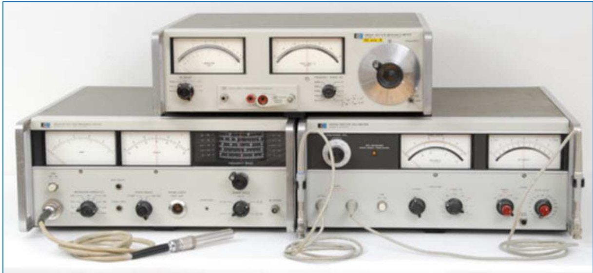
Fig. 11 : Voltmètres vectoriels. Au-dessus : HP 4800A (5 Hz – 500 kHz) ; en bas à gauche : HP 4815A (0,5 – 108 MHz) ; en bas à droite HP 8405A (1 – 1000 MHz). Sensibilité de 100 \mu V et résolution de 0,1°. Source : HP Memory Project.
