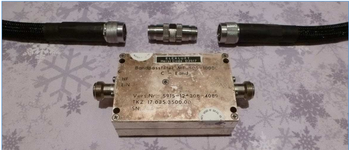
Fig. 162 : Calibrage « SOLT » 3 ème partie S_{21} et S_{12} Thru où l'adaptateur Type N mâle/Type N femelle a été changé par un modèle Type N femelle/Type N femelle de la même longueur d'onde électrique. Les deux câbles de mesure peuvent être connectés ensemble. Photo : ON4IJ.
