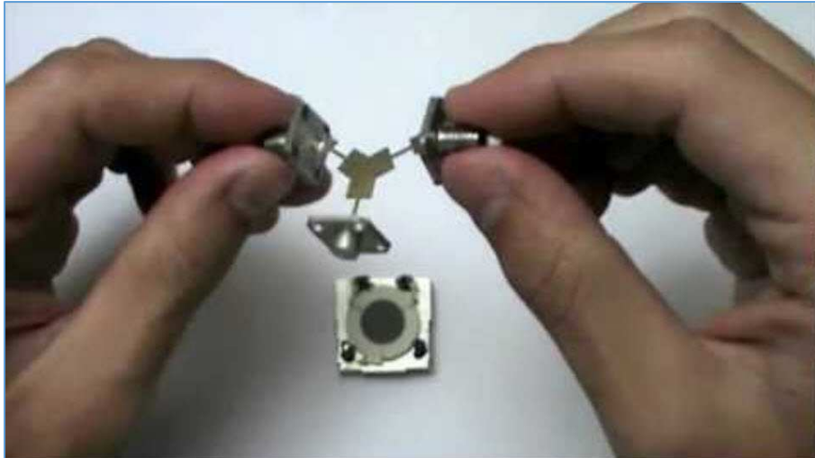
Fig. 110 : Plaque métallique en forme d'étoile (ligne micro-ruban en « Y ») reliant les trois ports d'un circulateur. Source : Youtube, Analog Zeke, 16.09.2012.
