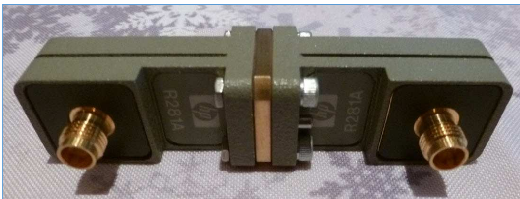
Fig. 152 : Calibrage « Line » ; une entretoise guide d'onde ( Shim ) dont l'épaisseur de 2,9 mm représente une longueur d'onde électrique de \lambda/4 est intercalée entre les deux brides guide d'onde des adaptateurs. Photo : ON4IJ.
