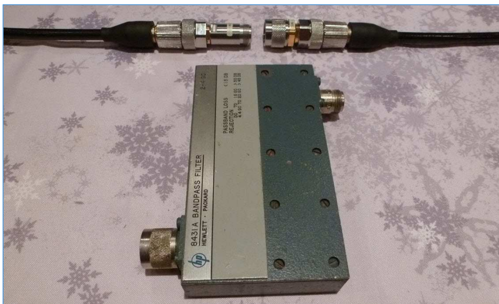
Fig. 78 : Le calibrage « Response » ne nécessite qu'un seul calibre, c'est-à-dire une connexion de traversée ( Through , en abrégé « Thru ») qui permet de raccorder les deux câbles de mesure directement l'un à l'autre. Le calibre « Thru » est ici réduit à sa plus simple expression, c'est-à-dire par l'accouplement des deux parties Type N femelle et Type N mâle des extrémités des câbles de mesure. Photo : ON4IJ.
