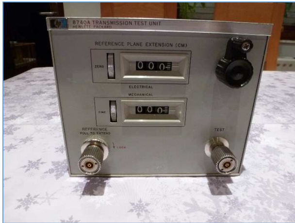
Fig. 35 : Transmission Test Set HP 8740A. En bas à gauche, le connecteur de raccordement vers l'entrée de référence de l'appareil de mesure. En bas à droite, le connecteur de raccordement vers le dispositif sous test. La ligne coaxiale mécaniquement extensible est réglée ici sur une longueur de 0 cm : le connecteur (à gauche) est situé à raz de la face avant du rack. Photo : ON4IJ.
