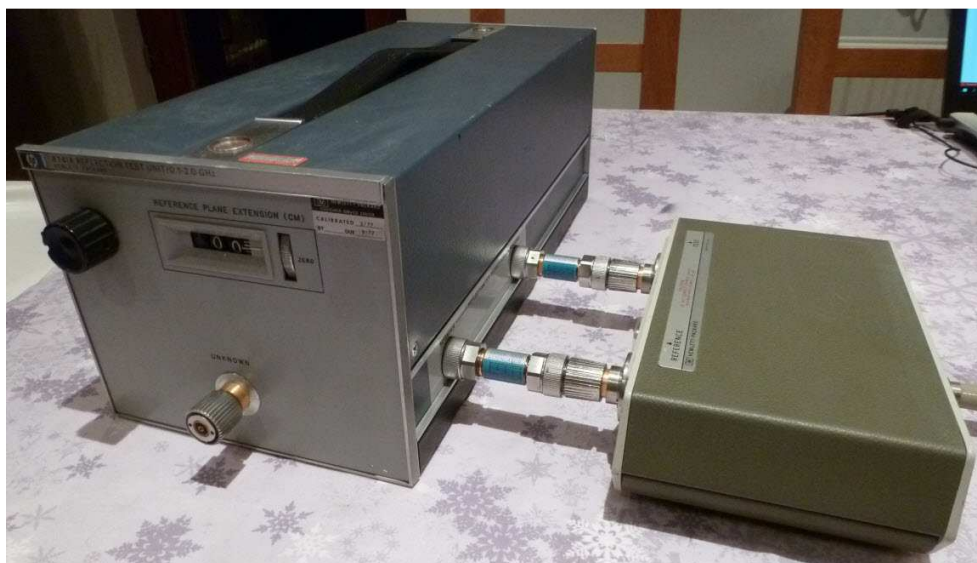
Fig. 48 : Reflection Test Set HP 8741A raccordé à un convertisseur HP 8411A. Photo : ON4IJ.
