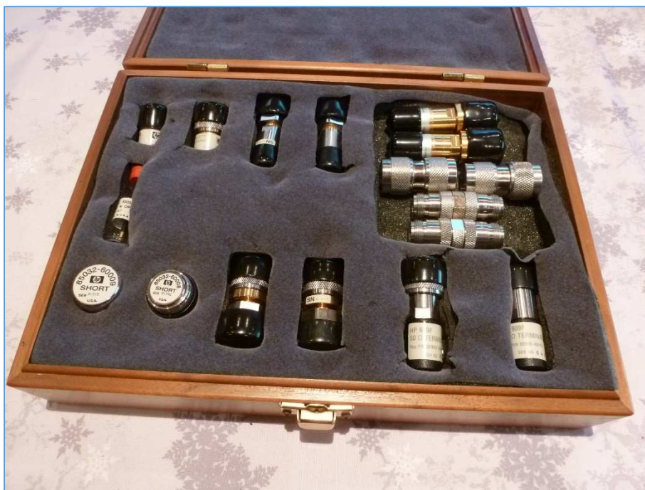
Fig. 74 : Kit de calibrage Type N HP 85032B agrémenté de connecteurs « I » de traversée Type N f-f HP 1250-1472, Type N m-m HP 1250-1475 et Type N m-f HP 85032-60020. Photo : ON4IJ.
