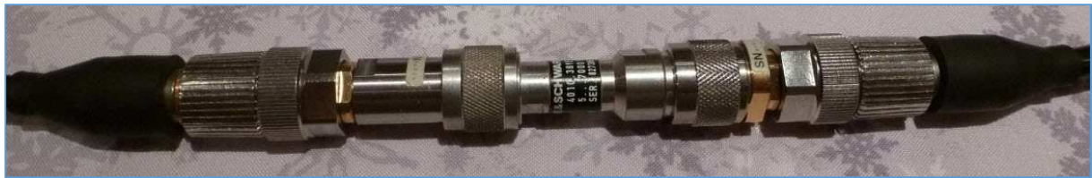
Fig. 102 : Mesure d'un DC-Block Rohde et Schwarz FSE Type N raccordé aux câbles de mesure d'un analyseur de réseau vectoriel. Photo : ON4IJ.
