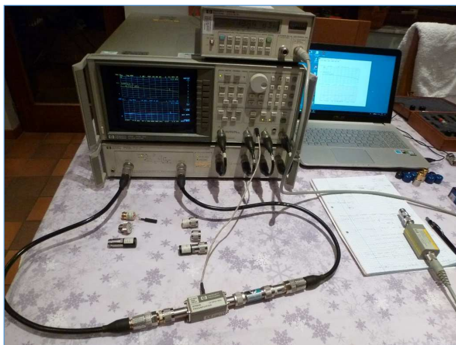
Fig. 190 : Préamplificateur sous test raccordé sur l'analyseur de réseau vectoriel en vue de relever la courbe de compression de 1 dB de gain dans le domaine de la fréquence. Photo : ON4IJ.
