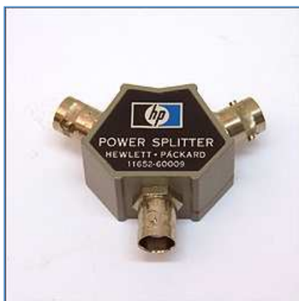
Fig. 58 : Séparateur résistif ( Power Splitter ) HP 11652-60009 (100 kHz – 110 MHz) prévu pour l'analyseur HP 8409A. Source : Helmut Singer Elektronik, Feldchen, Aachen.
