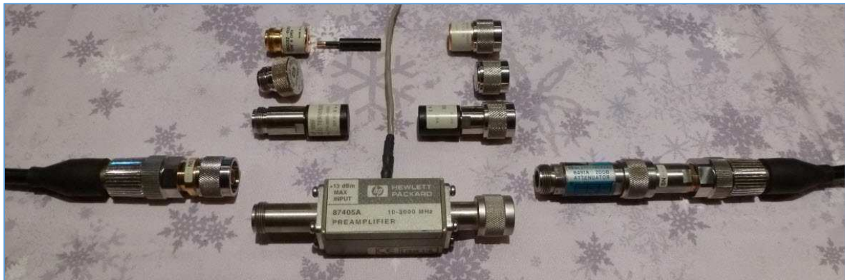
Fig. 169 : Calibrage « SOLT » Full Two-Port avec atténuateur fixe de -20 dB placé sur le câble de mesure raccordé au Port 2 de l'analyseur de réseau vectoriel. Le dispositif sous test est un préamplificateur large bande HP 87405A de +24 dB de gain. Le dispositif est insérable car équipé d'un connecteur Type N femelle à l'entrée et d'un connecteur Type N mâle à la sortie. Le raccordement Thru s'effectue directement entre l'extrémité du premier câble de mesure raccordé au Port 1 de l'analyseur et l'entrée de l'atténuateur. Toutes les non linéarités et les imperfections d'adaptation de l'atténuateur seront corrigées lors des calculs des facteurs de correction lorsque le calibrage sera accompli.
