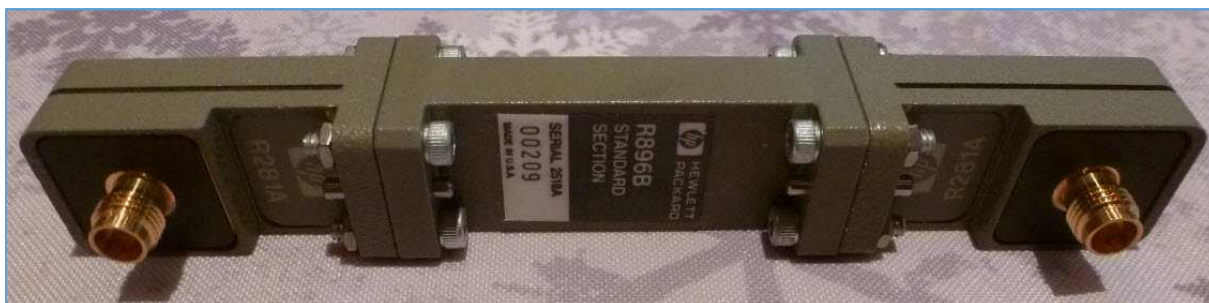
Fig. 153 : Vérification du calibrage « TRL » avec un calibre de segment de guide d'onde de 5 cm de longueur. Photo : ON4IJ.
