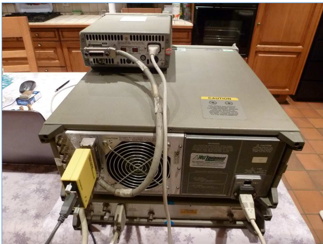
Fig. 187 : Liaison entre appareils de mesure par l'intermédiaire de l'interface GPIB IEEE-488. À l'arrière de l'analyseur de réseau vectoriel, on peut observer un module d'interface GPIB/USB Prologix (boîtier carré de teinte jaune) pour permettre l'acquisition de captures d'écran de l'analyseur. Photo : ON4IJ.
