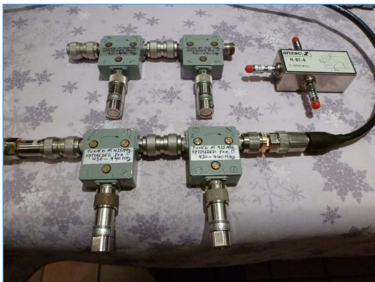
Fig. 116 : Circulateurs en cascade avec charges étalon large bande pour constituer des doubles isolateurs accordés sur la bande UHF des 70 cm. Sur la droite un coupleur hybride qui permettra de combiner deux signaux pour des mesures d'intermodulation du troisième ordre d'un récepteur par stimulation deux tons radiofréquences. Photo : ON4IJ.
