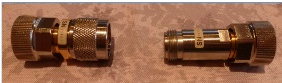
Fig. 44 : Adaptateurs APC7/type N mâle et APC7/type N femelle mis bout à bout pour le calibrage de l'appareil de mesure. Il n'y a donc pas besoin d'ajouter un connecteur en « I » de traversée pour établir la connexion entre la sortie du Transmission Test Set et l'entrée de mesure du convertisseur de l'appareil de mesure. Photo : ON4IJ.
