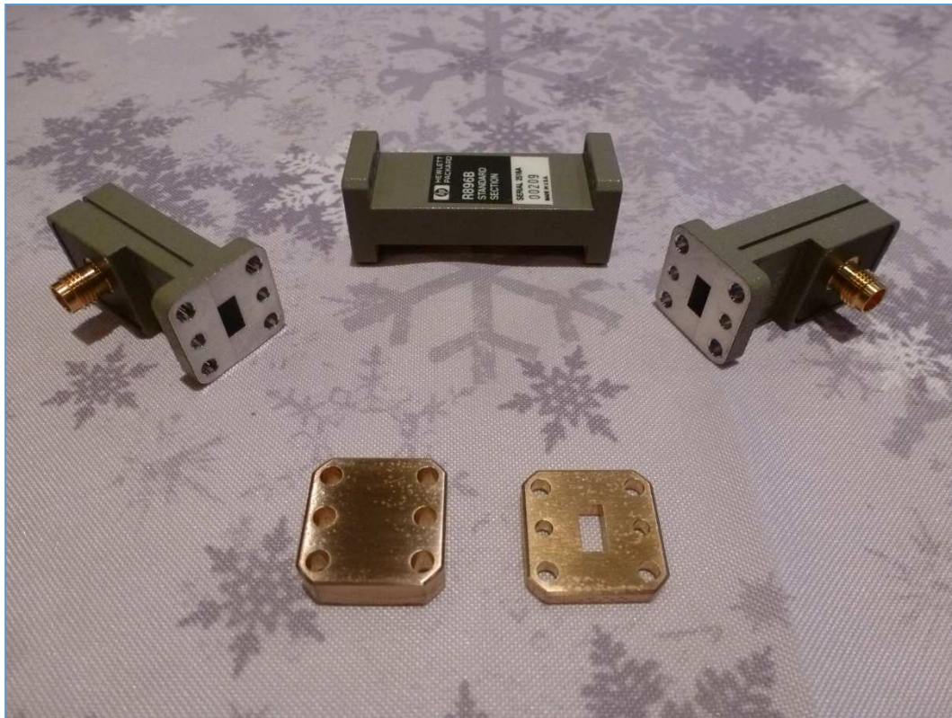
Fig. 149 : À l'arrière-plan de gauche à droite, adaptateur coaxial / guide d'onde, APC 2.4 / WR28 (26,5 GHz – 40 GHz) HP R281A, calibre Line de 5 cm HP R896B, adaptateur HP R281A. À l'avant plan, à gauche : calibre de « court-circuit » WR28, à droite : tranche de guide d'onde WR28 ( Shim ) dont l'épaisseur de 2,99 mm correspond à \lambda/4 pour une fréquence moyenne de la bande Ka. Photo : ON4IJ.
