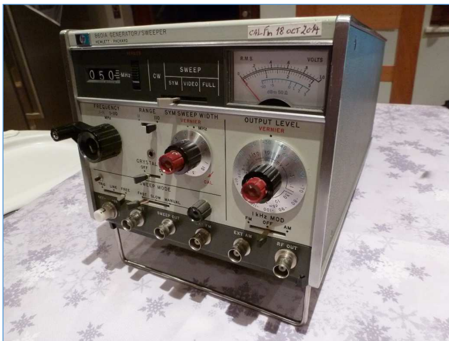
Fig. 23 : Sweeper HP 8601A à synthétiseur de fréquence de 100 kHz à 110 MHz particulièrement adapté à l'analyseur de réseau vectoriel HP 8407A. Photo : ON4IJ.
