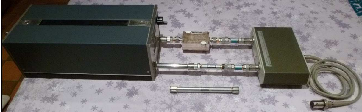
Fig. 38 : Raccordement d'un dispositif sous test (ici un filtre passe-bande) pour une mesure du coefficient de transmission au moyen d'un Transmission Test Set HP 8740A. L'entrée du filtre à mesurer est raccordée à la sortie « Test » du Transmission Test Set ; la sortie du filtre est raccordée à l'entrée de mesure « Test » du convertisseur de fréquences HP 8411A de l'appareil de mesure. La ligne coaxiale extensible mécaniquement est ajustée à une longueur permettant de raccorder celle-ci à l'entrée de référence du convertisseur. Un segment de ligne coaxiale à air d'une longueur de 10 cm a été ajouté pour prolonger la ligne extensible de façon à atteindre le connecteur d'entrée de référence du convertisseur. À l'avant plan de la photo, on peut observer un autre segment de ligne coaxiale à air d'une longueur de 20 cm. Ce segment plus long est nécessaire lorsque les dimensions physiques du dispositif sous test sont plus importantes (distance plus grande entre le connecteur d'entrée et celui de sortie du dispositif sous test). Un atténuateur de 30 dB est placé juste à l'entrée de référence du convertisseur et un atténuateur de 10 dB est placé juste à l'entrée de mesure de celui-ci. Photo : ON4IJ.
