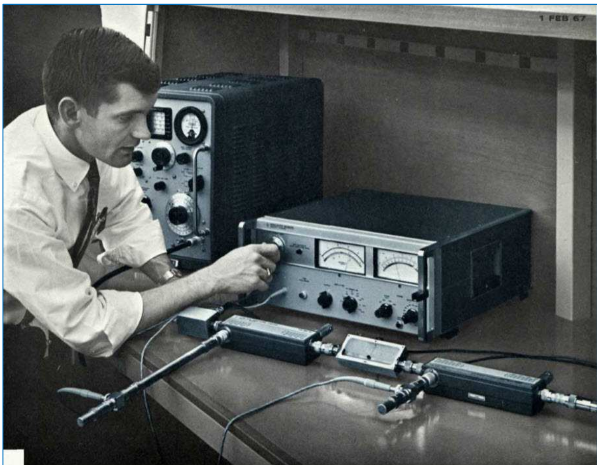
Fig. 13 : Mesures des paramètres S d'un dispositif actif à transistor sous test au moyen d'un générateur HP 608C, d'un voltmètre vectoriel HP 8405A, de deux coupleurs directionnels doubles et de charges étalons dont une est à ligne coulissante ( Sliding Load ). Source : HP note d'application AN77-1 (1967).
