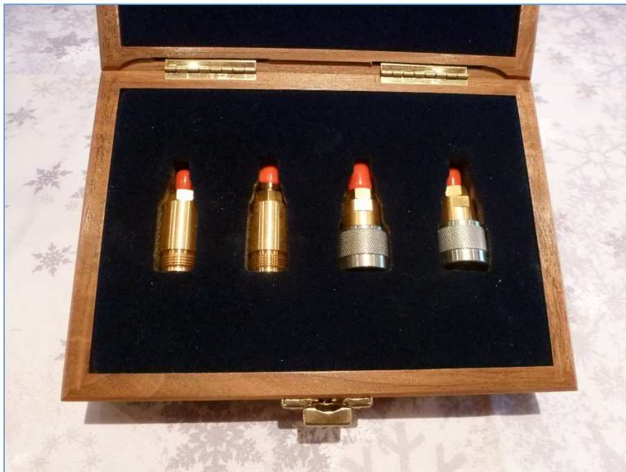
Fig. 73 : « Adapter Kit » Type N-APC3.5 HP 11878A regroupant les quatre associations de genre des connecteurs (f-f, f-m, m-f et m-m). Photo : ON4IJ.
