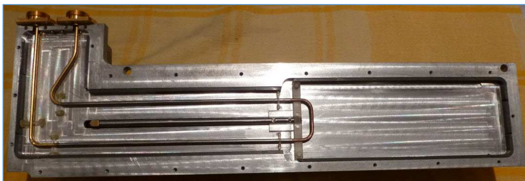
Fig. 41 : Idem figure précédente avec la ligne coaxiale complètement rétractée. Photo : ON4IJ.
