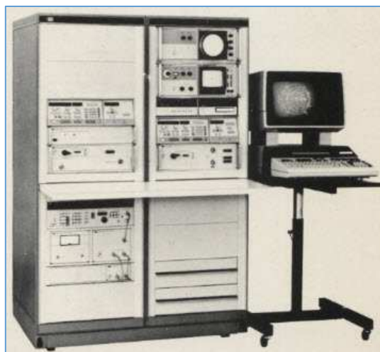
Fig. 30 : Ensemble HP 8409C : analyseur de réseau vectoriel HP 8410C en station semi-automatique. On observera sur la droite de la figure un ordinateur HP 9845 pilotant les automatismes de mesure. Une installation de légende ! Source : HP 8409C Operating Manual.
