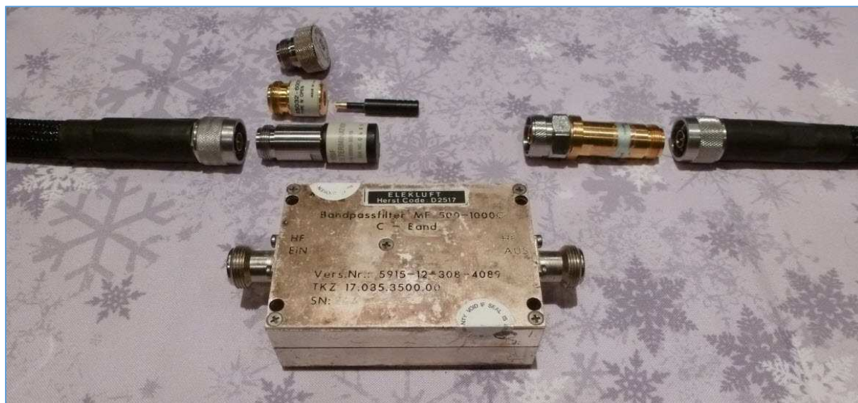
Fig. 160 : Calibrage « SOLT » 1 ère partie S_{11} Short-Open-Load directement sur le connecteur Type N mâle sur le 1 er port de mesure. Le dispositif sous test est non insérable avec deux connecteurs Type N femelles. Photo : ON4IJ.
