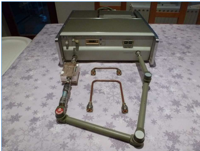
Fig. 50 : Transmission/Reflection Test Set HP 8743B Opt. 018 avec bras coaxial articulé HP 11605A. À l'avant plan, on peut observer deux lignes coaxiales sous forme de cavalier de longueurs différentes qui se raccordent à l'arrière du rack ; il s'agit d'extensions de la ligne « étirable » ( Line Stretcher ). Photo : ON4IJ.
