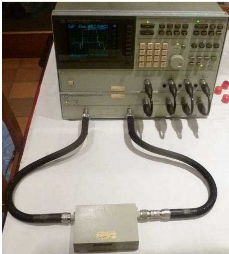
Fig. 67 : Analyseur de réseau vectoriel HP 3577A, S-Parameter Test Set HP 35677A. Un écran LCD couleur substitue le moniteur à tube cathodique monochrome d'origine. À l'avant-plan, un filtre passe-bande sous test. Photo : ON4IJ.
