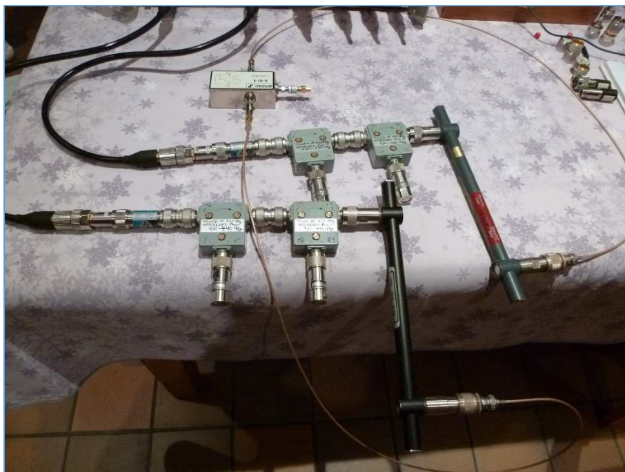
Fig. 121 : « Combining Network » raccordé sur un analyseur de réseau vectoriel. Les ports de mesure sont raccordés sur les deux entrées du dispositif sous test ; une charge est placée à la sortie.
