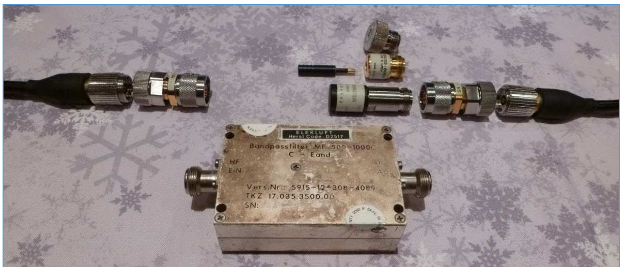
Fig. 157 : Calibrage « SOLT » 2 ème partie S_{22} Short-Open-Load avec adaptateur APC7/Type N mâle sur le 2 ème port de mesure. Photo : ON4IJ.
