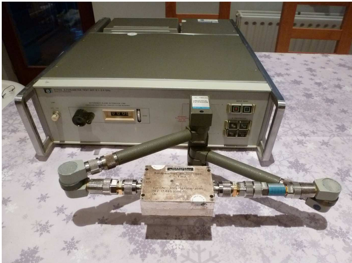
Fig. 53 : S-Parameter Test Set HP 8745A avec extension coaxiale articulée HP 11604A. Photo : ON4IJ.
