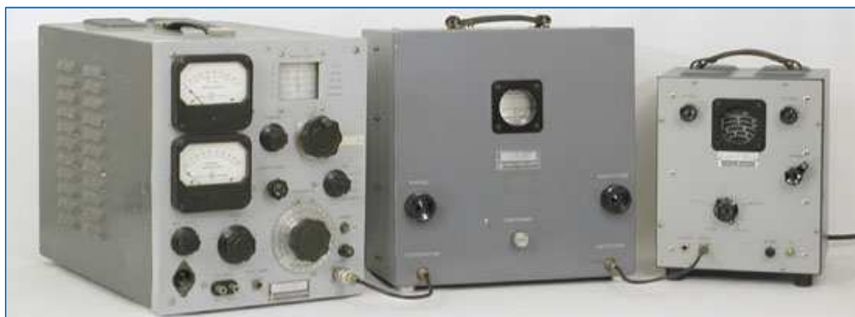
Fig. 1 : Système de mesure directe de l'impédance complexe avec lecture du module et de l'argument avec un générateur HP 608A, un pont de mesure HP 803A et un récepteur de mesure avec détecteur HP 417A. Source : (HP Journal Avril 1950) HP Memory Project.
