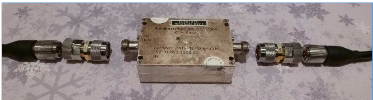
Fig. 159 : Insertion du dispositif sous test où l'adaptateur APC7/Type N mâle a été remplacé sur le 2 ème port de mesure. Photo : ON4IJ.
