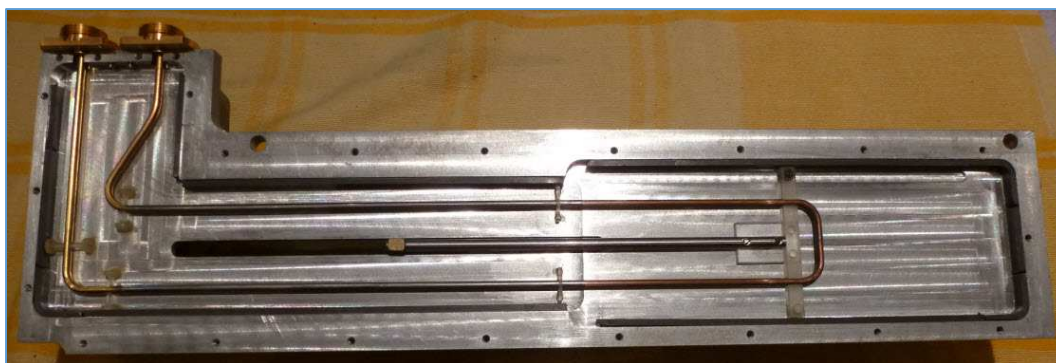
Fig. 39 : Ligne coaxiale étirable, Line Stretcher (ici d'un Reflection Test Set HP 8741A et dont la construction est similaire à celle d'un Transmission Test Set HP 8740A). La ligne étirable est ici, sur cette figure, à moitié déployée. Le fonctionnement de ce mécanisme est comparable à celui de l'instrument de musique trombone à coulisse (voir la partie située à droite). Photo : ON4IJ.
