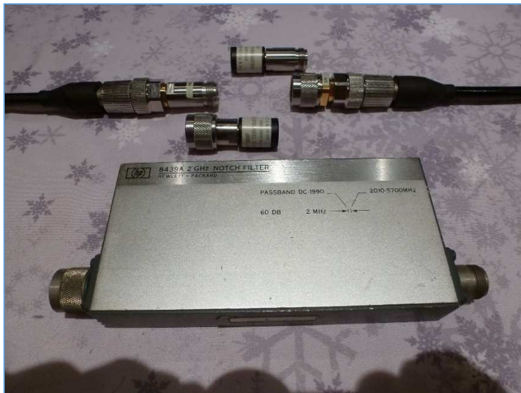
Fig. 82 : Un dispositif sous test composé d'un filtre éliminateur de bande nécessite un calibrage « Response and Isolation ». Pour effectuer ce calibrage, il faut disposer de deux calibres, un calibre de connexion de traversée ( Thru ) et un calibre de charge étalon ( Load ). Photo ON4IJ.
