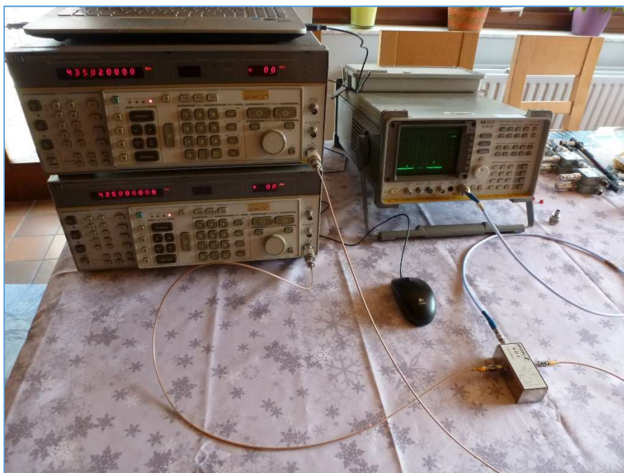
Fig. 128 : Raccordement de deux générateurs HF au moyen d'un coupleur hybride sans double isolateur en amont des entrées de celui-ci. Photo : ON4IJ.
