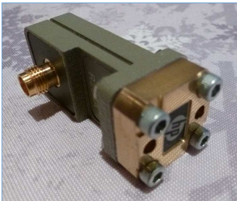
Fig. 151 : Calibrage « Reflect » au moyen d'un « court-circuit » formé d'un obturateur plan et massif venant coiffer la bride de l'adaptateur coax/guide d'onde. Ce calibre est placé sur chacun des deux ports de mesure pour réaliser le calibrage des deux ports de mesure de l'analyseur. Photo ON4IJ.
