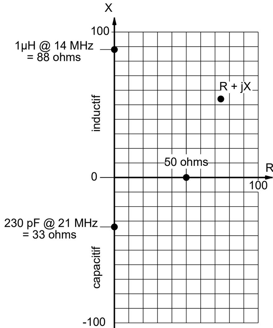
On « **normalise** » le diagramme en divisant toutes les coordonnées par 50 ... si on est dans un système à 50 ohms ↓
