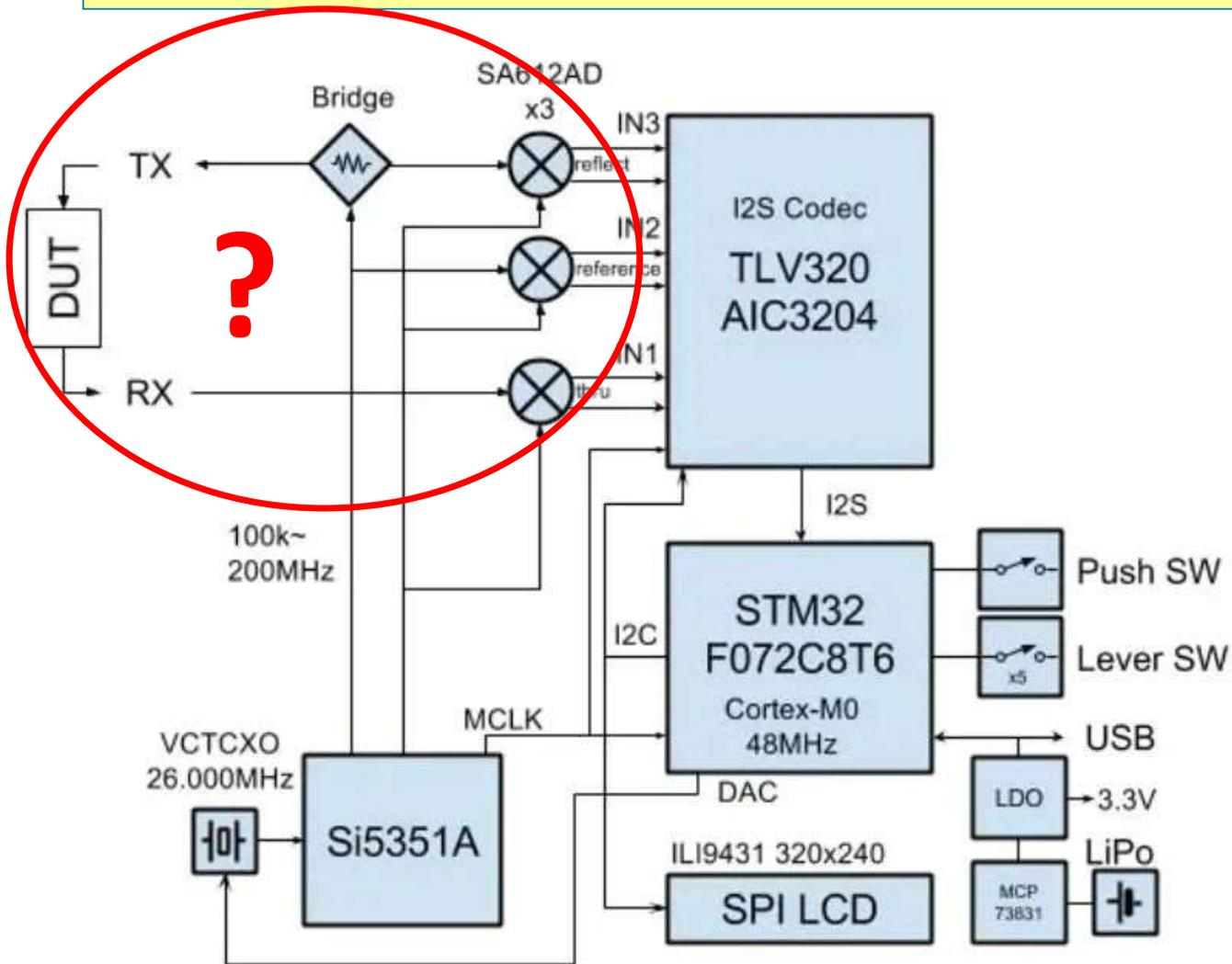
SA612AD : mélangeur double équilibré avec oscillateur intégré
