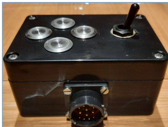
Fig. 13 : Boitier interface utilisateur, vue arrière. Photo : ON4IJ.
