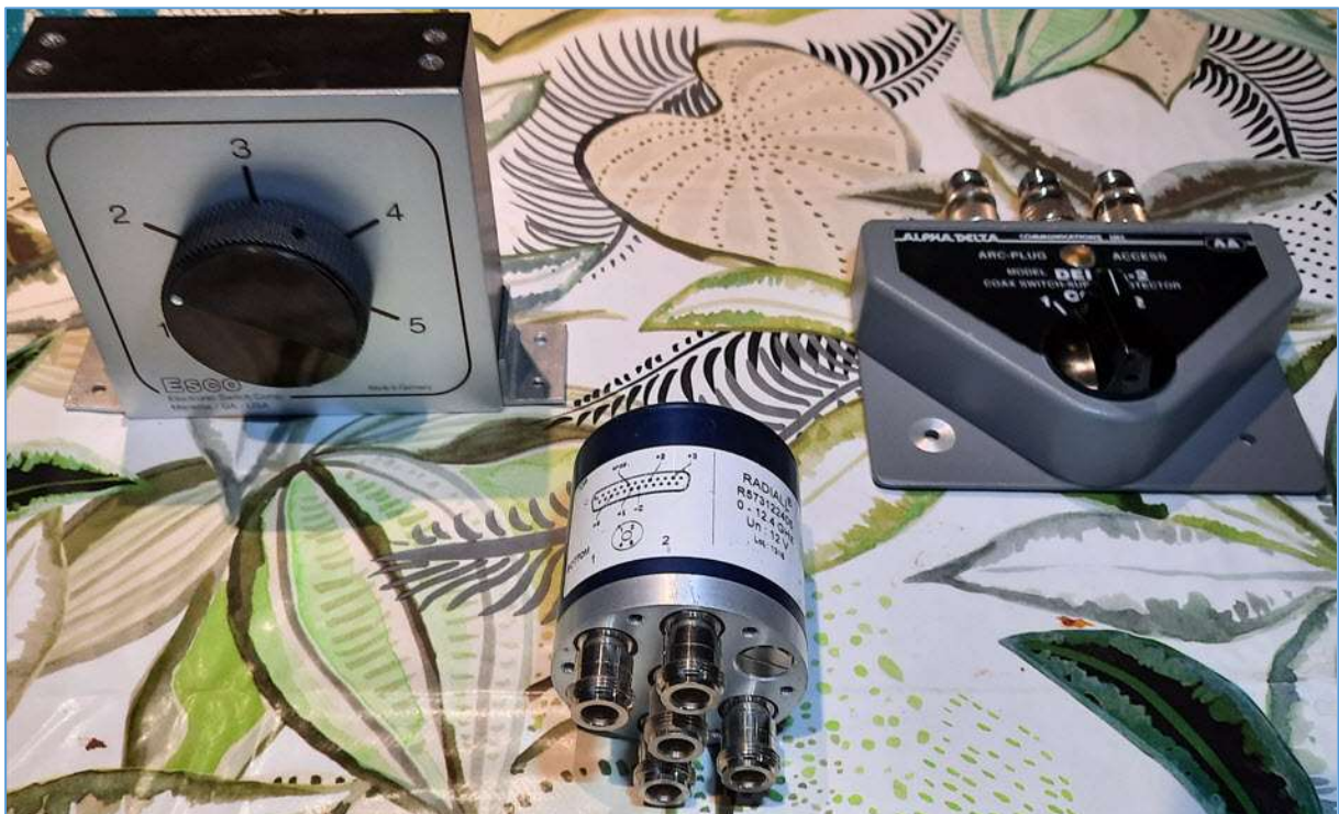
Fig. 1 : (À gauche) exemple d'un commutateur coaxial manuels à plusieurs voies ; (à droite) exemple d'un commutateur coaxial manuel à deux voies avec position de repos ; (au milieu à l'avant plan) exemple d'un relais coaxial SP4T. Photo : ON4IJ.
