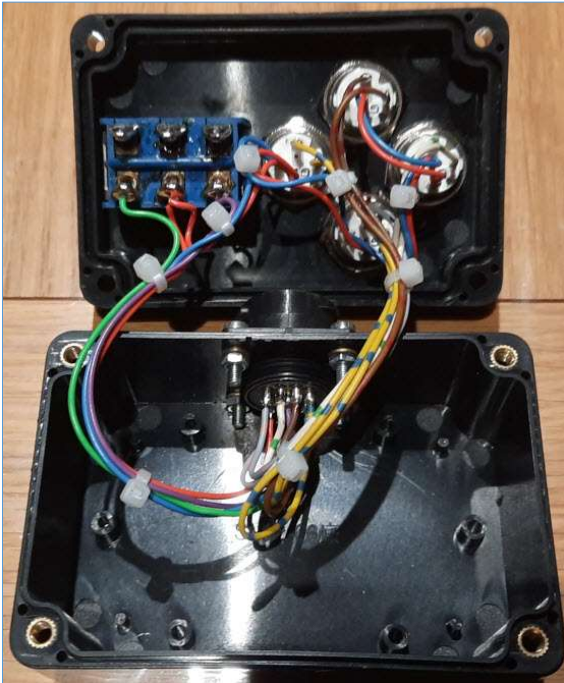
Fig. 18 : Câblage du boîtier interface utilisateur. Photo : ON4IJ.
