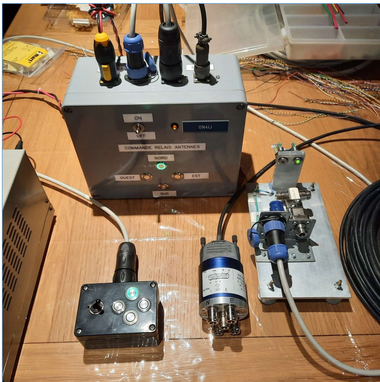
Fig. 20 : Vue d'ensemble du système de commutation d'antennes au complet avec le boîtier de commande, le boîtier d'interface utilisateur, le relais coax SP4T et la platine avec le relais coax à deux voies SPDT. Photo : ON4IJ.
