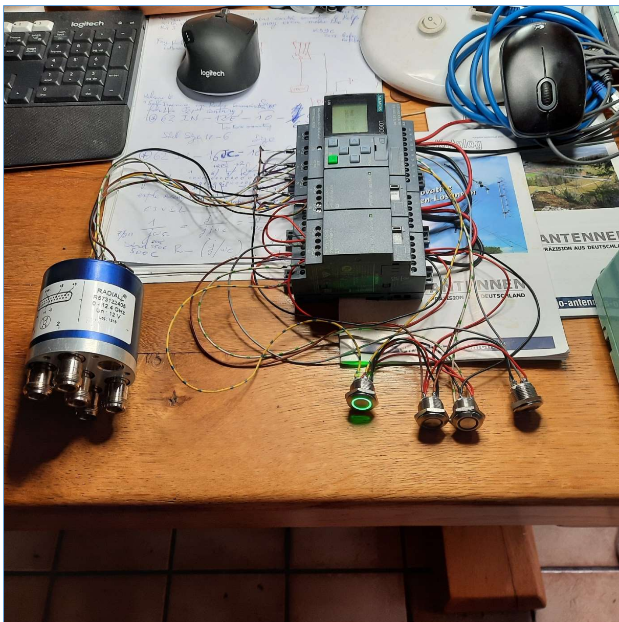
Fig. 23 : Banc de test ayant servi lors de l'élaboration du programme de l'unité logique. Photo : ON4IJ.
