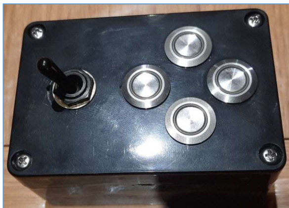
Fig. 12 : Boitier interface utilisateur, vue du dessus. Photo : ON4IJ.
