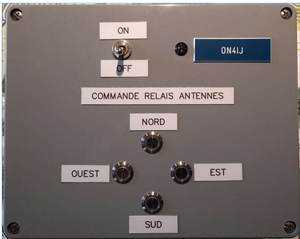
Fig. 10 : Boîtier de commande pour les relais coax d'antennes avec l'unité logique Siemens Logo!. Vue de la face supérieure avec organes de commande. Photo : ON4IJ.
