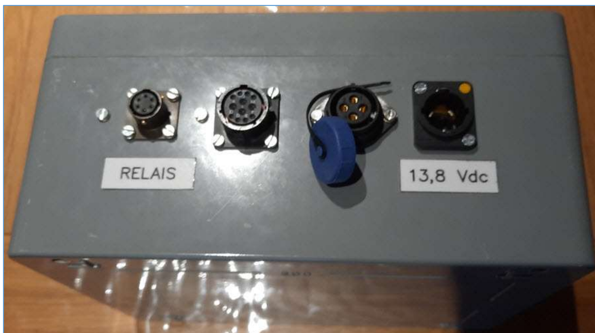
Fig. 11 : Boitier de commande pour les relais coax d'antennes avec l'unité logique Siemens Logo!. Vue du flanc du boitier avec les connecteurs de raccordement. Photo : ON4IJ.
