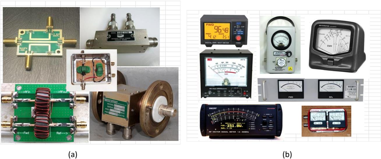
Fig. 3 : Différents types de coupleur directionnel (a) - Affichage de la puissance et VSWR (b). Source : divers
