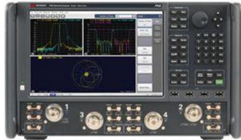
Fig. 31 : Directivité du VNA KEYSIGHT (HP) modèle PNA- X – directivité garantie (après calibration) 48 dB. Source : Keysight
